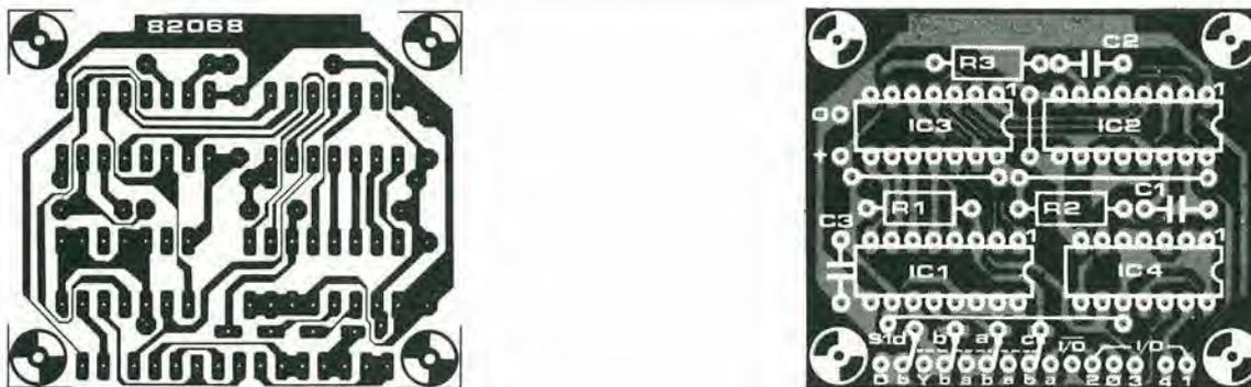
Fig. 8 - Le piste di rame e la disposizione dei componenti per il circuito di figura 1.
