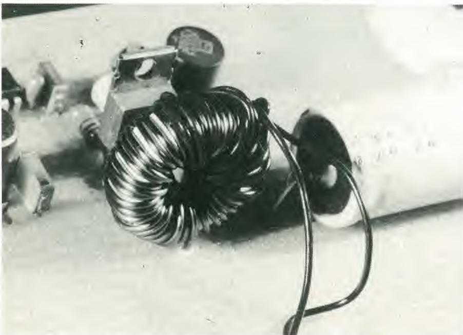
Fotografia: Questa foto ingrandita mostra le dimensioni relative della bobina di accoppiamento del sistema cercapersone.
