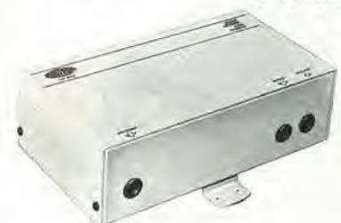
Questo ricevitore in unione al trasmettitore UK 943 forma un dispositivo di comando a distanza applicabile a cancelli, porte, saracinesche, ecc.
