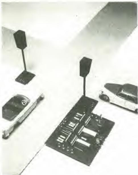
La destinazione classica di un microcomputer è di svolgere, mediante un programma, funzioni di controllo che altrimenti richiederebbero una notevole quantità di hardware. I computer sono impiegati già da un pò di tempo nel pilotaggio dei "veri" semafori: ecco ora un'opportunità di utilizzare il Junior Computer per la medesima applicazione miniaturizzata.
