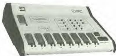
Le altre caratteristiche sono un riferimento interno di precisione, 6 range di tensione di ingresso unipolare e bipolare pin programmabili, e uscita dei dati sia parallela che seriale.
