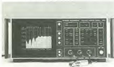
I due canali di misura possono essere visualizzati sia sotto forma di linea che di istogramma; i dati d'ingresso come la frequenza, la dinamica di ampiezza, il riferimento, il livello relativo, i limiti superiori e inferiori sono suggeriti e visualizzati sul CRT.
