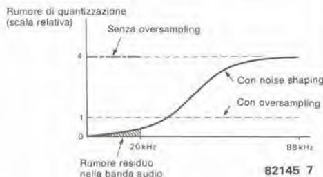
retroazione dell'errore di arrotondamento, conosciuta alla Philips con il nome di "noise shaping" (modificatore della curva di rumore), garantisce ulteriori 7 dB di riduzione del rumore nello spettro audio, che va da 0 a 20 kHz. Insieme ai 6 dB, ottenuti grazie all'oversampling, avremo a disposizione un guadagno dinamico non inferiore a 13 dB. Presumendo che il convertitore a 14 bit TDA 1540 (senza oversampling e noise shaping) abbia una cifra di rumore di 84 dB, l'intero sistema
