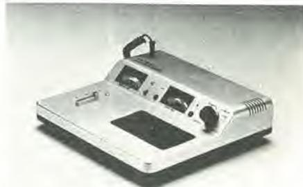
Un registratore di risonanza controlla la frequenza del risonatore al quarzo mediante un sistema ad ultrasuoni e fa una verifica di precisione da assoluto a  $\pm 10$  secondi al giorno. Verifica anche la stabilità del motore passo-passo del movimento identificandone il tono.
