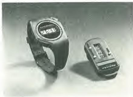
Il cardiotachimetro permette di misurare la frequenza del polso mediante sensori a raggi infrarossi che riflettono il flusso sanguigno all'interno delle vene di chi lo indossa. La misura offre un grado di precisione di circa  $\pm 1,25\%$ .
