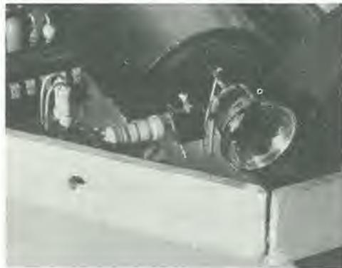
Foto: Prototipo del telemetro. Da destra a sinistra è possibile osservare: il trasmettitore a LED con il suo riflettore, il fotodiolo per il ricevitore e parte dei relativi circuiti elettronici.
