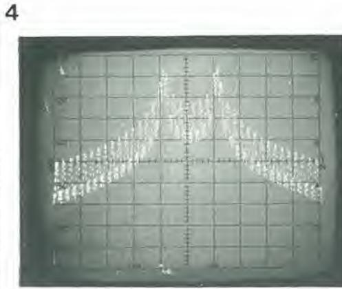
Figura 5. Spettro di frequenza di una portante modulata in frequenza da un'onda quadra di 50 Hz, con una deviazione di 50 Hz.
