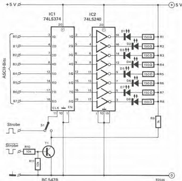
segnali presenti sulle linee dei dati vengono memorizzati dai bistabili e le uscite risultanti vengono applicate ad IC2, che contiene otto stadi di pilotaggio invertenti. Se una delle uscite del bistabile è a livello logico "1", l'uscita del corrispondente pilota è "0" e perciò il corrispondente LED si accende. Se l'ingresso ad uno degli stadi pilota è
