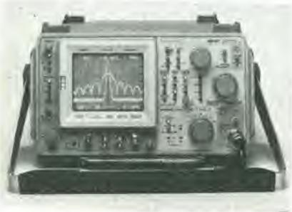
Questi analizzatori sono in grado di effettuare misure di frequenza con la precisione tipica di un contatore digitale.
