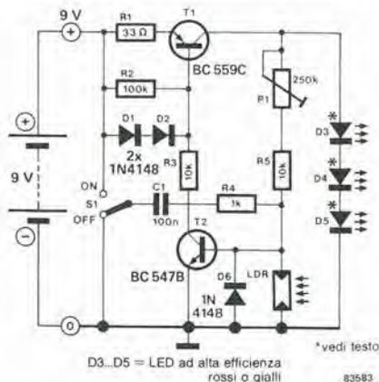
(sostituendo R1 con una resistenza di valore diverso). Con i valori stabiliti, passano attraverso i LED circa 20 mA e, poiché il consumo di corrente con i LED spenti è solo di alcuni nA, la batteria da 9 V dovrebbe durare parecchio tempo. E' infine importante ricordare che alcuni tipi di carta fotografica sono sensibili a tutti i colori, compresi il rosso ed il giallo, per cui è bene controllare questo particolare prima di usare la torcia.
