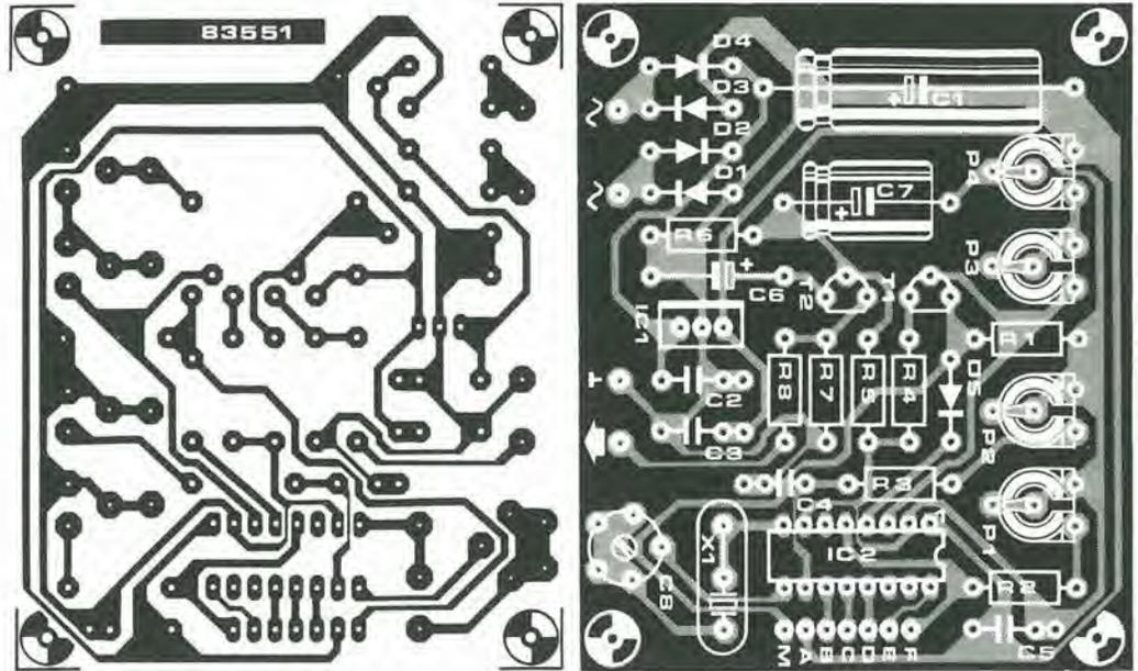
viene predisposto mediante P4. Il segnale di uscita di questo trimmer viene ancora amplificato da T2, cosicché con un carico di circa 75 Ω sarà possibile ottenere un segnale con ampiezza di 1 V<sub>pp</sub>. La corrente assorbita dal circuito completo è di circa 150 mA. Il semplice alimentatore stabilizzato, formato da IC1 e dai relativi componenti, può facilmente
