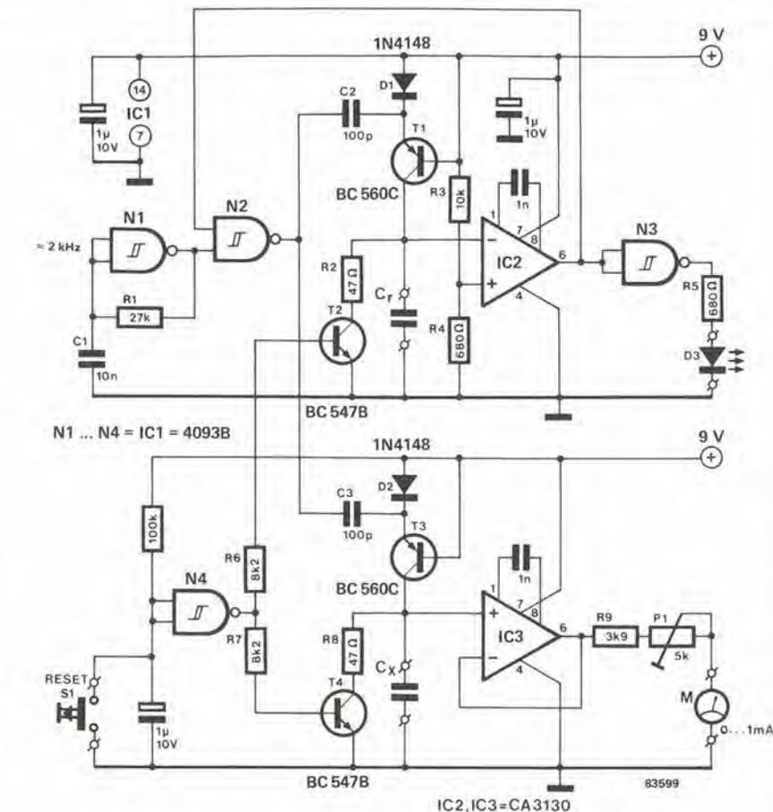
cariche di  $C_r$  e  $C_x$  sono ora uguali e lo strumento indica di quanto la tensione ai capi di  $C_x$  differisce da quella ai capi di  $C_r$ . Il buffer  $IC_3$  presenta a  $C_x$  un'impedenza di carico molto elevata. Premendo il pulsante di reset  $S_1$ ,  $T_2$  e  $T_4$  scaricano rispettivamente  $C_r$  e  $C_x$ , dopo di che il processo di carica riprende ed il circuito è pronto per la successiva misura.
