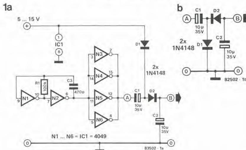
trasferisce una parte della sua carica al condensatore C2. Questo fa aumentare la tensione ai capi del condensatore C2 ad un livello che è almeno doppio di quello della tensione di alimentazione. Se D1 è collegato a massa e le polarità dei diodi D1 e D2 e dei condensatori C1 e C2 (Figura 1b) sono invertite, l'uscita al punto A sarà una tensione negativa e, nelle condizioni di assenza di carico,
