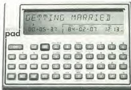
data che intercorra in questo periodo. Il calendario può anche essere utilizzato per fissare appuntamenti o per segnalare, mediante un allarme, ricorrenze particolari fino al 31 dicembre 1999, oltre che per conservare un registro permanente degli appuntamenti.
