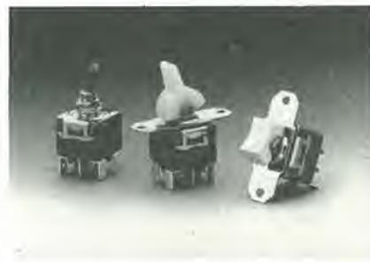
Conformi alle norme UL - CSA - VDE, gli interruttori della serie P sono fabbricati con un corpo in DAP, hanno contatti di argento, offrono una rigidità dielettrica di 1500 Veff e possono essere impiegati in un campo di temperatura da -20 a 85  $^\circ\text{C}$ .
