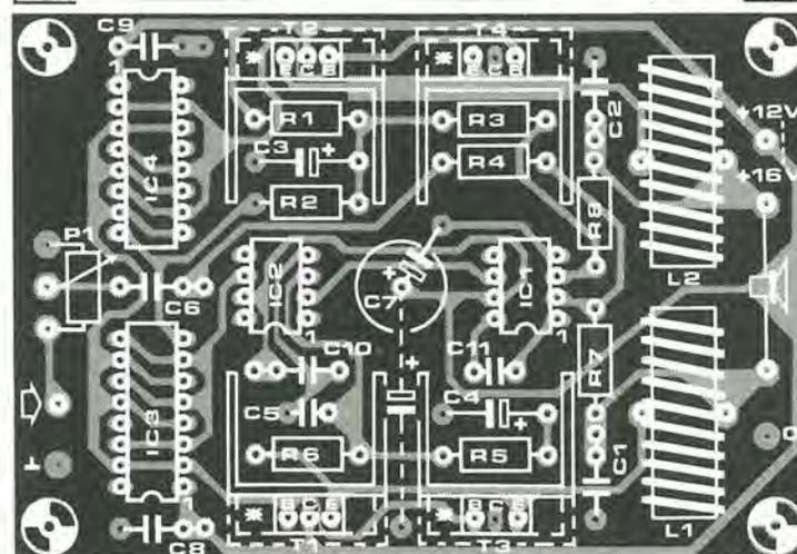
di cross-over, in quanto la commutazione richiede un tempo finito. La qualità viene in certo qual modo migliorata usando un anello di retroazione simmetrico, che è formato dai componenti collegati a C1. Questo amplificatore digitale funziona in modo
