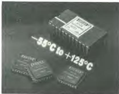
L'accuratezza totale, senza regolazioni a trimmer, è  $\pm 0,25\%$  FSR e diminuisce a  $\pm 0,4\%$  FSR in temperatura. Con regolazione esterna dell'offset a  $25$  °C, l'accuratezza totale è inferiore a  $\pm 0,03$  FSR in tutto il range da  $-55$  a  $125$  °C.
