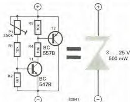
resistenza da 10 k $\Omega$ , e poi dovrà essere regolato il potenziometro P1, finché non sarà stata raggiunta la tensione di zener desiderata. Se il circuito viene usato per sostituire uno zener in un montaggio già esistente, non è naturalmente necessaria la resistenza extra da 10 k $\Omega$ . La massima corrente ammessa attraverso questo zener variabile è di 100 mA. Il transistor T2 può dissipare al massimo 100 mW.
