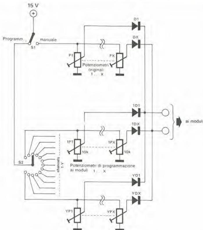
discreti ed economica. Ciò che qui proponiamo è la base di un sistema che potrà essere ampliato a volontà. Un commutatore principale permette di scegliere tra il normale funzionamento manuale (con i potenziometri tradizionali che agiscono come di consueto) ed il funzionamento a programmazione. In quest'ultimo caso, i normali potenziometri vengono disattivati; un commutatore multipolare (S2) collega in successione batterie di trimmer di programmazione, ciascuno dei quali
