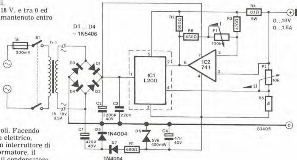
limiti davvero ragionevoli. Facendo riferimento allo schema elettrico, l'ingresso comprende un interruttore di rete, il fusibile, il trasformatore, il rettificatore a ponte ed il condensatore di livellamento (C2). Il diodo D5 ed il
