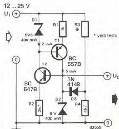
attraverso D3 mandando in conduzione T2 (e di conseguenza T1). Il valore di R3 deve essere scelto in modo che il diodo D3 blocchi non appena la tensione ai capi del diodo zener si sia stabilizzata. Occorre perciò fare
