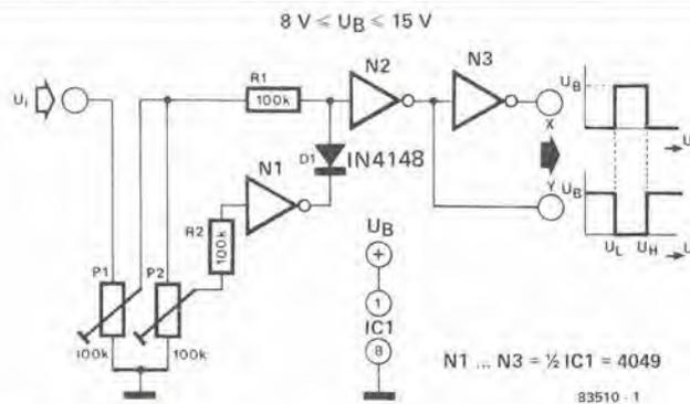
della finestra  $U_H-U_L$ . La Figura 2 chiarisce il funzionamento del circuito. I valori di tensione indicati valgono per una tensione di alimentazione di 10 V. E' mostrata la tensione triangolare d'ingresso del comparatore a finestra, nonché la tensione di uscita al punto X. Quando la tensione di ingresso supera il valore minimo  $U_L$  regolato con P1, la tensione all'uscita X va a livello logico "1", tramite gli invertitori N2 ed N3. Se la
