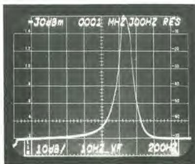
mostra lo schema elettrico, il filtro ha la normale configurazione a scala, con quarzi standard da 1 MHz. La fotografia presa su un analizzatore di spettro dà una convincente prova delle sue ottime prestazioni. Essa mostra che la banda passante a 6 dB è di soli 120 Hz, mentre quella a 60 dB è di soli 400 Hz! La perdita di inserzione di 4 dB è ragionevole. Inoltre, poiché la tolleranza dei cristalli da 1 MHz è relativamente piccola, questo filtro può essere "riprodotto" molto facilmente.
