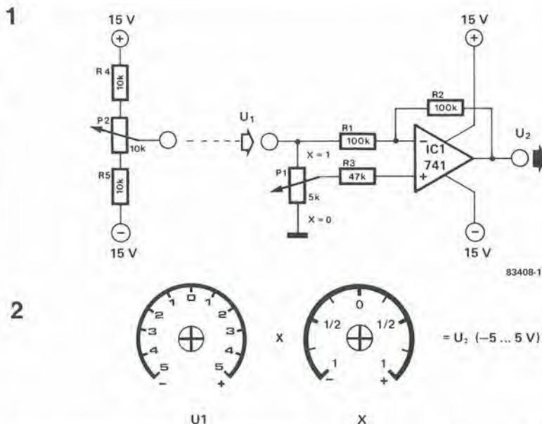
dell'amplificatore operazionale, tramite il potenziometro P1 e la resistenza R3; di conseguenza, il livello del segnale all'ingresso non invertente è determinato dalla posizione di P1. La tensione totale di uscita risultante è data da  $U_2 = (2x - 1) U_1$ , dove x
