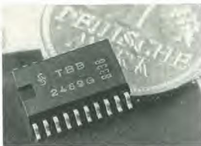
confort TBB 469 (DIP 22) presenta collegamenti supplementari per la regolazione della frequenza intermedia, per la messa a punto del volume BF, nonché per mute ed intensità di campo.
