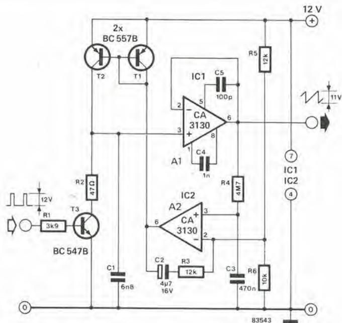
necessario, i due livelli vengono equalizzati mediante T1 e T2. La costante di tempo del sistema di controllo è formata dalla resistenza R4 e dal condensatore C3. Se la costante di tempo fosse troppo piccola, il fronte di salita dell'onda a denti di sega tenderebbe ad assumere la forma sinusoidale e la linearità del segnale ne soffrirebbe. Con i valori mostrati sullo schema, la banda di frequenza sta tra 100 Hz e 5 kHz, ma può essere estesa
