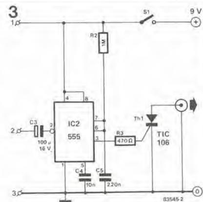
elettronico. L'alimentazione non costituisce un problema: poiché la corrente assorbita dal circuito è di soli 30 mA circa, una batteria da 9 V durerà molto tempo.
