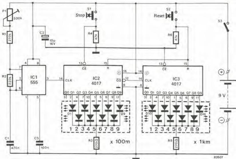
pulsante S2 del misuratore di distanza. I contatori IC2 ed IC3, collegati in serie, vengono azzerati entrambi da un segnale di reset. Il segnale di uscita di IC1 viene applicato all'ingresso di clock del primo contatore (IC2), e poi viene da questo elaborato. Dopo 0,3 secondi si accende il LED D1. Ciascuno dei successivi impulsi di clock attiva in sequenza un diodo ogni 0,3 secondi. Quando inizierà il tuono, il conteggio verrà interrotto premendo il pulsante S1.
