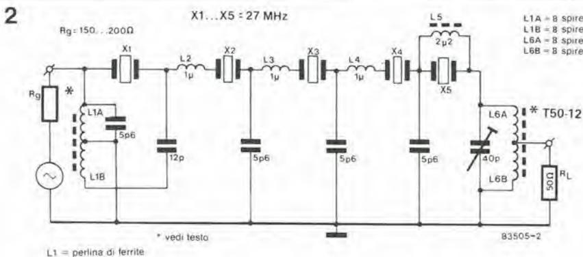
impedenze per radiofrequenza incapsulate. La bobina L6 è anch'essa bifilare, con 2 x 8 spire di rame smaltato con diametro 0,2...0,5 mm, su un rocchetto T50-12. Il filtro potrà essere montato su una piccola piastrina di Veroboard. Le bobine dovranno essere schermate una dall'altra tramite schermi collegati a massa. Anche gli involucri dei cristalli dovranno essere collegati a massa. Un'ulteriore elaborazione del segnale potrà essere effettuata, con risultati
