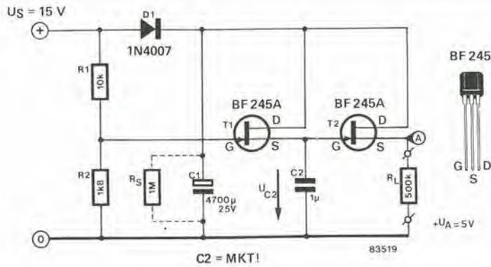
diminuisce ulteriormente, il Fet T2 rimarrebbe attivo ma la tensione di uscita diminuirebbe in proporzione. Per il corretto funzionamento del circuito è molto importante scegliere, per C2, un condensatore del tipo MKT,
