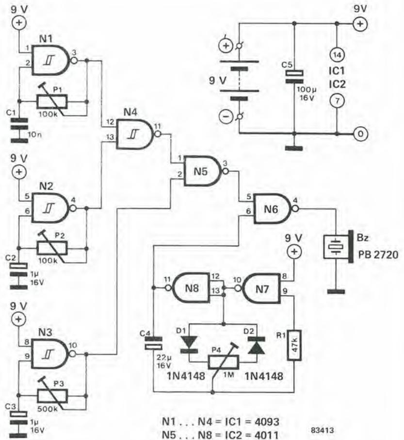
essere sostituito da un condensatore di capacità maggiore. La prima regolazione da effettuare nel circuito è quella di P1, in modo da ottenere la nota base. Per questo scopo, il cicalino deve essere collegato direttamente all'uscita della porta N1 (piedino 3 di IC1). Il cicalino dovrà poi essere collegato al piedino 11 di IC1 e P2 verrà regolato per ottenere il tipico suono emesso da un grillo. Collegare poi il cicalino al piedino 3 di IC1 e regolare P3 in modo che il frinire possa
