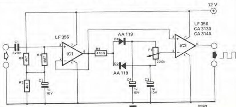
garantisce che la tensione ai capi di C3 non superi metà della tensione di alimentazione, meno il valore di picco della tensione negativa. I valori scelti in questa parte del circuito sono tali che le tensioni di riferimento, ai capi dei condensatori, rimangono molto costanti quando il segnale di ingresso ha una frequenza maggiore di circa 10 Hz. Il segnale di uscita di IC1 passa
