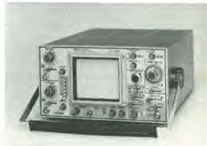
Una vasta possibilità di scelta di "modi" di accoppiamenti (video, linea, ecc.) e di trigger rendono facile la visualizzazione di forme d'onda comunque complesse. Lo strumento è anche dotato di holdoff regolabile per la facile osservazione di segnali complessi, quali i treni di impulsi. Il CRT di 10 x 8 div ha una tensione di accelerazione di 16 kV.
