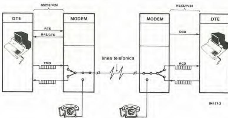
Figura 2. Il DTE della stazione trasmittente costringe il modem a prepararsi a trasmettere (RTS) e poi, quando riceve la risposta RFS, trasmette i dati (TMD). Il modem della stazione ricevente segnala al suo DTE il momento in cui riceve la portante.
