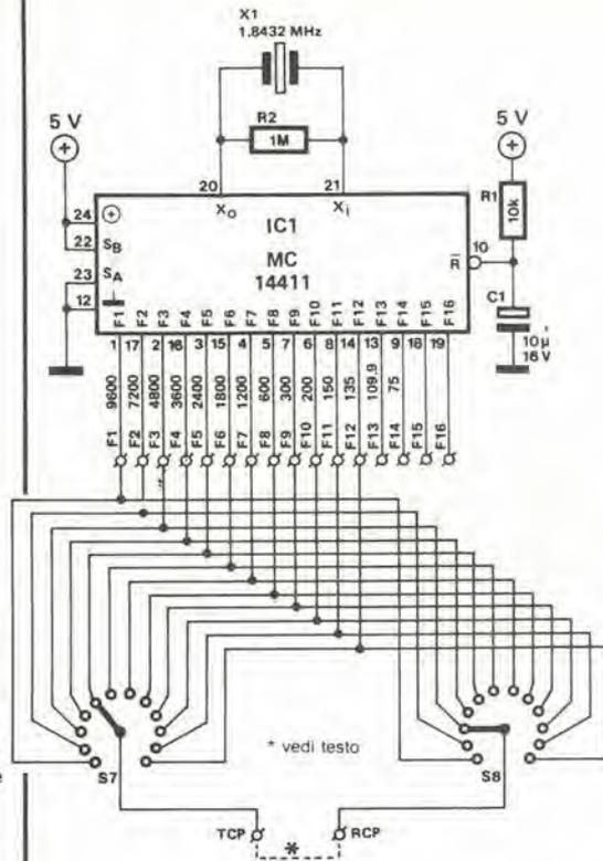
Figura 1b. Anche se siamo particolarmente interessati nei riguardi della struttura interna dello UART usato in questo circuito, l'oscillatore ha invece pochi motivi per attirare la nostra attenzione. Osserviamo, per inciso, che la frequenza dell'oscillatore a quarzo (F16) e la metà di questa frequenza (F15) sono presenti rispettivamente ai piedini 18 e 19. Comunque, nessuna di queste due frequenze sarà usata nel nostro circuito.
