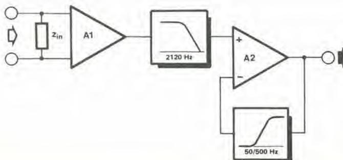
Figura 2. La correzione ad alta frequenza nel preamplificatore dinamico avviene dopo il primo stadio amplificatore, mentre la correzione in bassa frequenza è incorporata nel circuito di controreazione del secondo amplificatore. Non è necessario un condensatore di ingresso, perché questo ingresso è simmetrico.
