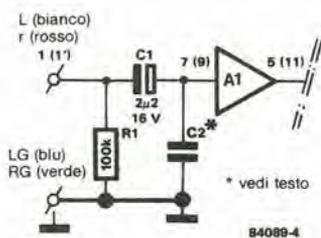
Figura 4. Lo stadio di ingresso del preamplificatore è stato qui predisposto secondo una configurazione asimmetrica. Il condensatore C2, unitamente alla capacità del cavo compreso tra il pick-up ed il circuito di ingresso, serve ad adattare l'impedenza della cartuccia a quella d'ingresso. La resistenza in posizione R3 dovrà essere ridotta a 120 k $\Omega$ , per garantire la migliore estensione dinamica.
