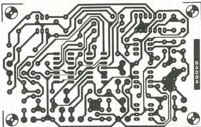
Figura 7. Disposizione dei componenti e piste di rame del circuito stampato. Impiegandolo, la costruzione dell'invertitore risulterà molto semplificata.
