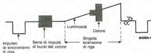
Figura 4. Composizione base di una riga di scansione. La luminanza e la cromaticità sono strettamente interacciate. Osservare che questa rappresentazione e quella della Figura 5 sono assolutamente schematiche: se osservate su un oscilloscopio, avranno un aspetto molto diverso!
