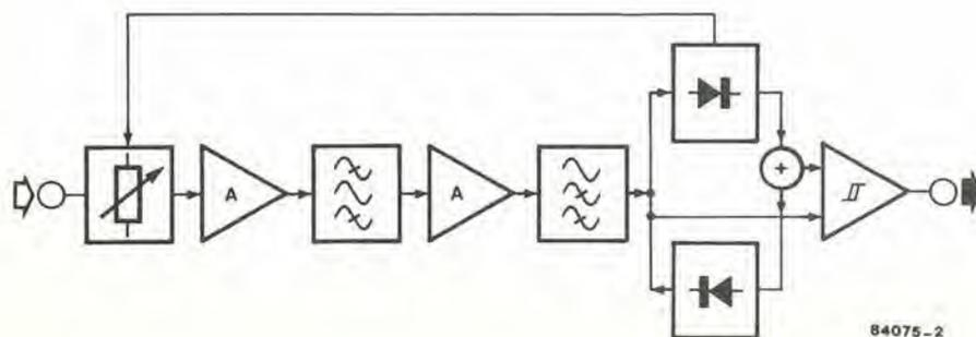
Figura 2. Schema a blocchi del ripulitore d'impulsi, che consiste in alcuni amplificatori e filtri, una coppia di rettificatori di picco, una sezione comparatore ed un attenuatore.
