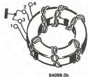
Figura 3. Arrangiamenti analoghi a quelli di Figura 2, ma costruiti con filo di rame smaltato, avvolto su toroidi di ferrite.
