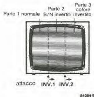
Figura 9. Quando due invertitori sono collegati in cascata, ed entrambi sono muniti del trimmer addizionale illustrato in Figura 8, diviene possibile questo tipo di effetti speciali.
