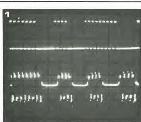
Figura 1. Questi sono gli impulsi che appaiono all'uscita per cassette dello ZX81 (in alto). Dopo il trattamento da parte del registratore a cassette, il segnale (in basso) non appare più altrettanto "pulito".
