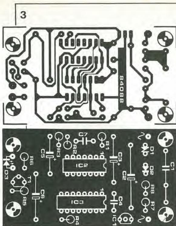
Figura 3. Usando questa bassetta stampata, la costruzione del circuito non dovrebbe presentare problemi. Potrà anche aiutarvi nel montaggio la fotografia pubblicata in fondo a questa pagina.
