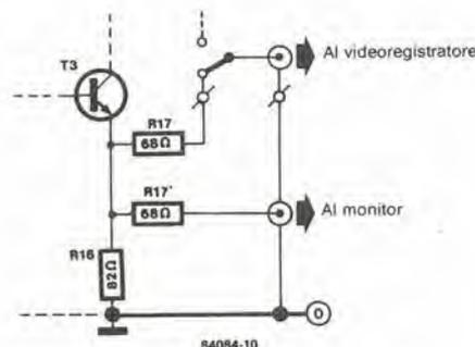
Figura 10. La piccola modifica qui illustrata permette di osservare le immagini, con un monitor, nel corso della registrazione.
