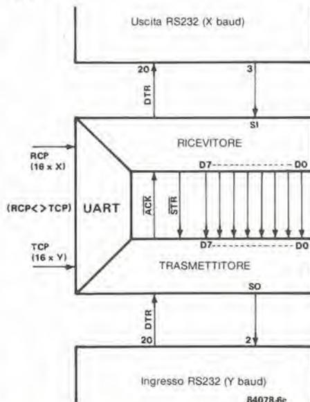
Figura 6a. Qui il convertitore viene usato tra un'uscita seriale ed un'ingresso in parallelo. Il numero dei piedini corrisponde alla disposizione generalmente usata per questo tipo di collegamenti.
