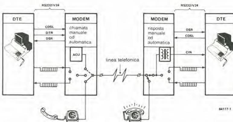
Figura 1. Questa è la procedura necessaria per effettuare una chiamata, sia manuale (quando l'utente forma il numero con il combinatore) che automatica (ACU). Il segnale di suoneria viene rilevato dal modem ricevente, che in seguito invia segnali al DTE, attivando la linea CIN.
