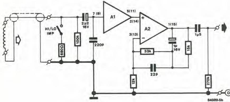
Figura 5. Il preamplificatore nella configurazione lineare per segnali microfonic. L'ingresso potrà essere simmetrico (5a) oppure asimmetrico (5b).
