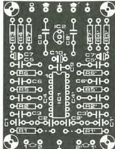
ancora ronzio (il braccio è correttamente collegato a massa?), provare con un ingresso asimmetrico. Questo potrà essere eseguito semplicemente modificando il circuito d'ingresso, come mostrato in Figura 4. La pista del circuito stampato diretta al piedino 6 (10) del circuito integrato dovrebbe essere interrotta con l'aiuto di un tagliapiste o di un coltellino affilato.
