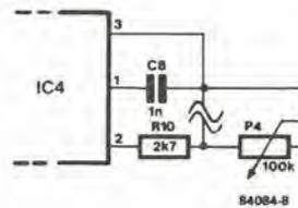
Figura 8. Ecco come può essere collegato un trimmer addizionale in serie ad R10, per allargare il periodo di trigger di IC4. Le possibilità permesse da questa semplice modifica sono spiegate nel testo.
