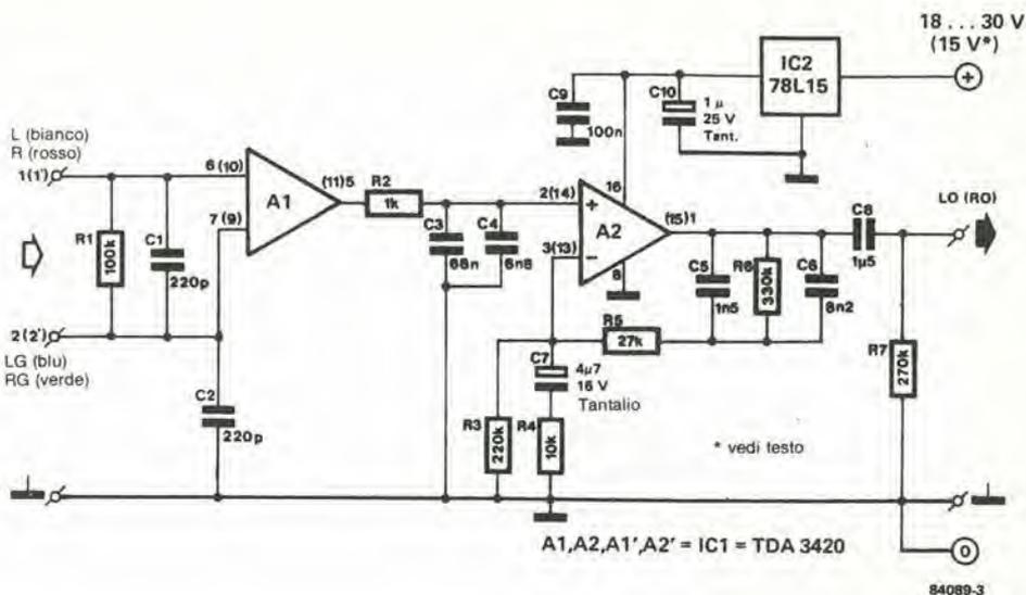
Figura 3. Lo schema elettrico qui illustrato serve per un solo canale. A1 è uno stadio preamplificatore a basso rumore con retroazione interna ed un guadagno predeterminato di circa 28 dB. A2 è un amplificatore operazionale. Il guadagno totale, alla frequenza di 1 kHz, è dell'ordine di 40 dB.
