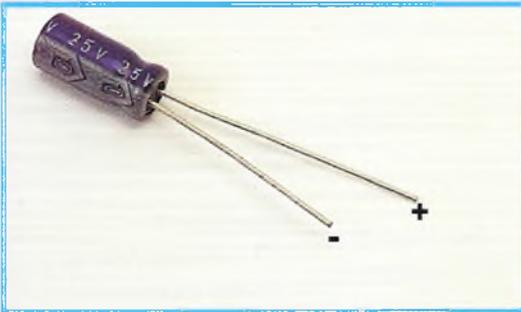
O terminal de maior comprimento de um capacitor eletrolítico corresponde ao positivo.
