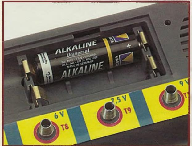
Sistema de conexão de pilhas
