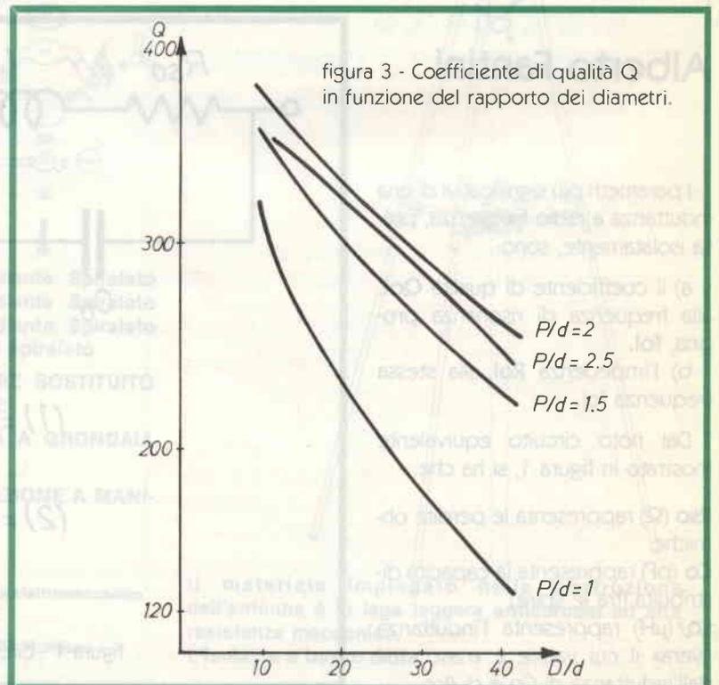
figura 3 - Coefficiente di qualità Q in funzione del rapporto dei diametri.
