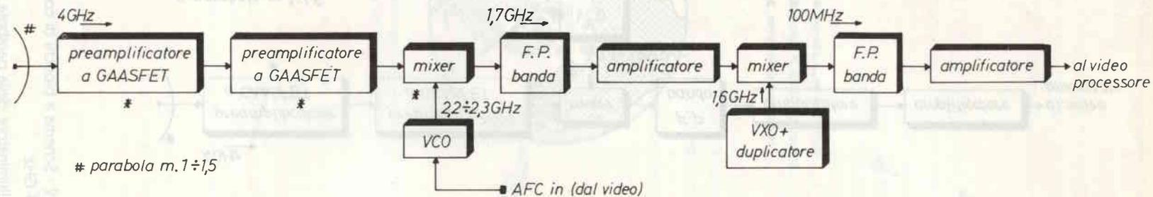
figura 4 - Schema a blocchi di convertitore per i 12 GHz.
