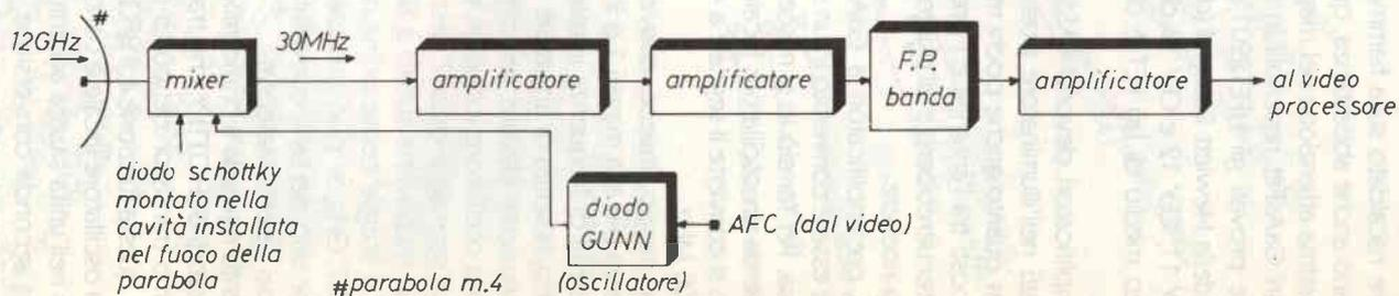
tutti gli stadi a 12 GHz devono necessariamente essere alloggiati in cavità risonante (lavorando a 4 GHz si potevano ancora realizzare circuiti con le linee di accordo incise su vetronite, ma a 12 GHz questo sistema non offre più risultati accettabili).
