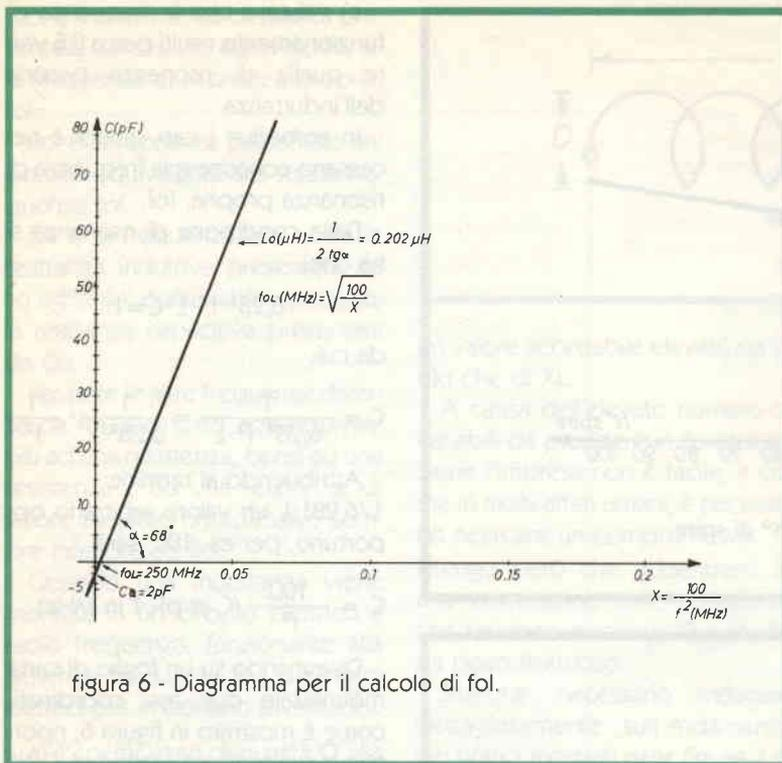
figura 6 - Diagramma per il calcolo di  $f_{oL}$ .
