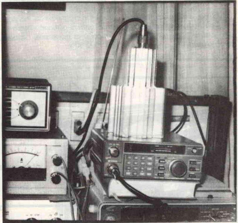
zero onde stazionarie e, sostituito poi con l'antenna, di controllare se questa ci dà la stessa misura oppure è reattiva e quindi... dimensionarla altrimenti per eliminare le **onde stazionarie**.
