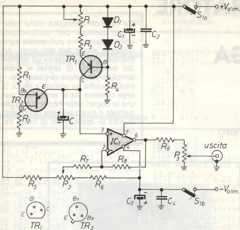
figura 1 - Schema elettrico «Generatore denti di sega»
