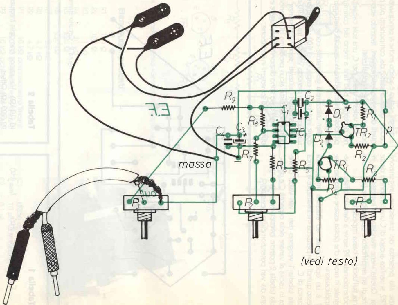
figura 3 - Schema pratico di montaggio
