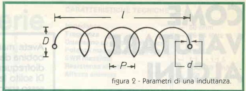
figura 2 - Parametri di una induttanza.
