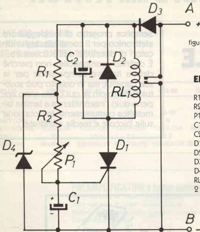
figura 2 - Schema elettrico del lampeggiatore.
