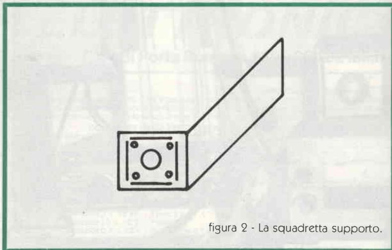
previa la foratura del tratto più corto con punta da 12,5 mm, si introduce una presa da pannello SO 239; si praticano quattro fori da 3,5 mm e si stringe la flangia con quattro bulloni 3x10, avendo cura di inserire sotto uno di questi una paglietta e di far sporgere all'interno della squadretta la flangia quadrata dell'SO 239.
