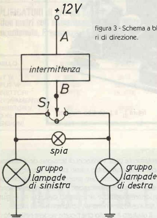
figura 3 - Schema a blocchi del sistema di indicatori di direzione.
