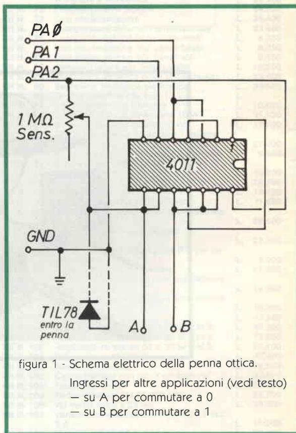
La tensione di +5 V viene mantenuta su PA2 per fornire l'alimentazione al circuito integrato. La corrente richiesta è trascurabile, e il port è perfettamente in grado di fornirla direttamente. PA1 viene usato per resettare il circuito «lacht» che è formato da due porte NAND connesse come flip-flop RS.
