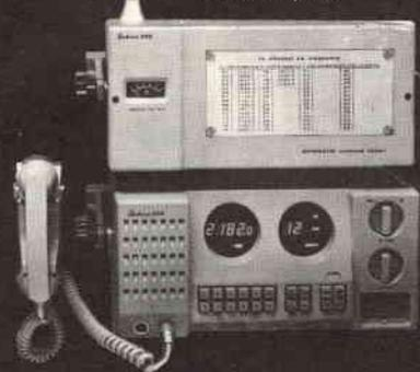
Il ricetrasmittitore LABES 200 a banda laterale unica è il risultato di studi durati alcuni anni per dare alla nautica da diporto e a tutte le imbarcazioni di medio tonnellaggio un apparato completo ed efficiente.
