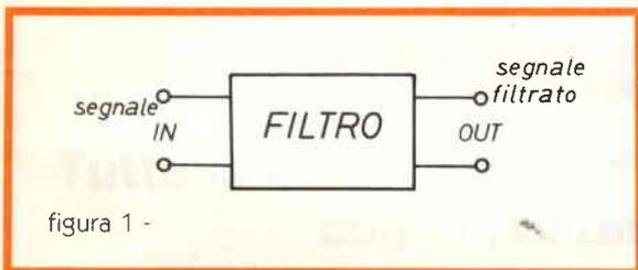
Si definisce BANDA PASSANTE di un filtro elettrico il campo di frequenza per cui l'ampiezza in uscita
