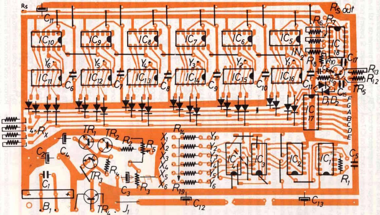
figura 7 - Piano di montaggio della «Piastra» principale del frequenzimetro.
