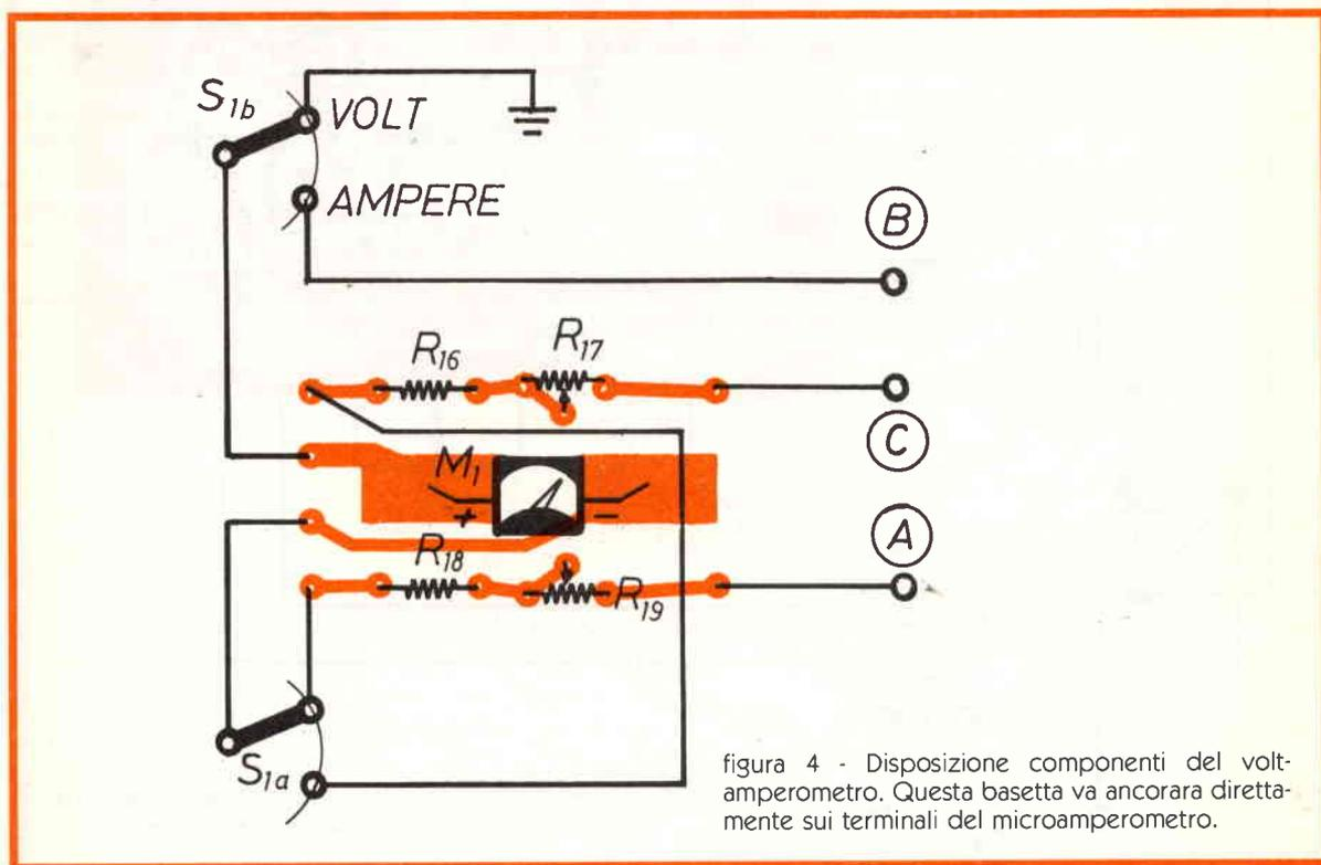
figura 4 - Disposizione componenti del volt-amperometro. Questa basetta va ancorata direttamente sui terminali del microamperometro.
