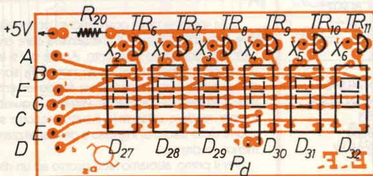
figura 5 - Vista frontale del display numerico del frequenzimetro.
