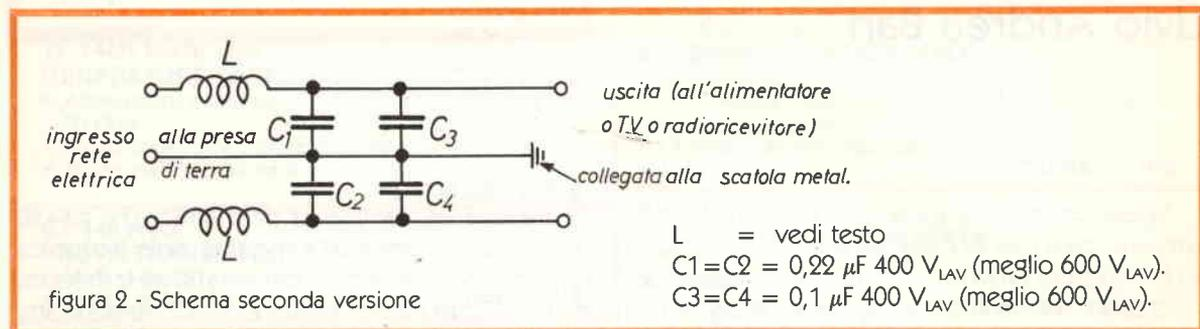
Queste induttanze sono realizzate effettuando un avvolgimento a spire affiancate di filo smaltato da 0,8 mm di diametro su un supporto di materiale isolante per una lunghezza di circa 130 mm. Il diametro del supporto è di circa 30 mm. Il numero delle spire risulterà di circa 160.
