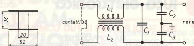
figura 3 - Filtro per contatti di tipo intermittente:
