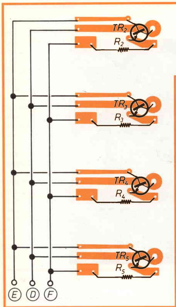
figura 5 - Disposizione componenti sulle quattro basette necessarie per i collegamenti relativi a TR<sub>2</sub> - TR<sub>3</sub> - TR<sub>4</sub> - TR<sub>5</sub>. I resistori R<sub>2</sub> - R<sub>3</sub> - R<sub>4</sub> - R<sub>5</sub> vanno saldati sul lato rame.
