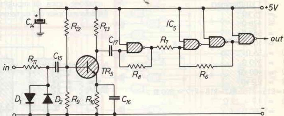
figura 4 - Stadio d'ingresso BF del frequenzimetro.
