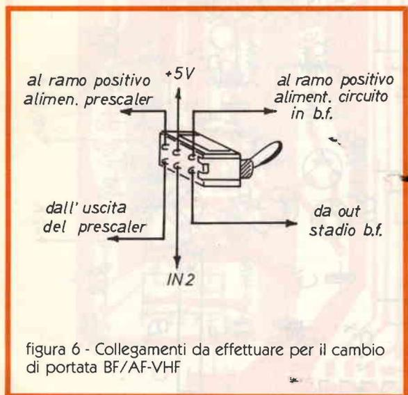
figura 6 - Collegamenti da effettuare per il cambio di portata BF/AF-VHF
