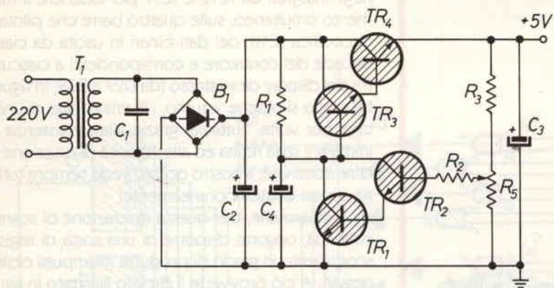
figura 3 - L'alimentatore stabilizzato
