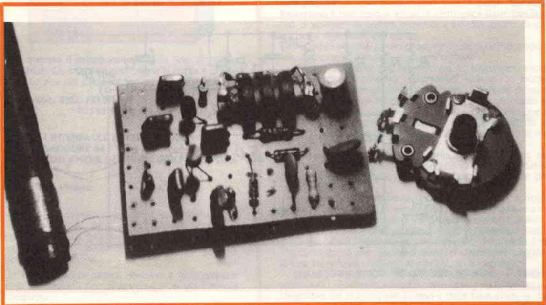
Questo radiorecettore per onde medie funziona benissimo senza l'ausilio di alcuna antenna supplementare e, grazie alle buone doti di sensibilità e selettività, è in grado di farci ascoltare molte stazioni anche durante l'uso in «portatile». Tali caratteristiche, unite ad uno schema decisamente semplice, ne consigliano la costruzione a tutti quei Lettori che vogliono avvicinarsi all'affascinante mondo della radio.
