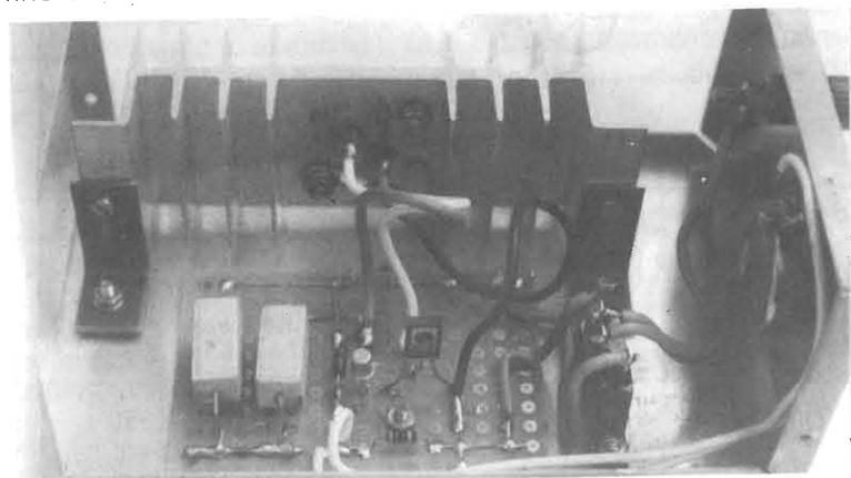
Vista del circuito di figura 6. È stato aggiunto un ponte raddrizzatore in ingresso visibile sulla destra. La R4 qui è sostituita da 2 resistenze da 0,22  $\Omega$  in serie tra loro (visibili a sinistra in basso).
