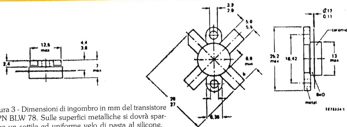
figura 3 - Dimensioni di ingombro in mm del transistor NPN BLW 78. Sulle superfici metalliche si dovrà spargere un sottile ed uniforme velo di pasta al silicone.
