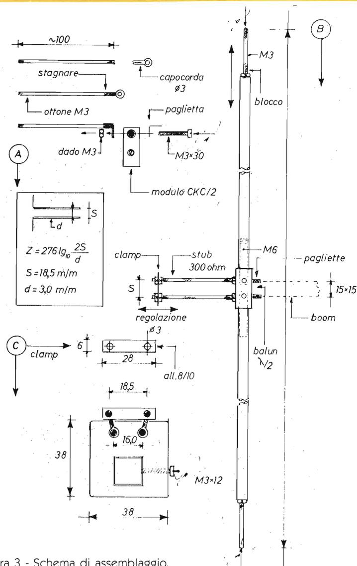
figura 3 - Schema di assemblaggio.
