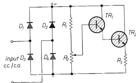
figura 4 - Carico a transistori non polarizzato.
