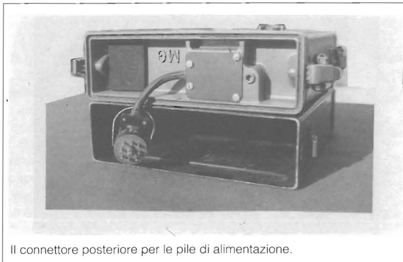
Il connettore posteriore per le pile di alimentazione.
