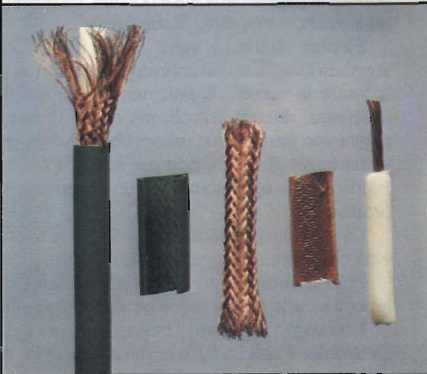
A BASSA PERDITA PER VHF/UHF • MISURE ESATTE DEL RG213 PER CONNETTORI «PL-N» e «BNC» • FORMAZIONE CC 7x0,75 • DIELETTRICO FOAM (ESPANSO) • FOGLIA DI RAME 6 DECIMI CON GUAINA ANTIMIGRANTE INCORPORATA • CALZA DI RAME NORME MIL • GUAINA VERDE «ECOLOGICA» IN POLITENE  $\varnothing$  10,30
