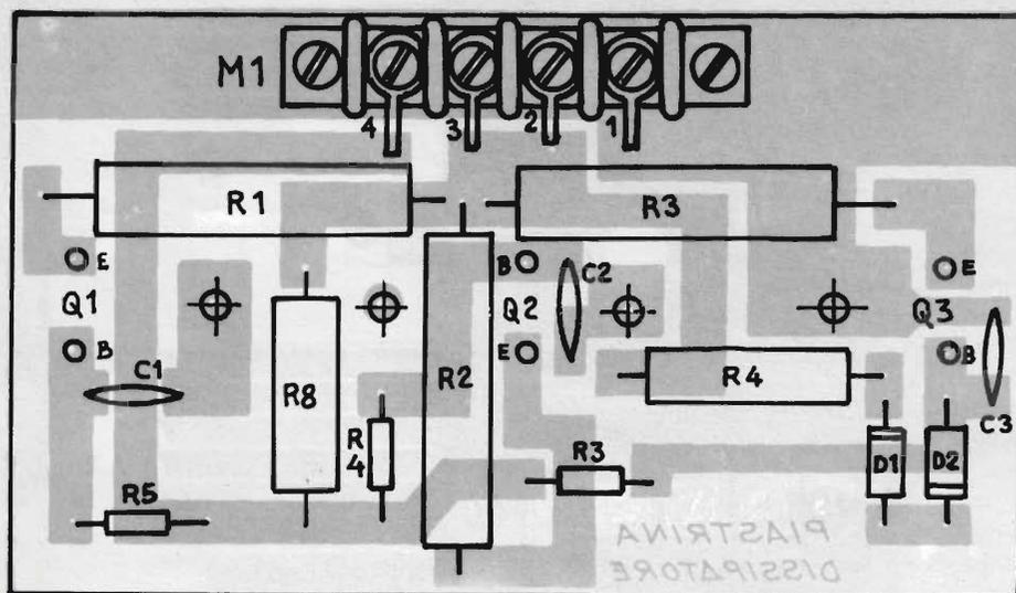
figura 5 - Disposizione componenti piastrina di regolazione.
