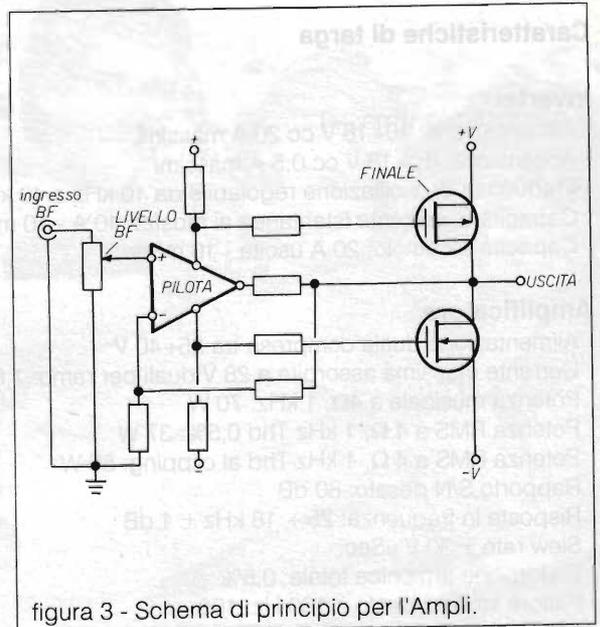
figura 3 - Schema di principio per l'Ampli.
