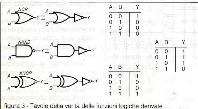
figura 3 - Tavole della verità delle funzioni logiche derivate
