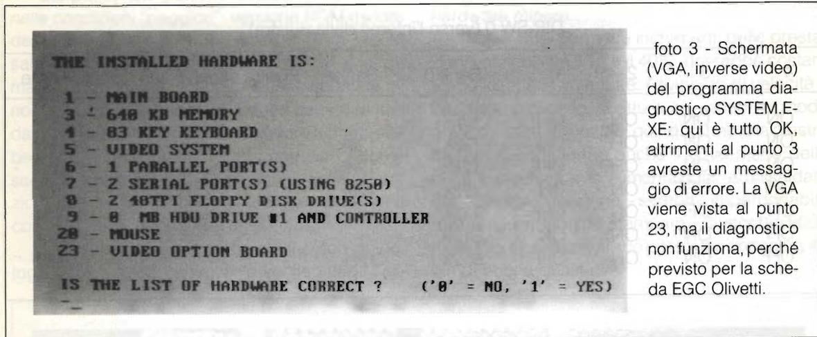
foto 3 - Schermata (VGA, inverse video) del programma diagnostico SYSTEM.EXE: qui è tutto OK, altrimenti al punto 3 avreste un messaggio di errore. La VGA viene vista al punto 23, ma il diagnostico non funziona, perché previsto per la scheda EGC Olivetti.
