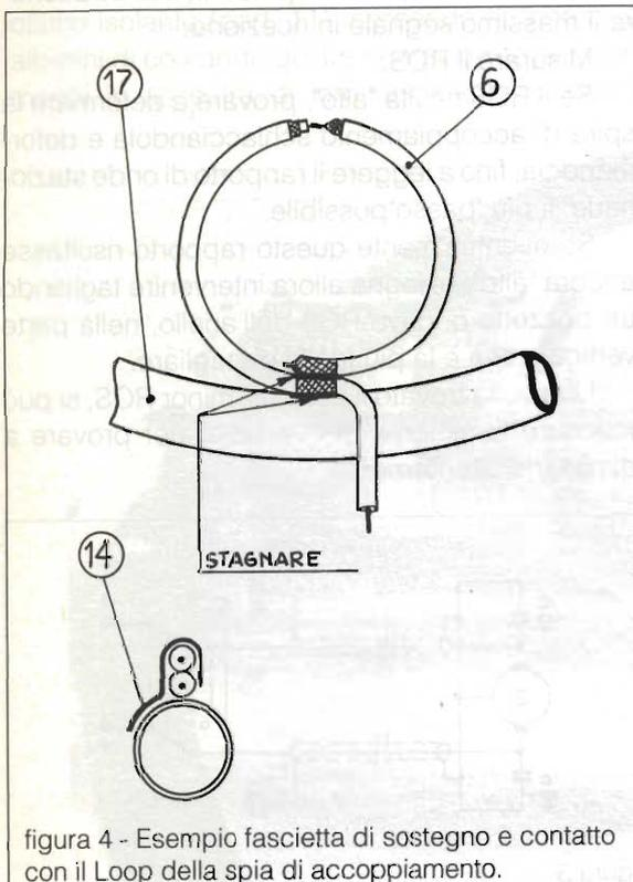
figura 4 - Esempio fascietta di sostegno e contatto con il Loop della spia di accoppiamento.
