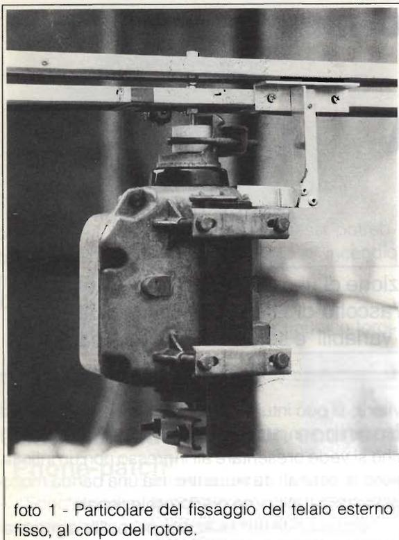
foto 1 - Particolare del fissaggio del telaio esterno fisso, al corpo del rotore.
