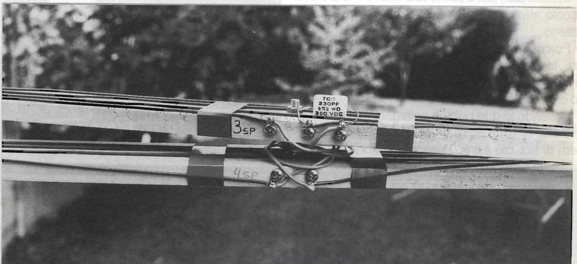
foto 2 - Particolare della giunzione superiore, con le pagliette di ancoraggio, il condensatore ed il collegamento lasco per la rotazione.
