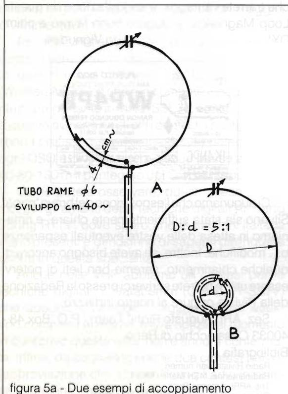
figura 5a - Due esempi di accoppiamento
