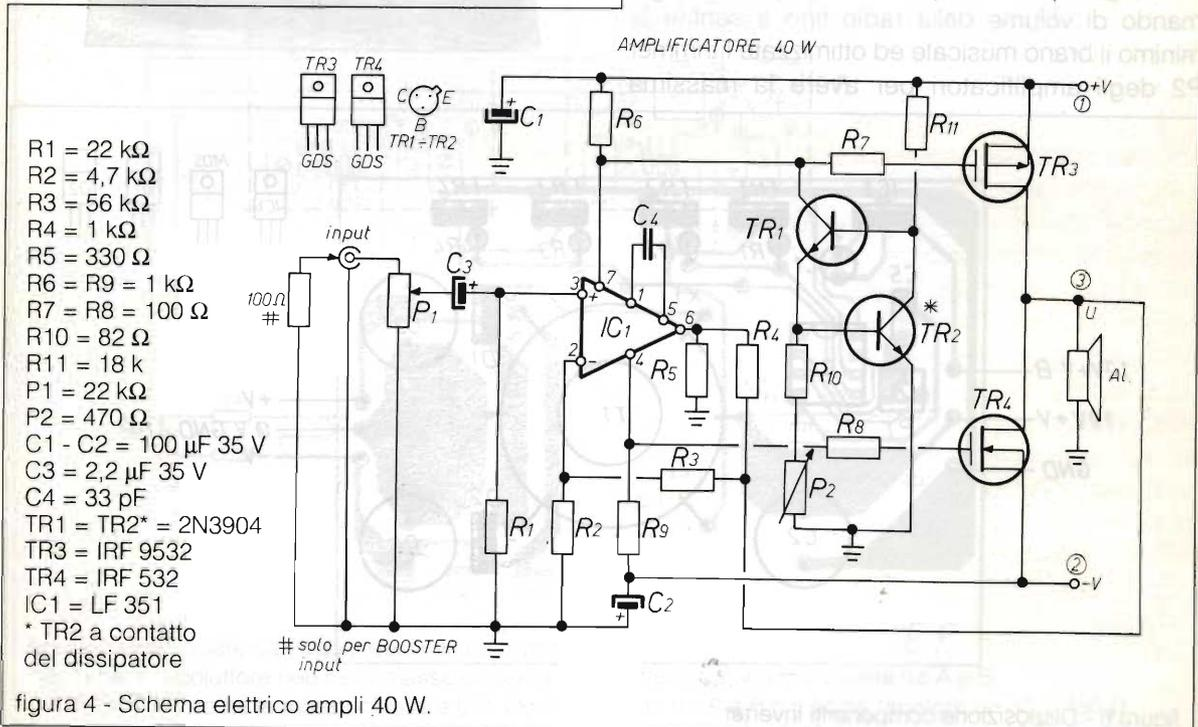
figura 4 - Schema elettrico ampli 40 W.
