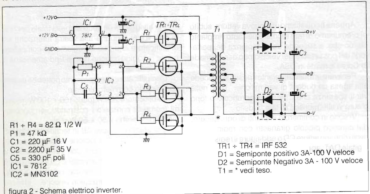
figura 2 - Schema elettrico inverter.
