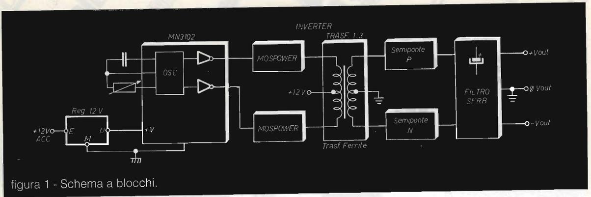
figura 1 - Schema a blocchi.
