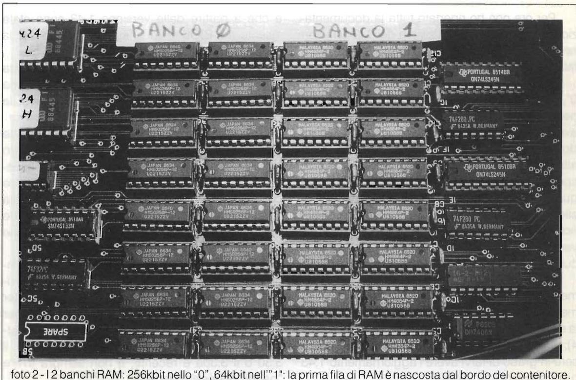
foto 2 - 12 banchi RAM: 256kbit nello "0", 64kbit nell' "1": la prima fila di RAM è nascosta dal bordo del contenitore.
