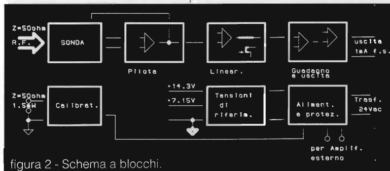
figura 2 - Schema a blocchi.
