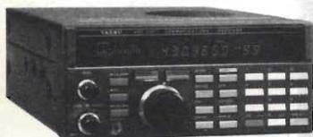
Ricevitore sintonia continua da 60 MHz a 905 MHz.
