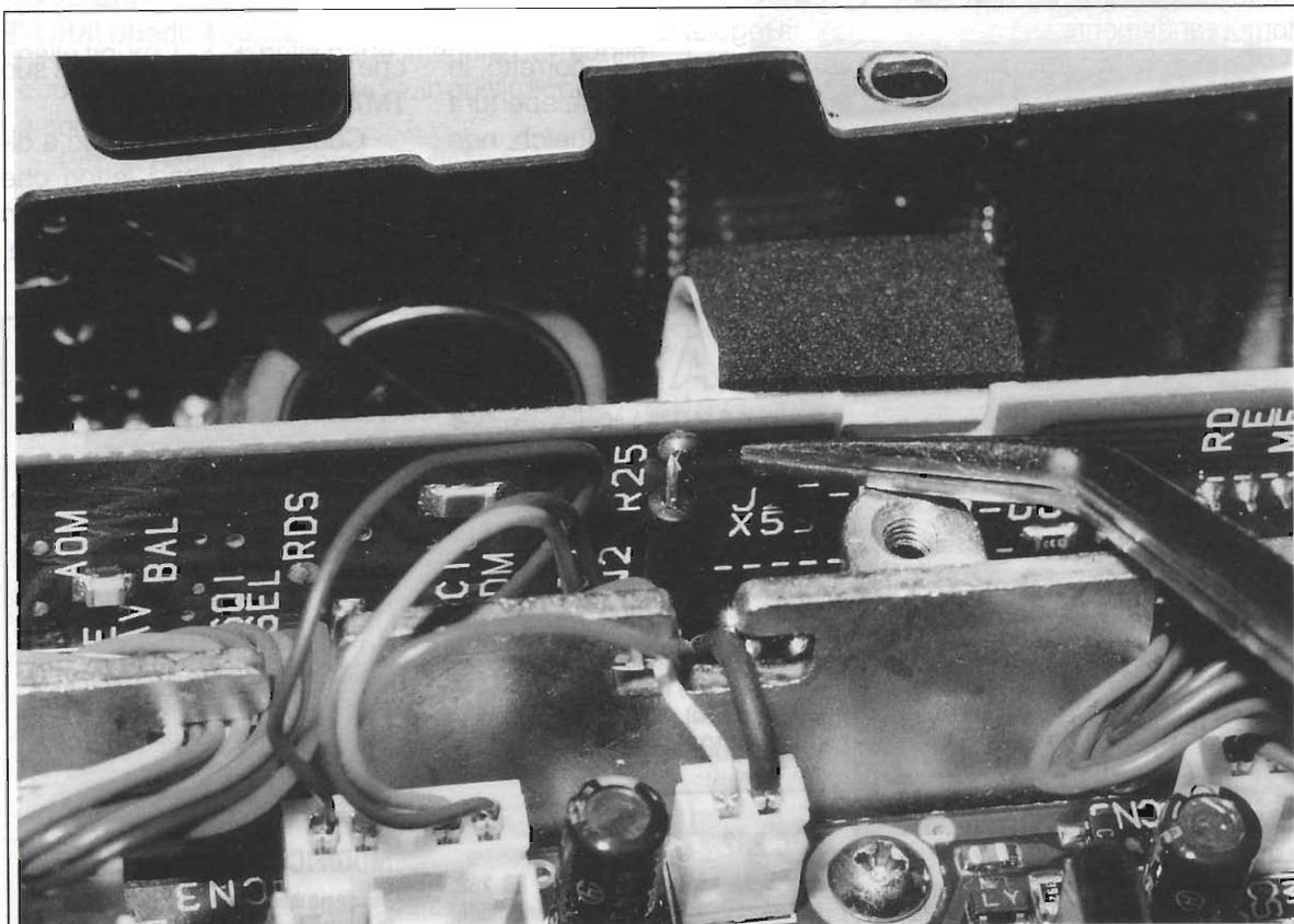
figura 7 - Localizzazione dei chip da rimuovere per abilitare il TOT (Time-Over Timer). In questa foto il chip in questione non è ancora stato rimosso. Notare il connettore per il flat-cable che è stato rimosso per accedere al chip.
