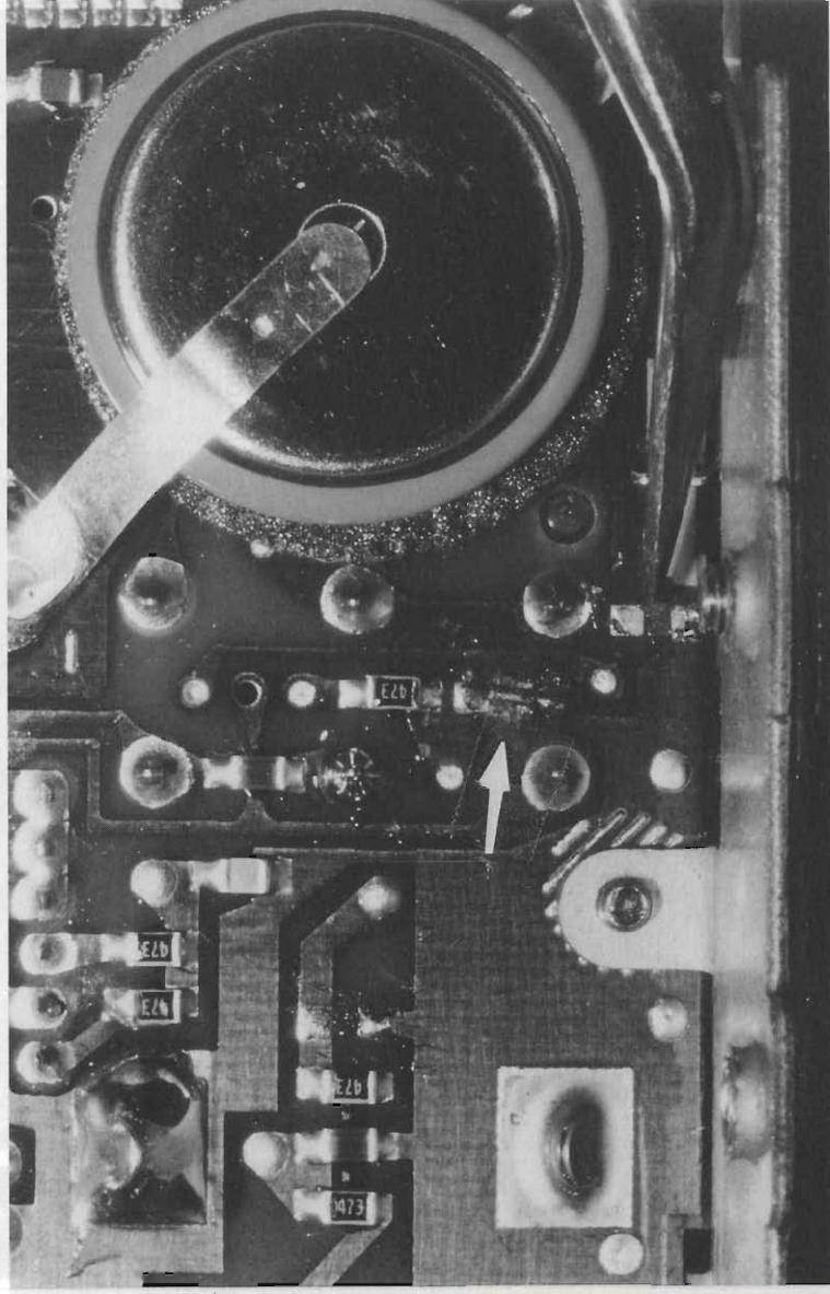
figura 5 - Particolare del ponticello da saldare, effettuante l'espansione di banda (freccia), il punto indicato dalla pinzetta si riferisce ad un'altra modifica (vedi testo).
