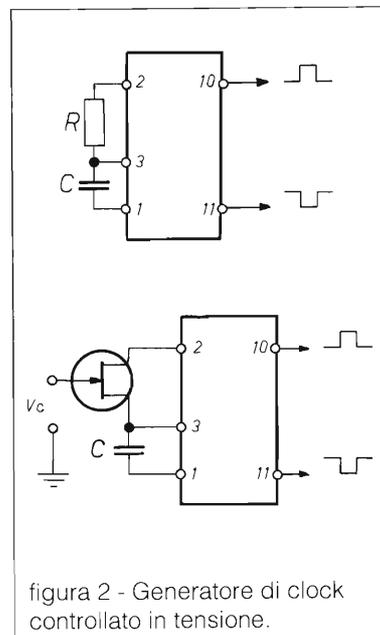
figura 2 - Generatore di clock controllato in tensione.
