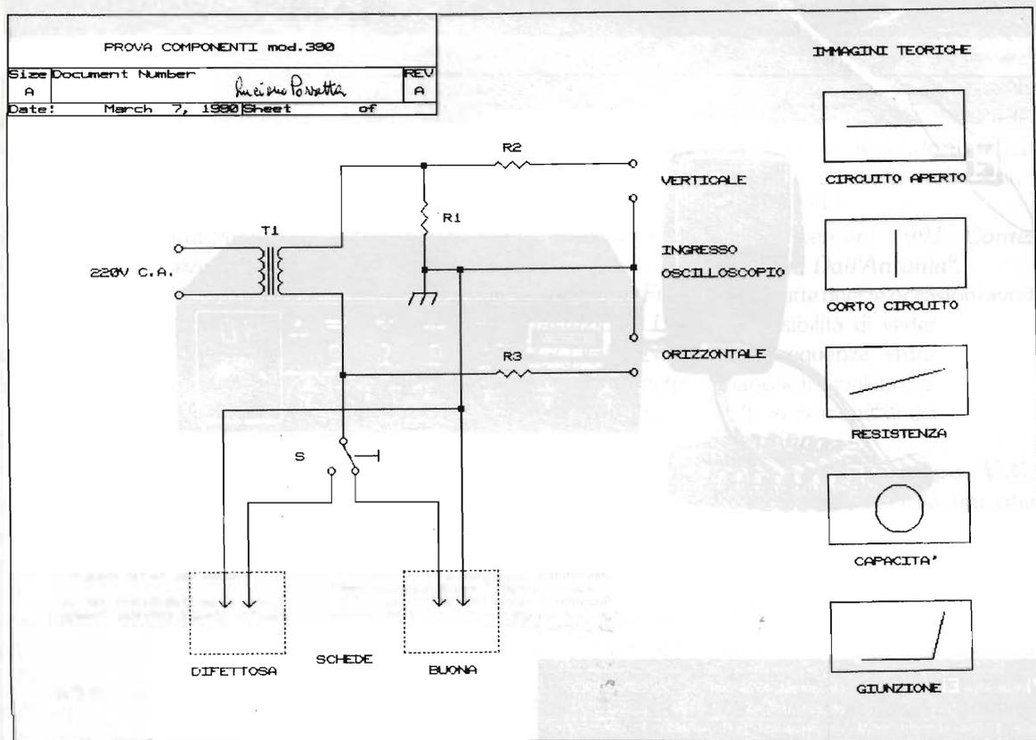
Confrontando una scheda funzionante ad una difettosa, manovrando il pulsante "S", si può effettuare la prova verificando che la forma d'onda rilevata su un componente della scheda buona sia uguale a quella rilevata sullo stesso componente di quella difettosa; in caso contrario si identificherà immediatamente il componente difettoso.
