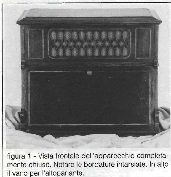
figura 1 - Vista frontale dell'apparecchio completamente chiuso. Notare le bordature intarsiate. In alto il vano per l'altoparlante.
