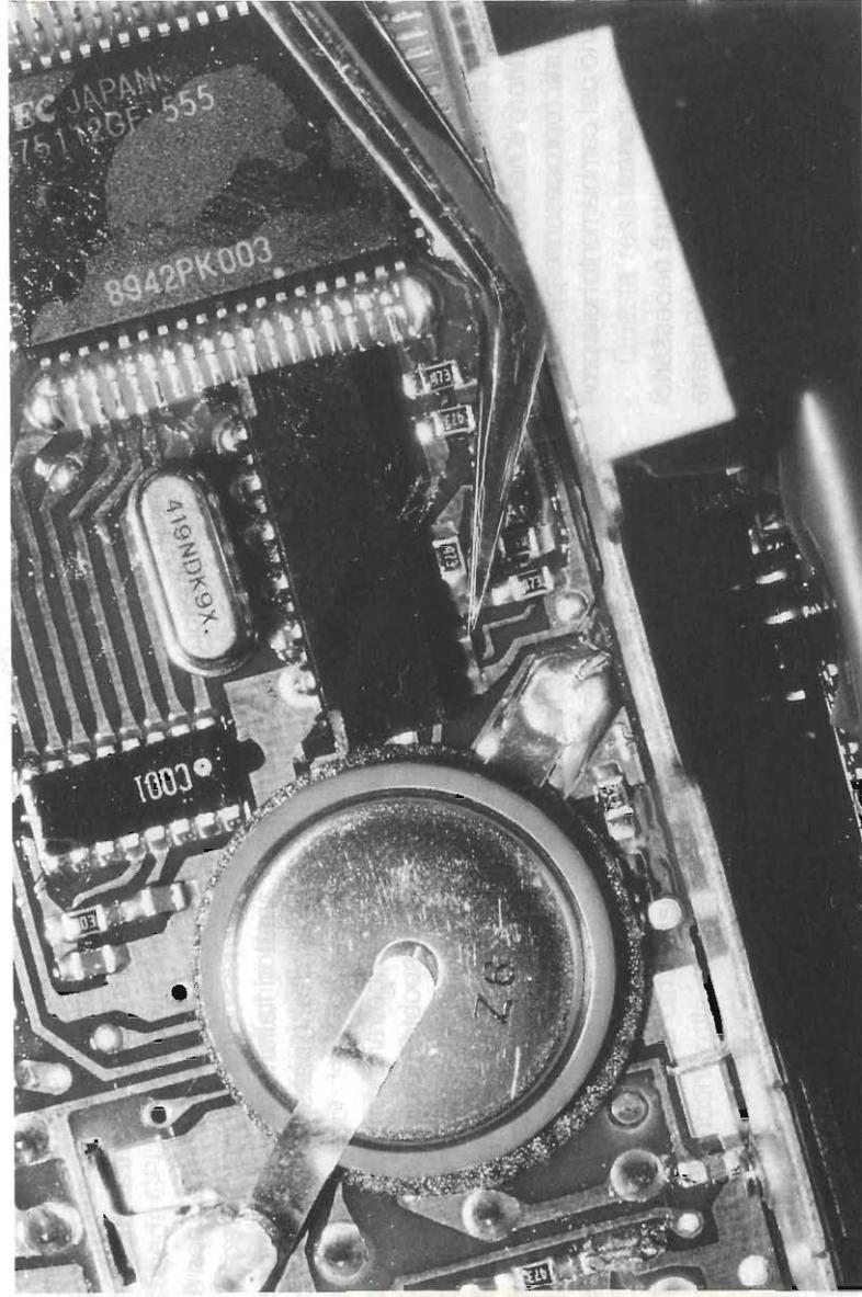
figura 4 - Il Jumper da tagliare (allontanare i due terminali e interporre un pezzetto di materiale isolante per evitare contatti accidentali).
