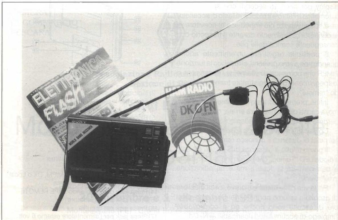
Ad una potenza di uscita massima di 400 mW abbiamo una distorsione del 10%, ma a volume normale la riproduzione è gradevole e il controllo di tono è del tipo a deviatore; su una posizione per il parlato, sull'altra per la musica.
