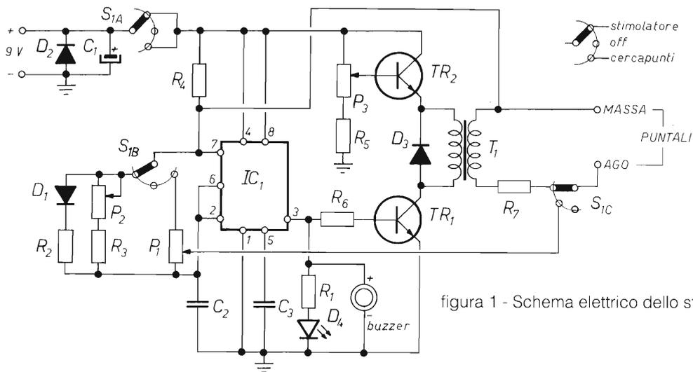
figura 1 - Schema elettrico dello stimolatore.
