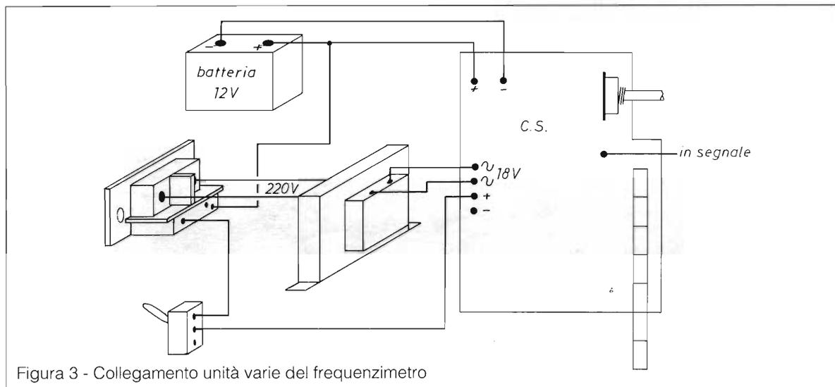
Figura 3 - Collegamento unità varie del frequenzimetro
