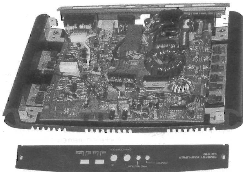
L'analisi approfondita dello stampato, vinta la prima impressione di caotico cablaggio e numerose variazioni circuitali (sicuramente il modello da noi provato era una preserie) colpisce l'osservatore per l'ottima componentistica utilizzata: Gli amplificatori utilizzano come finali potenti mosfet complementari: la circuitazione perfettamente simmetrica e l'attento by-pass capacitivo fa del 410 un ottimo esempio di progettazione.
