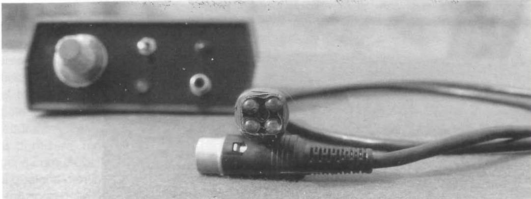
I quattro LED IR che circondano il fototransistor centrale
