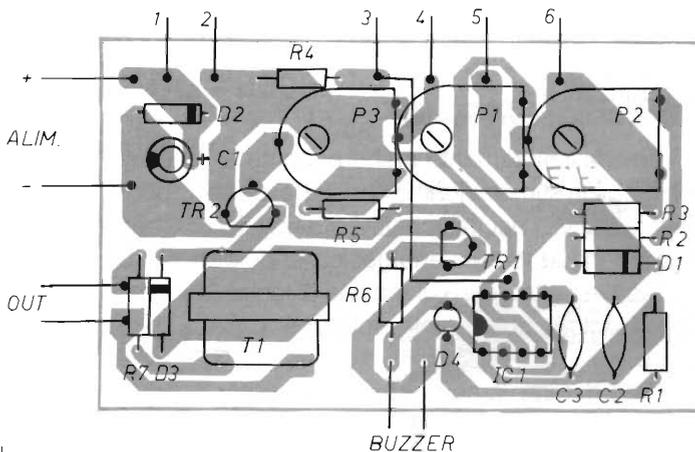
figura 2 - Montaggio componenti.
