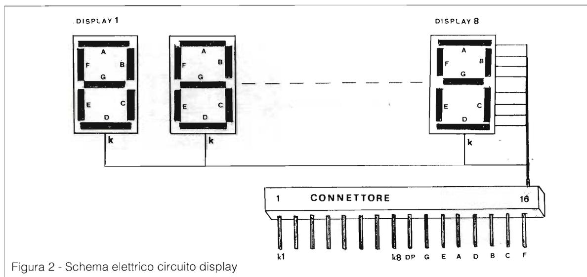
Figura 2 - Schema elettrico circuito display
