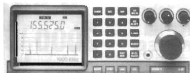
Scanner con analizzatore CRT incorporato.
