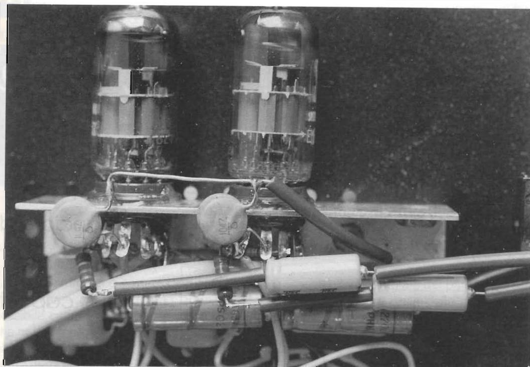
foto 3 - Le valvole montate orrizzontalmente nel mobile RACH 19 da una unità.
