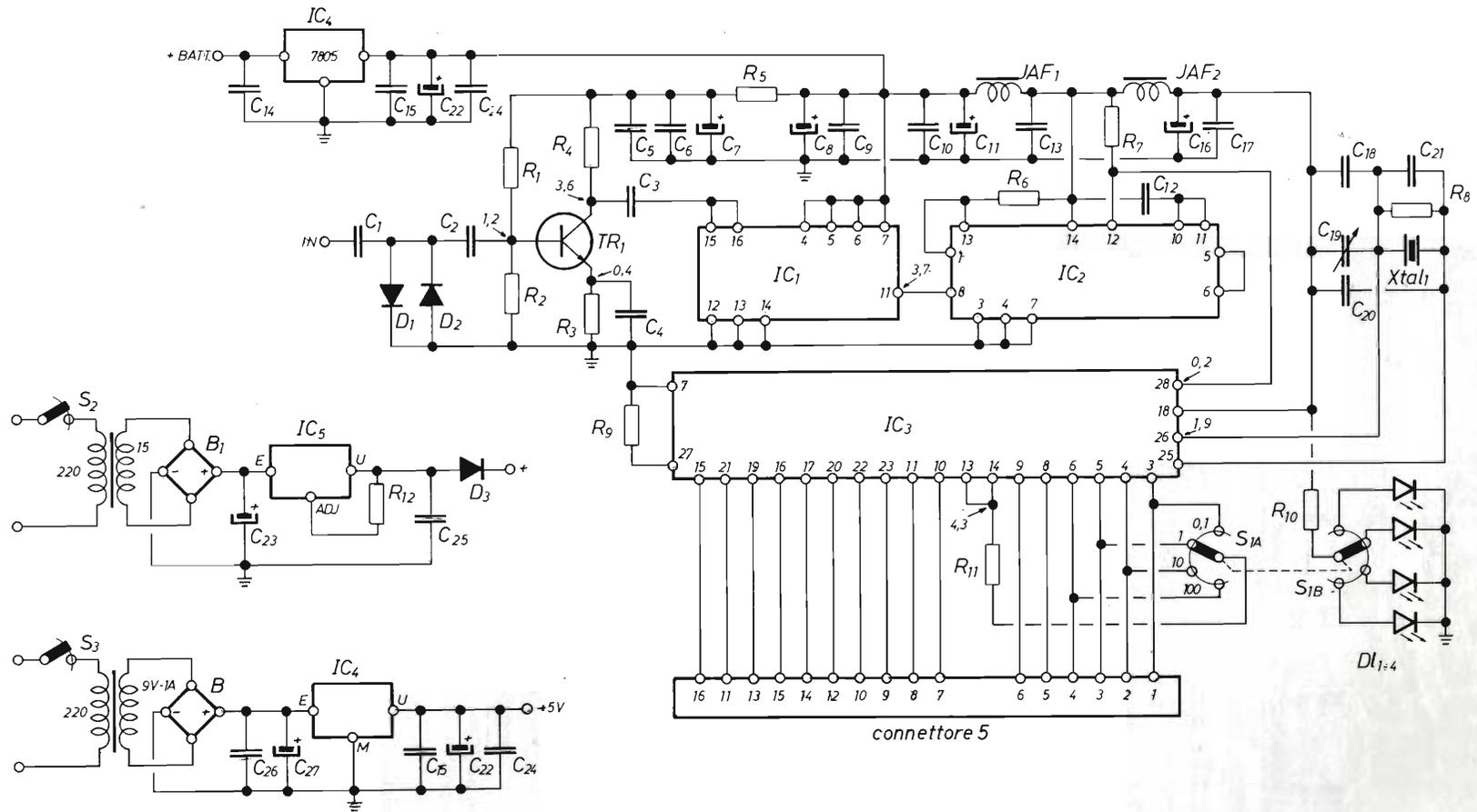
Figura 1 - Schema elettrico del frequenzimetro
