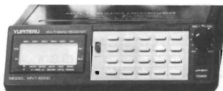
Ricevitore scanner veicolare/base. Riceve
