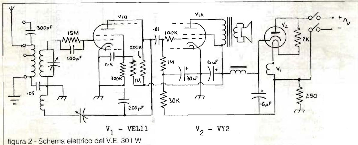
figura 2 - Schema elettrico del V.E. 301 W
