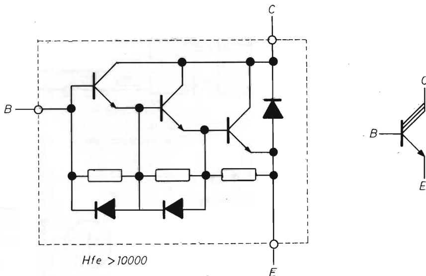
figura 3b - Trinton: schema interno e simbolo
