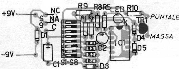
figura 2 - Disposizione componenti.
