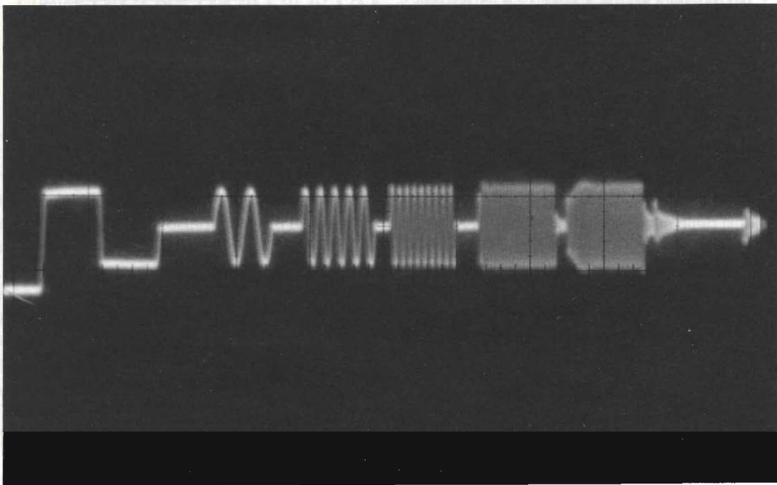
Analisi del pacchetto VITS multiburst. Notare l'ampiezza praticamente uguale dei vari bursts indice di ottima risposta in frequenza del canale video, lineare fino ad oltre 5,8 MHz (Generatore di segnali test Tektronix TSG271, Demodulatore campione Tektronix 1450-2/TDC1, oscilloscopio Hewlett Packard HP 1741A).
