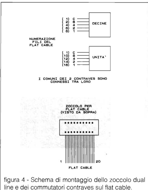
figura 4 - Schema di montaggio dello zoccolo dual line e dei commutatori contraves sul flat cable.
