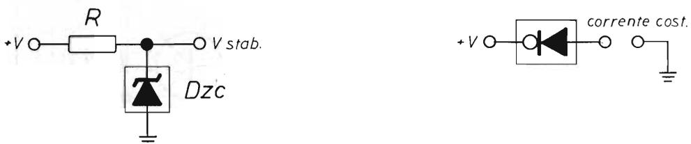
figura 3c - DZC come stabilizzatore compensato in temperatura e come generatore di corrente costante
