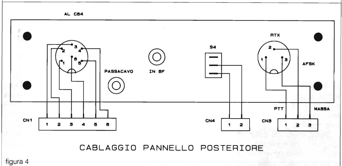
CABLAGGIO PANNELLO POSTERIORE
