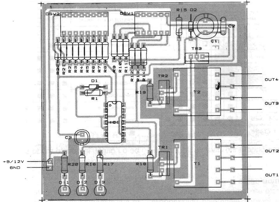
figura 3 - Disposizione componenti
