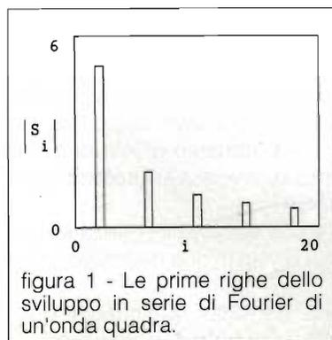
figura 1 - Le prime righe dello sviluppo in serie di Fourier di un'onda quadra.
