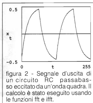
figura 2 - Segnale d'uscita di un circuito RC passabasso eccitato da un'onda quadra. Il calcolo è stato eseguito usando le funzioni fft e ifft.
