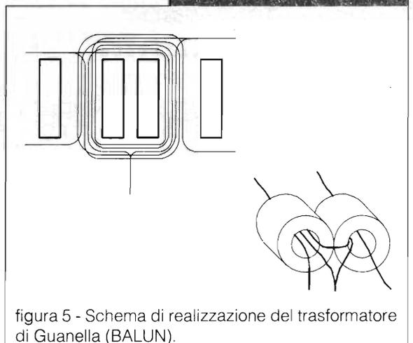
figura 5 - Schema di realizzazione del trasformatore di Guanella (BALUN).
