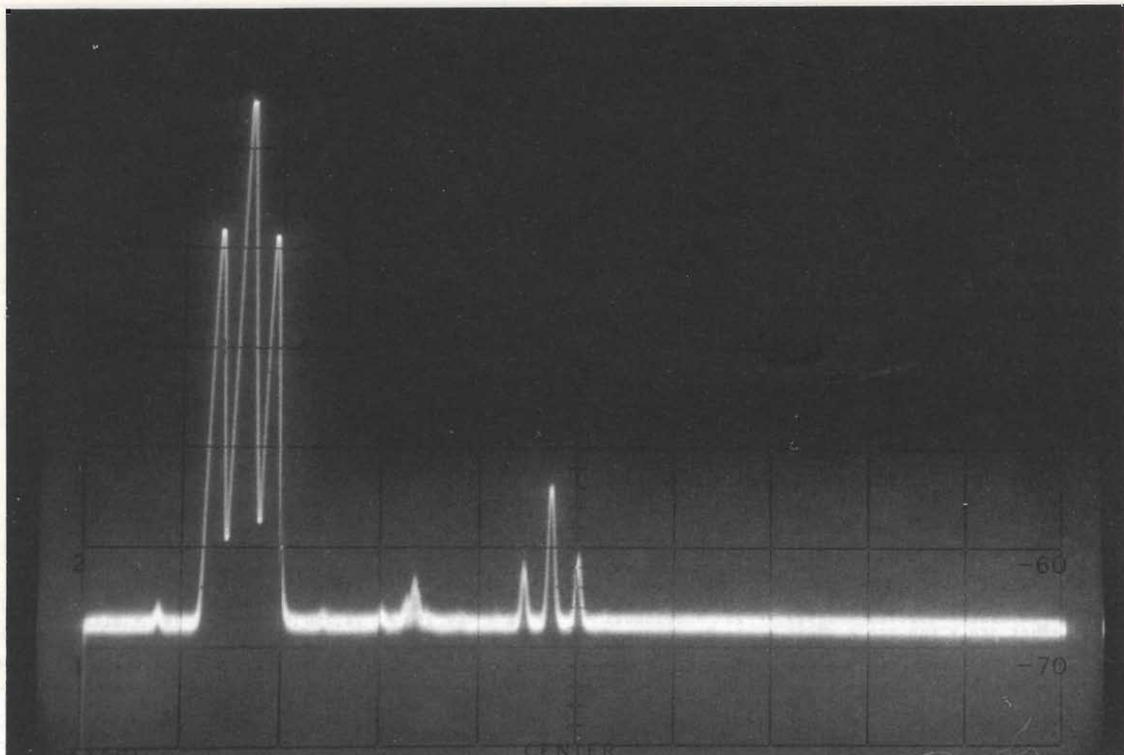
Analisi di spettro del contenuto armonico del segnale generato dall'oscillatore. Notare l'assenza di segnali spuri e il basso livello delle componenti armoniche presenti in uscita (analizzatore di spettro Hewlett Packard HP8559A).
