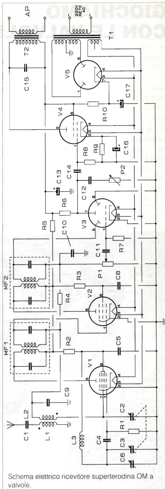
Schema elettrico ricevitore supereterodina OM a valvole.
