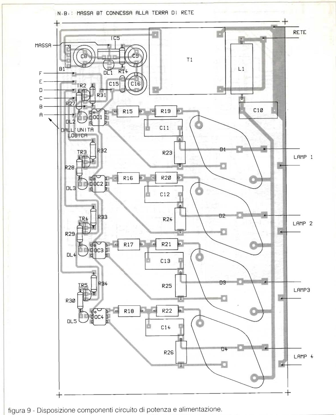
fusibili delle uscite, da porre sul pannello frontale (anche i fusibili, per comodità). Il disegno mostra anche le connessioni di terra di rete, assolutamente necessarie per avere un generatore a norma di sicurezza. Ovviamente dovrà essere connesso ad impianto di alimentazione dotato di terra e salvavita.
