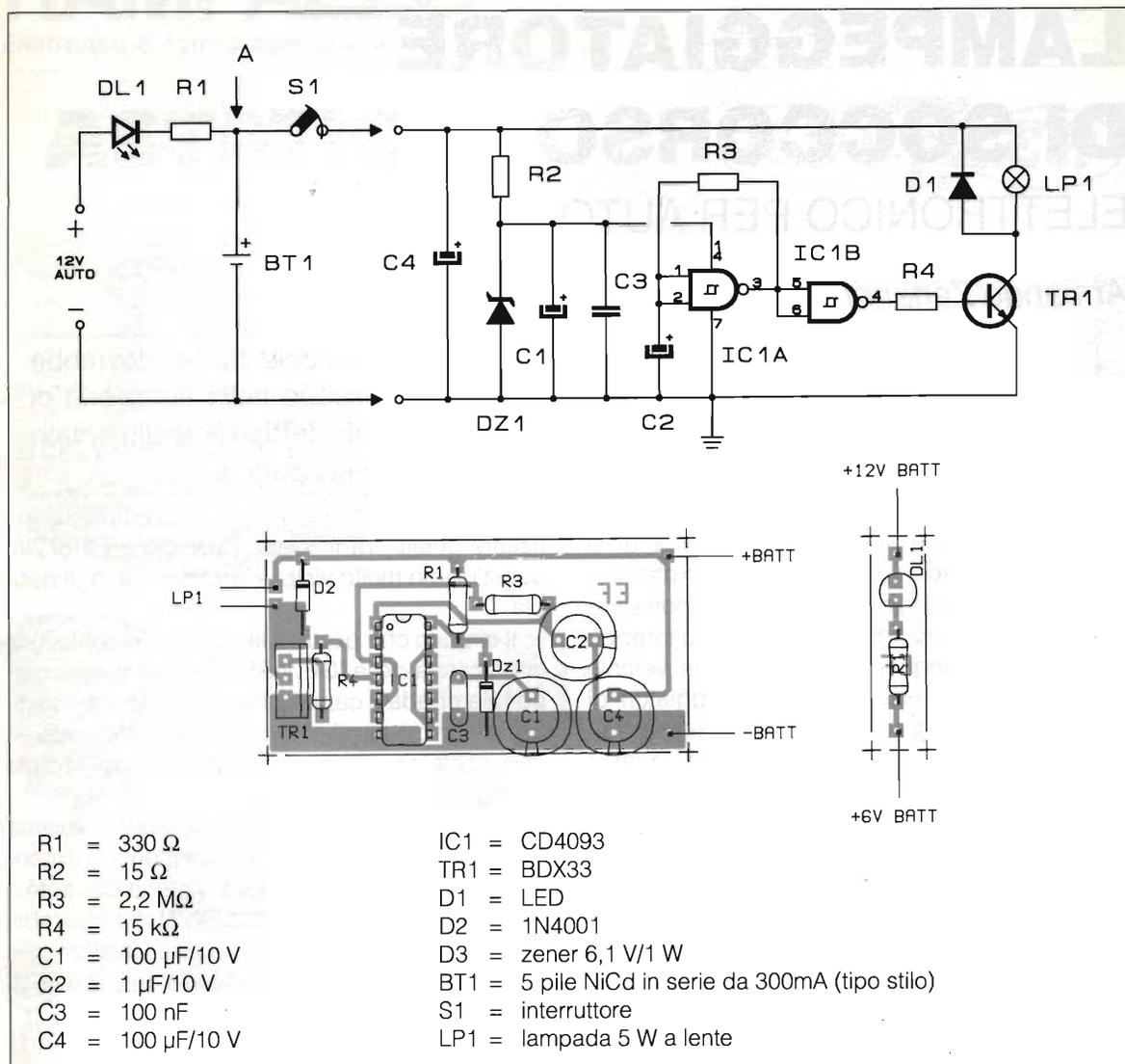
che permette la carica degli accumulatori nikel-cadmio, tipo stilo, per un totale di 6 volt, abbassando il valore di tensione della batteria e limitandone la corrente per non distruggere le pile, ed un altro blocco circuitale in cui è presente l'oscillatore di potenza che pilota la lampadina. Questa dovrà essere scelta tra quelle a 6 volt con maggiore efficienza e illuminazione omnidirezionale; sono quindi da scartare i tipi con lente per fascio spot.
