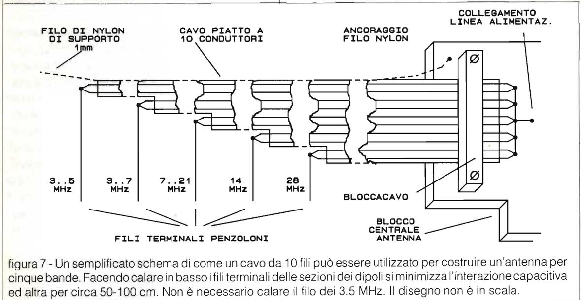
figura 7 - Un semplificato schema di come un cavo da 10 fili può essere utilizzato per costruire un'antenna per cinque bande. Facendo calare in basso i fili terminali delle sezioni dei dipoli si minimizza l'interazione capacitiva ed altra per circa 50-100 cm. Non è necessario calare il filo dei 3.5 MHz. Il disegno non è in scala.
