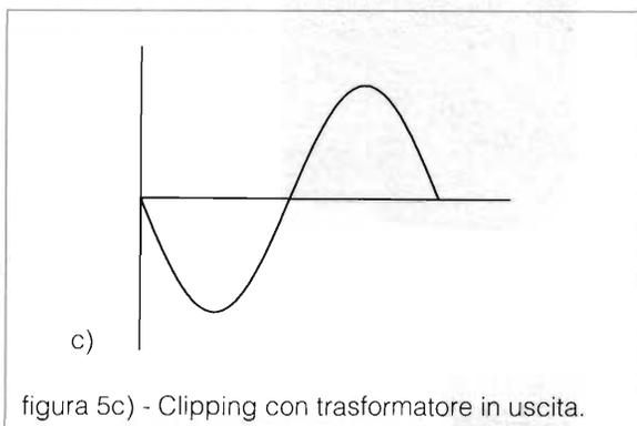
figura 5c) - Clipping con trasformatore in uscita.
