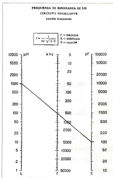
Si vuole determinare il valore della frequenza di risonanza  $F_0$ .
