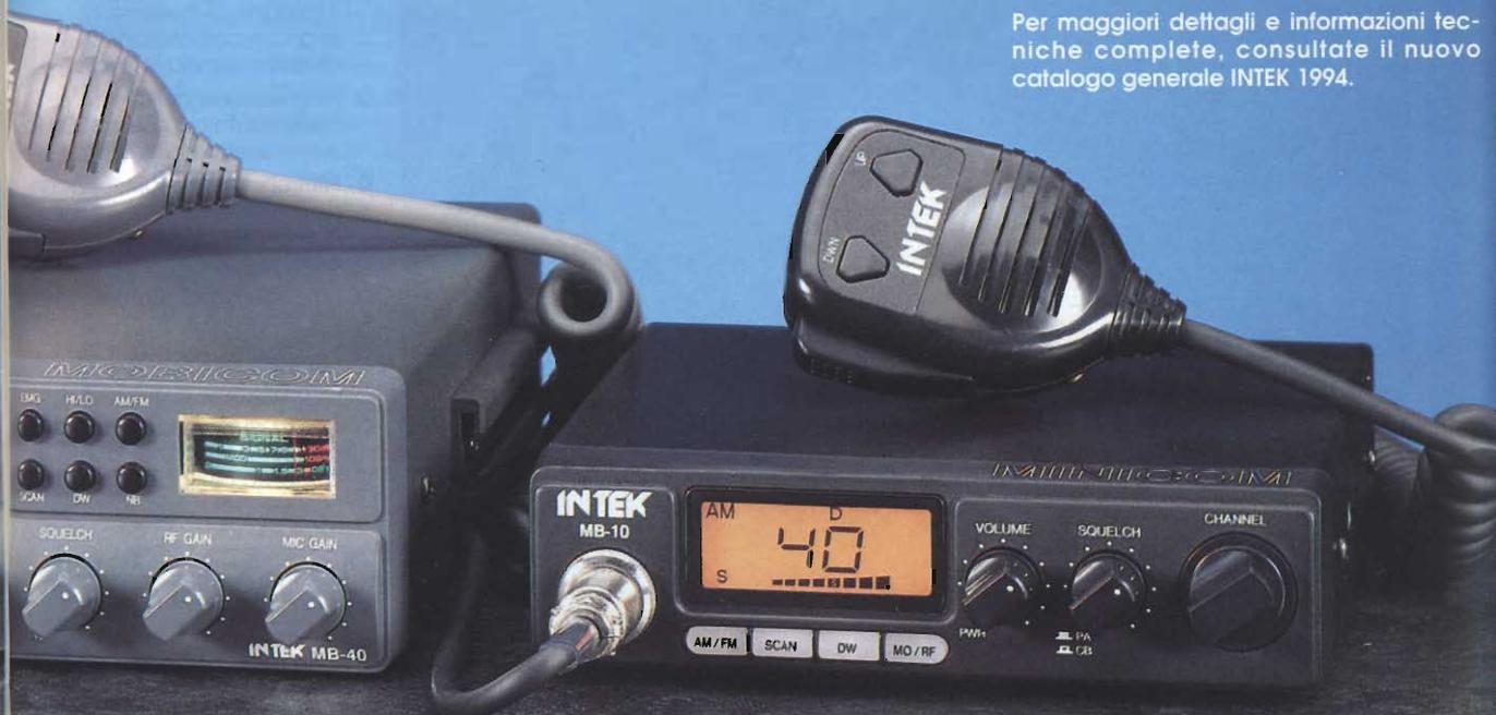
per potenza RF e modulazione. Inoltre potenza RF regolabile, selezione canali da microfono Up/Down o da commutatore, filtro a quarzo, mixer bilanciato a FET. Stadio finale tipo SSB da 15 Watt input (\*) e modulatore potenziato.
