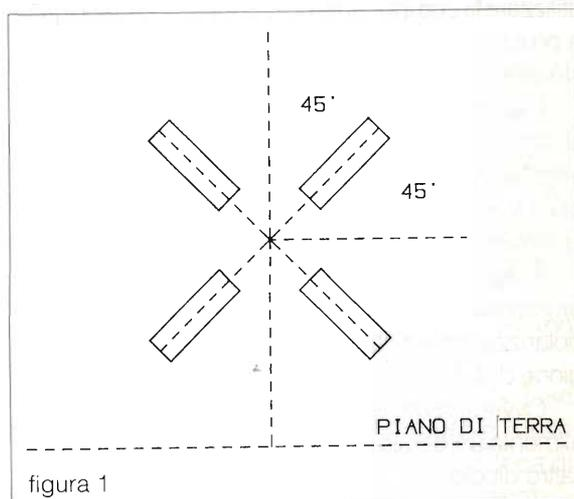
Agli effetti della ricezione di un'onda elettromagnetica irradiata con polarizzazione ellittica essa può essere scomposta (per il teorema di reciprocità) in due componenti, una lineare orizzontale e l'altra lineare verticale, rispetto al solito piano di terra.
