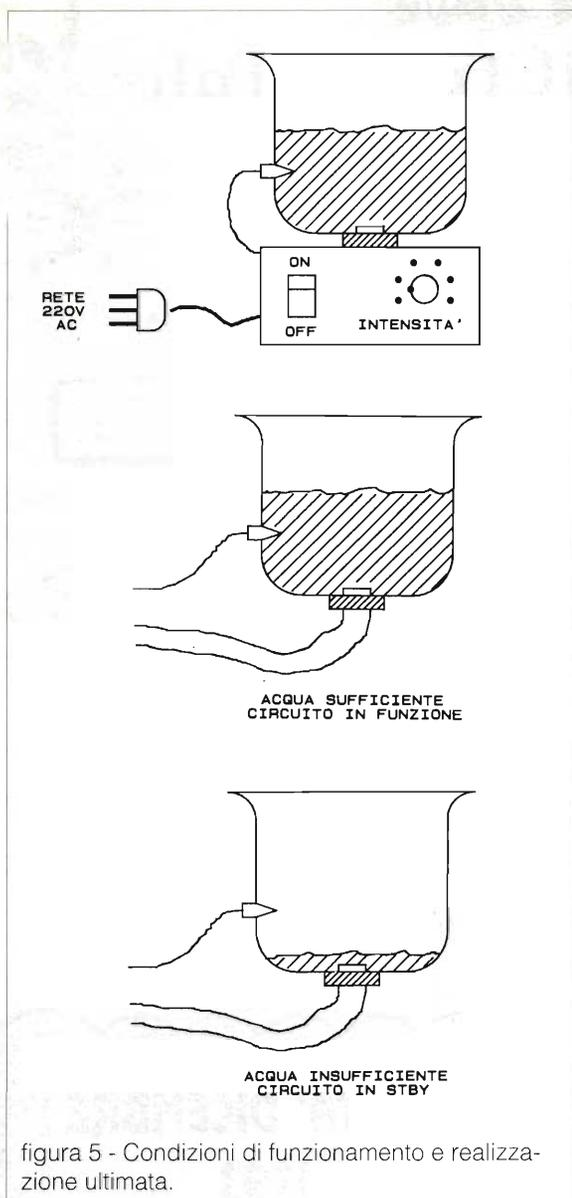
figura 5 - Condizioni di funzionamento e realizzazione ultimata.
