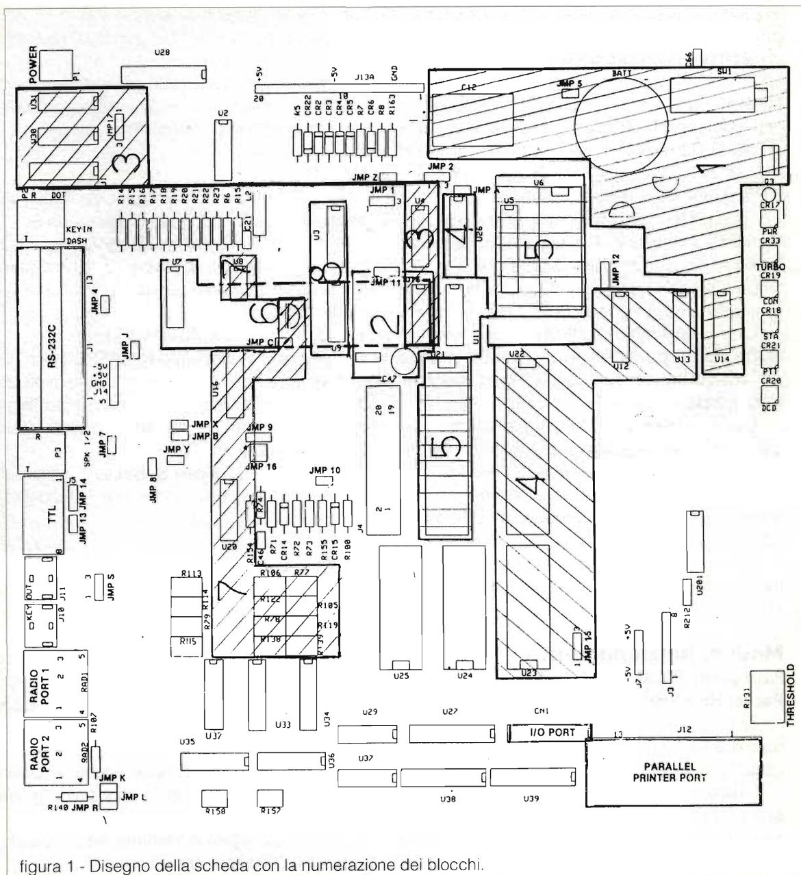
figura 1 - Disegno della scheda con la numerazione dei blocchi.
