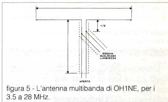
figura 5 - L'antenna multibanda di OH1NE, per i 3,5 a 28 MHz.
