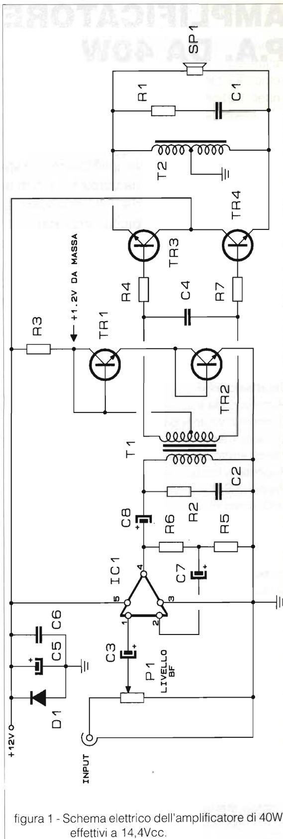
figura 1 - Schema elettrico dell'amplificatore di 40W effettivi a 14,4Vcc.
