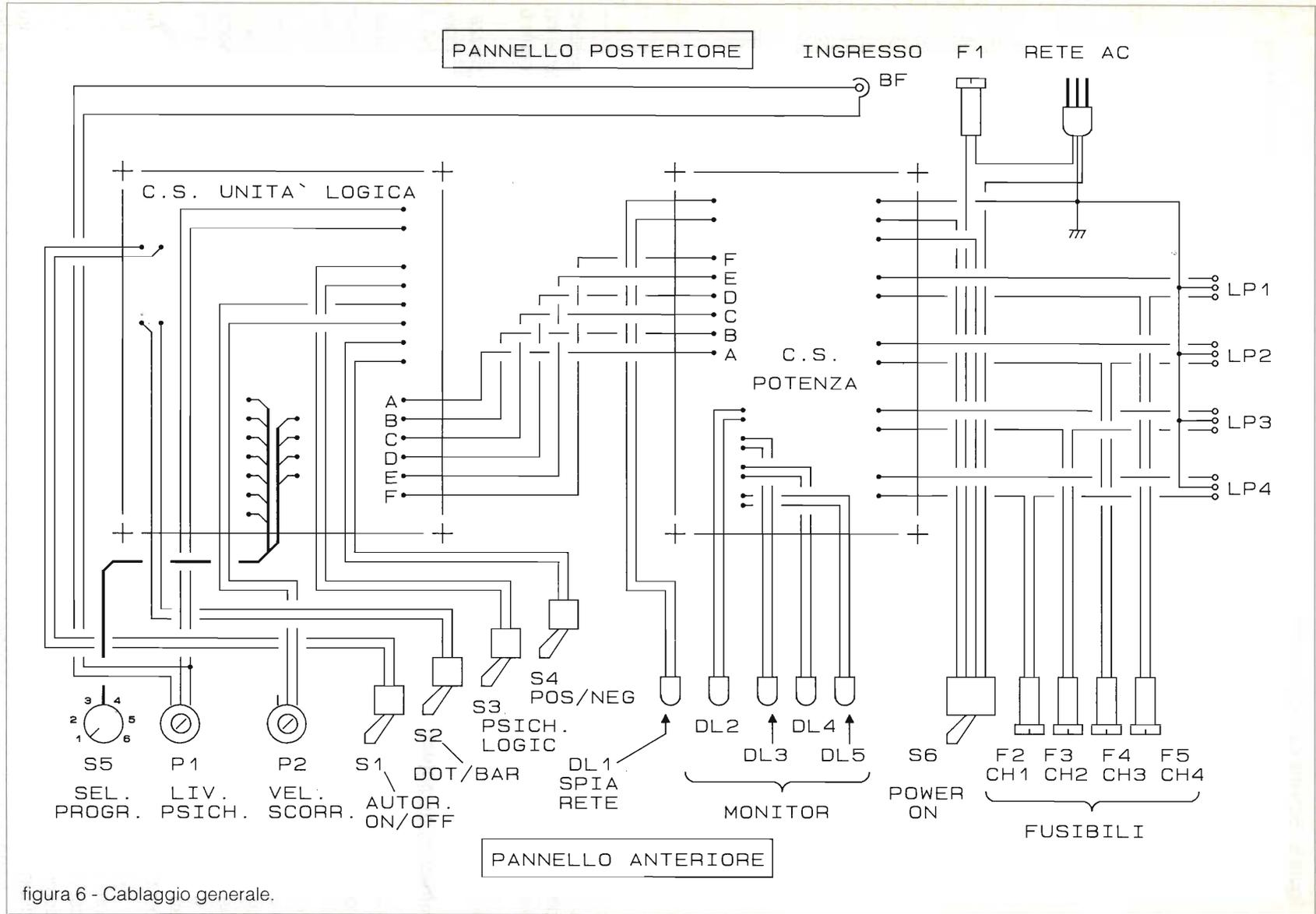
figura 6 - Cablaggio generale.
