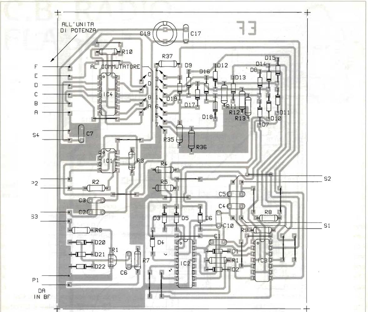
figura 7 - Disposizione componenti unità controllo logica.
