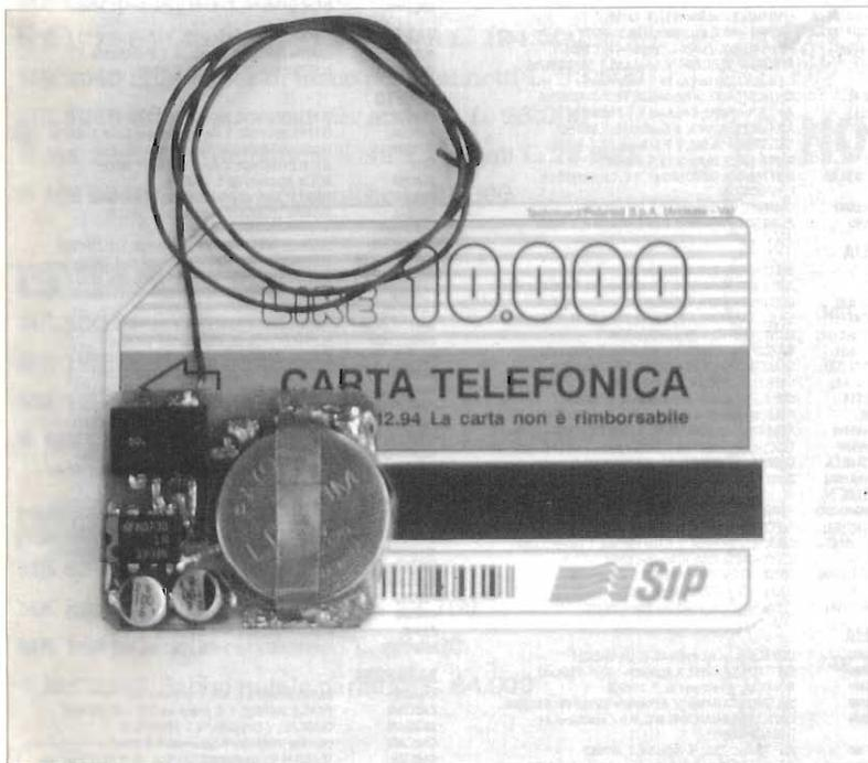
Foto 1 - Un radiolocalizzatore di piccole dimensioni operante in VHF, 1 Km massimo di portata, autonomia circa 3 giorni. Il circuito differisce da quello descritto solo per l'impiego di un modulo trasmettente realizzato in "chip". Questo componente non è in commercio, è stato realizzato per l'autore, per impieghi speciali.
