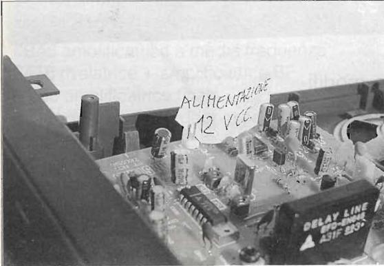
Foto 2 - Il connettore dell'alimentazione (che verrà realizzata a parte).
