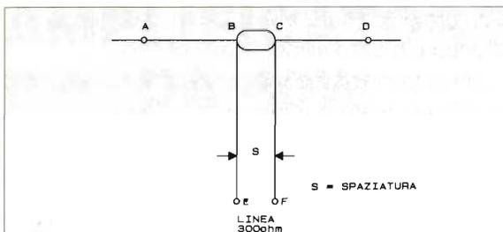
figura 2 - L'antenna doublet. Si può rilevare l'inerte bilanciamento. I rami orizzontali sono uguali in lunghezza, come pure lo sono quelli verticali di alimentazione.
