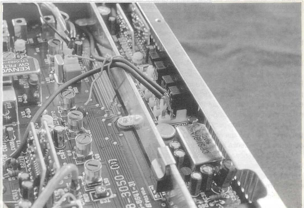
figura 6 - Particolare del collegamento dei due cavetti schermati sul connettore ACC4.
