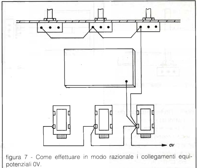
figura 7 - Come effettuare in modo razionale i collegamenti equipotenziiali 0V.
