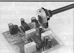
Serve a ricevere e convertire in segnali audio gli impulsi a RAGGI INFRAROSSI trasmessi in PWM dall'RS 348. L'alimentazione deve essere fornita tramite una batteria da 9 V per radioline e l'assorbimento massimo è di circa 80 mA. Per l'ascolto occorre collegare all'uscita una qualsiasi cuffia con impedenza compresa tra 4 e 100 Ohm. Il dispositivo è dotato di controllo volume e può essere alloggiato nel contenitore plastico LP 462 il quale è completo di vano batterie.
