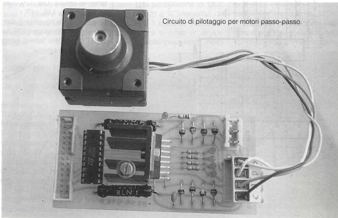
Circuito di pilotaggio per motori passo-passo.
