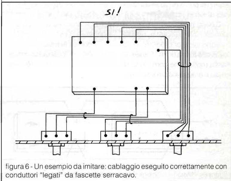
figura 6 - Un esempio da imitare: cablaggio eseguito correttamente con conduttori "legati" da fascette serracavo.
