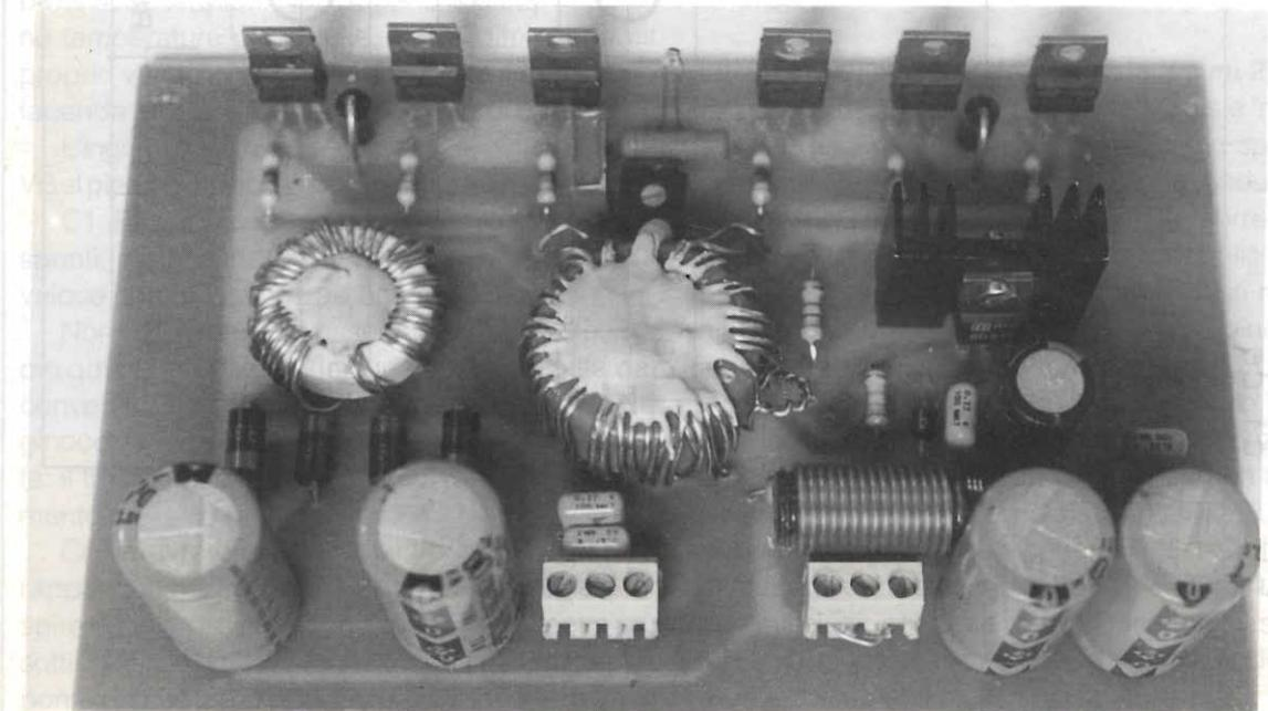
Inverter montato - Si osservino i transistori di potenza e l'NTC di protezione termica.
