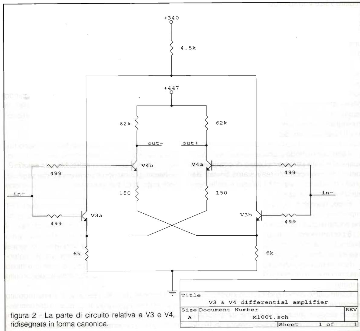
figura 2 - La parte di circuito relativa a V3 e V4, ridisegnata in forma canonica.
