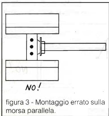
figura 3 - Montaggio errato sulla morsa parallela.
