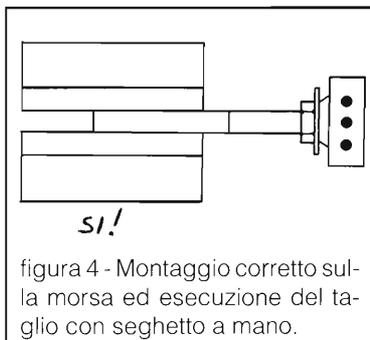
figura 4 - Montaggio corretto sulla morsa ed esecuzione del taglio con seghetto a mano.
