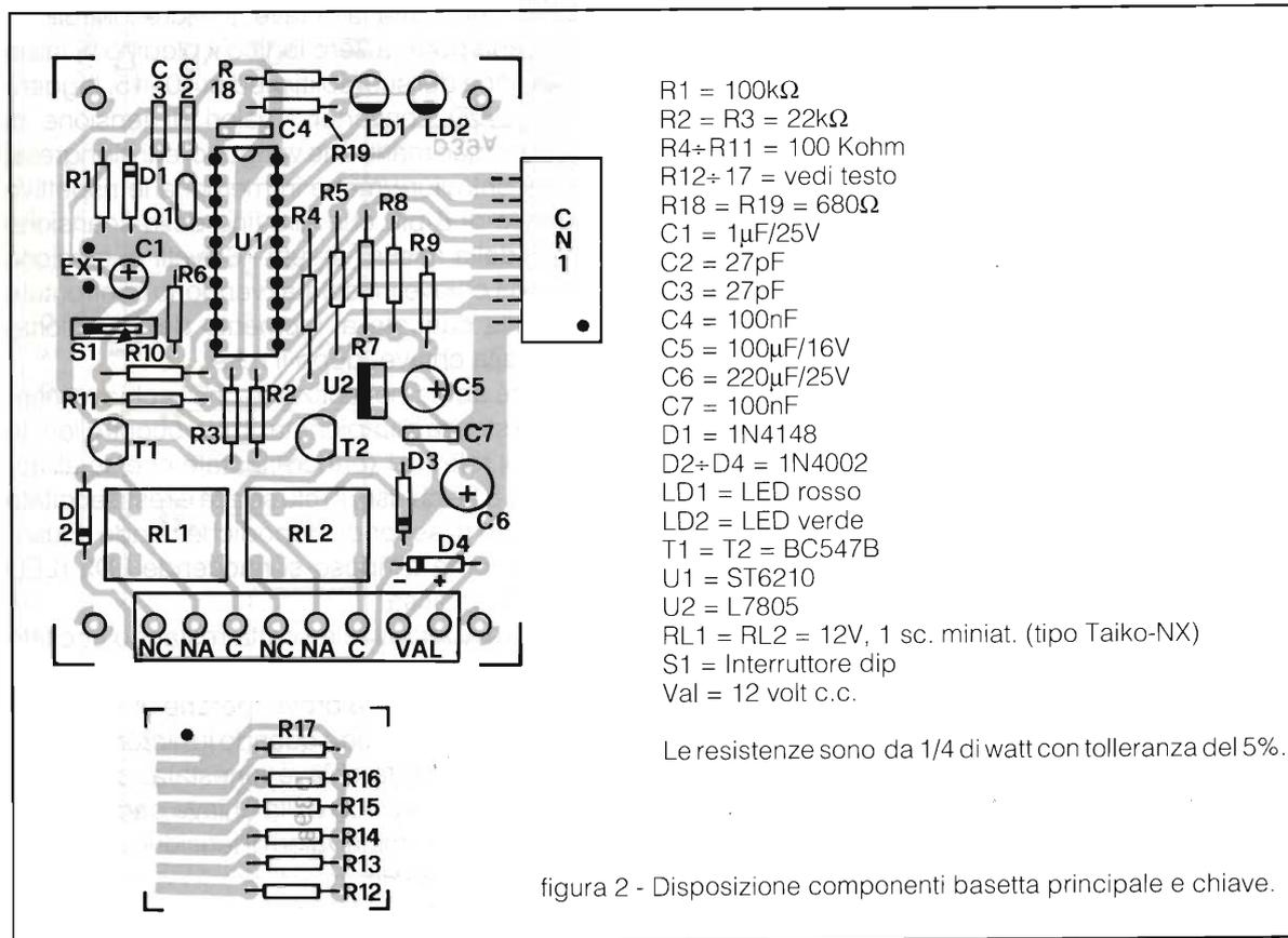
figura 2 - Disposizione componenti basetta principale e chiave.
