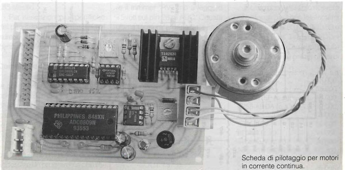
Scheda di pilotaggio per motori in corrente continua.
