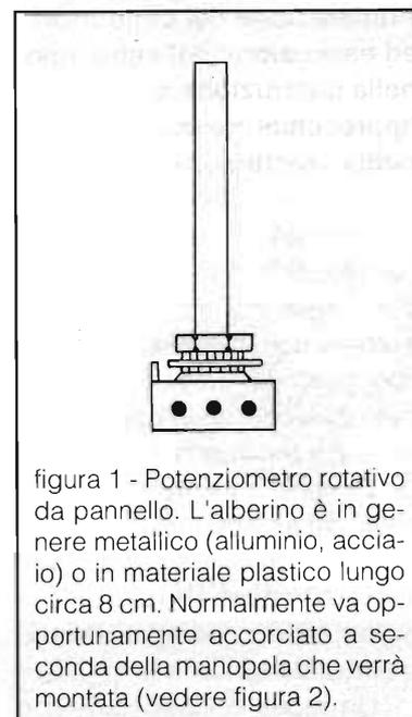
figura 1 - Potenziometro rotativo da pannello. L'alberino è in genere metallico (alluminio, acciaio) o in materiale plastico lungo circa 8 cm. Normalmente va opportunamente accorciato a seconda della manopola che verrà montata (vedere figura 2).
