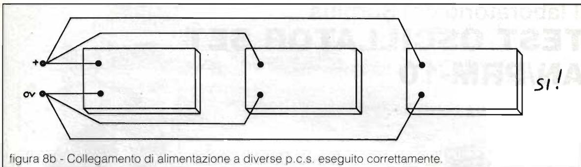
figura 8b - Collegamento di alimentazione a diverse p.c.s. eseguito correttamente.
