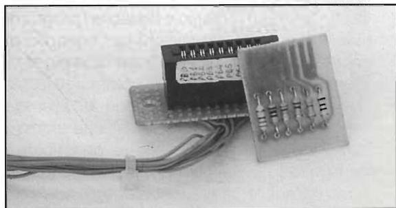
dimenticate di tenere il lato rame della basettina rivolto ai contatti del connettore ad inserzione diretta effettivamente collegati: tale connettore infatti ha due file e a noi ne serve una sola; se le piste toccano i contatti della fila non usata il circuito non funziona, e ve ne potete accorgere perché anche innestando la chiave non si spengono i LED, che continuano a lampeggiare.
