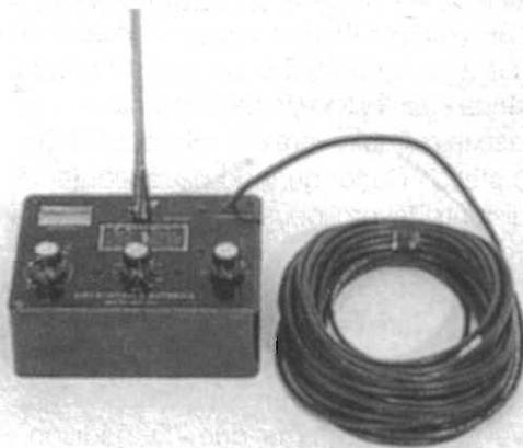
trovano tre manopole per la regolazione dei circuiti di accordo, uno strumento di lettura e l'innesco dove applicare lo stilo telescopico in acciaio alto 140 cm.
