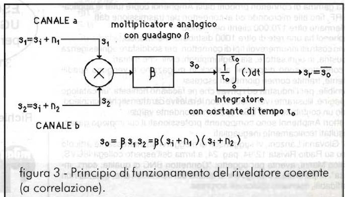
figura 3 - Principio di funzionamento del rivelatore coerente (a correlazione).
