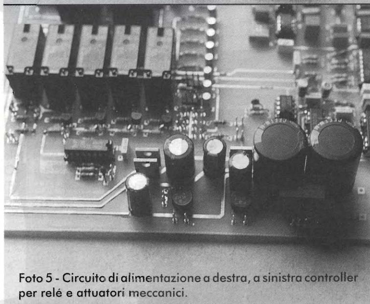
Foto 5 - Circuito di alimentazione a destra, a sinistra controller per relé e attuatori meccanici.
