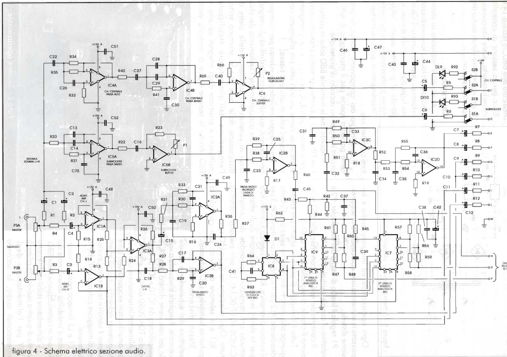
figura 4 - Schema elettrico sezione audio.
