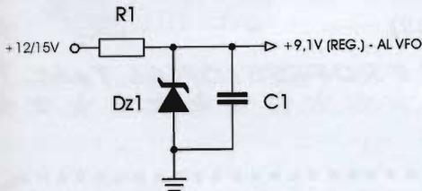
figura 8 - Stabilizzatore per VFO a FET con VARICAP.
