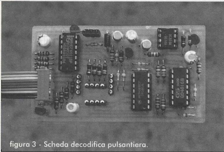
te 2, IC1 a vedrebbe ancora la sua riga passare ad un livello basso, abilitando, con la sua uscita, IC2a (pin 6), la quale, però, non vedendo il livello alto dell'altro gate (pin 5) essendo la colonna non quella giusta programmata, fallisce l'impostazione (e resetta il tutto come vedremo più avanti).
