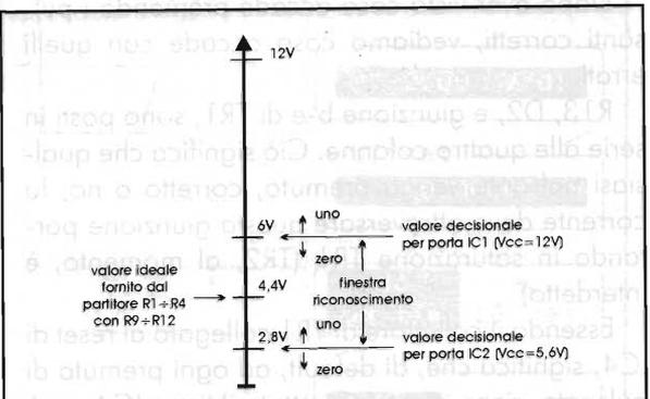
figura 8 - Rappresentazione decodifica pulsantiera. Il valore di circa 4,4V, che si forma nel punto di unione righe/colonne dove sono collegate le porte IC1.. e IC2.. premendo un pulsante, si trova al centro della finestra formata dal valore decisionale di IC1 e quello di IC2. Alla premuta di un tasto facente parte del codice, ci saranno solo due porte a trovarsi in questa condizione, identificando il pulsante. Il valore di 4,4V non è critico, ma può, in pratica, essere tra i 3,5 e 5,2V.
