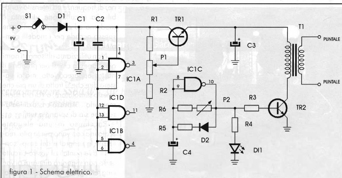
figura 1 - Schema elettrico.
