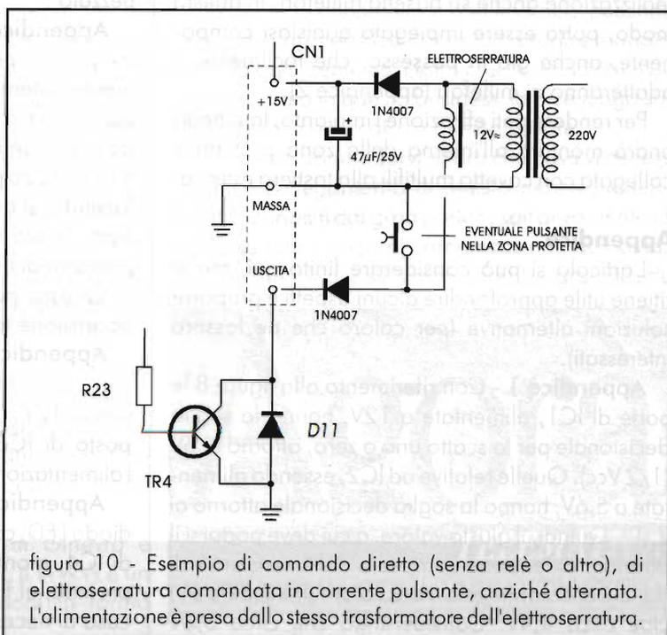
figura 10 - Esempio di comando diretto (senza relè o altro), di elettroserratura comandata in corrente pulsante, anziché alternata. L'alimentazione è presa dallo stesso trasformatore dell'elettroserratura.
