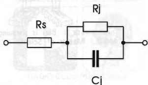
figura 4 - Circuito equivalente del diodo a capacità variabile.
