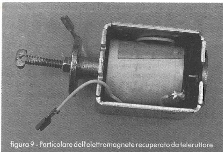
figura 9 - Particolare dell'elettromagnete recuperato da teleruttore.
