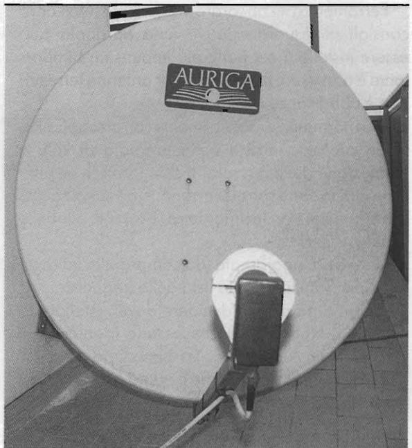
Foto 1 - Parabola in primo piano, puntata su ASTRA.
