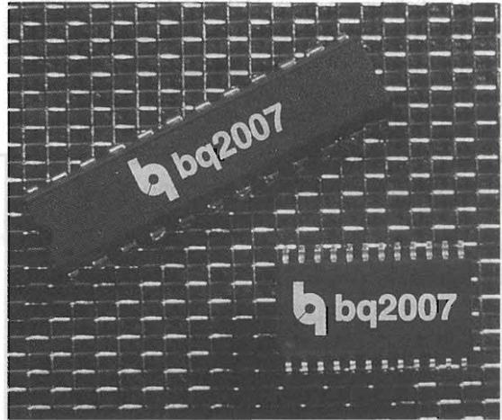
Benchmark Microelectronics ha di recente annunciato l'introduzione di un nuovo circuito integrato per la carica rapida delle batterie, che unisce a sofisticati controlli per la verifica della carica la possibilità di interfacciarsi direttamente con visualizzatori LED e display a cristalli liquidi.
