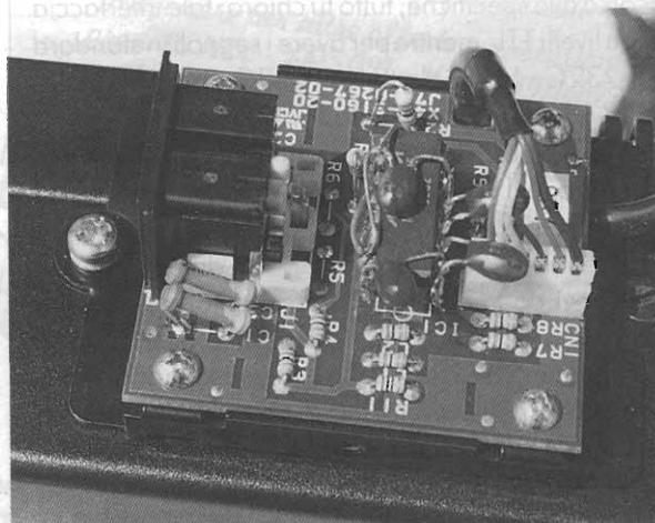
Foto 5 - Interno dell' IF-10D modificata, sul fianco dell'RTX: viti di fissaggio max 8mm!
