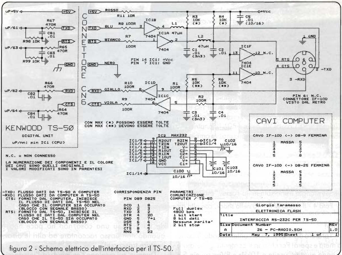
figura 2 - Schema elettrico dell'interfaccia per il TS-50.
