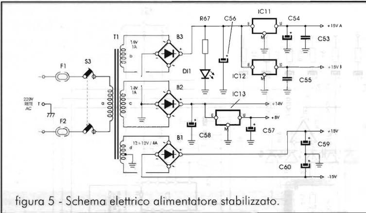
figura 5 - Schema elettrico alimentatore stabilizzato.
