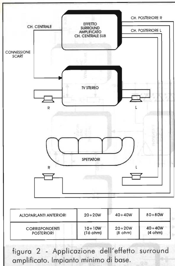
figura 2 - Applicazione dell'effetto surround amplificato. Impianto minimo di base.
