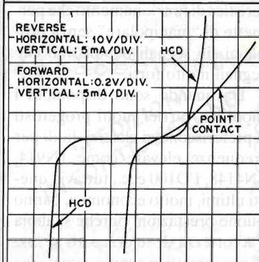
figura 2 - Confronto delle caratteristiche diretta (forward) e inversa (reverse) di un diodo HCD e un diodo a punta di contatto.
