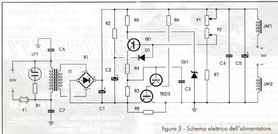
figura 3 - Schema elettrico dell'alimentatore.
