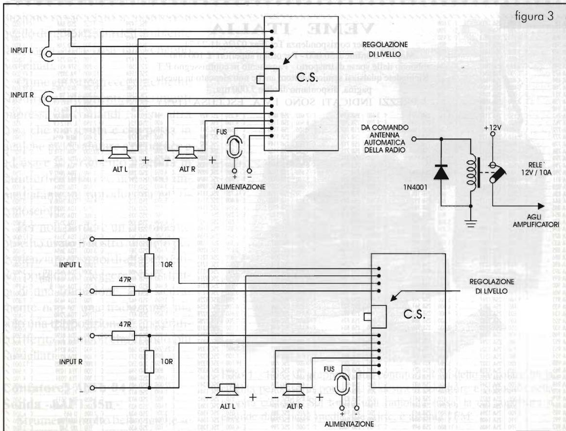
sono relativi al muting, non utilizzato nel nostro progetto. Nel 7241, al contrario del 7240, sono necessarie le resistenze R1, R2 tra pin 2 dell'integrato e il positivo. Se i Lettori preferissero per migliore reperibilità utilizzare dei 7240, di potenza leggermente inferiore, basterà omettere R1, R2, lasciando isolata la connessione.
