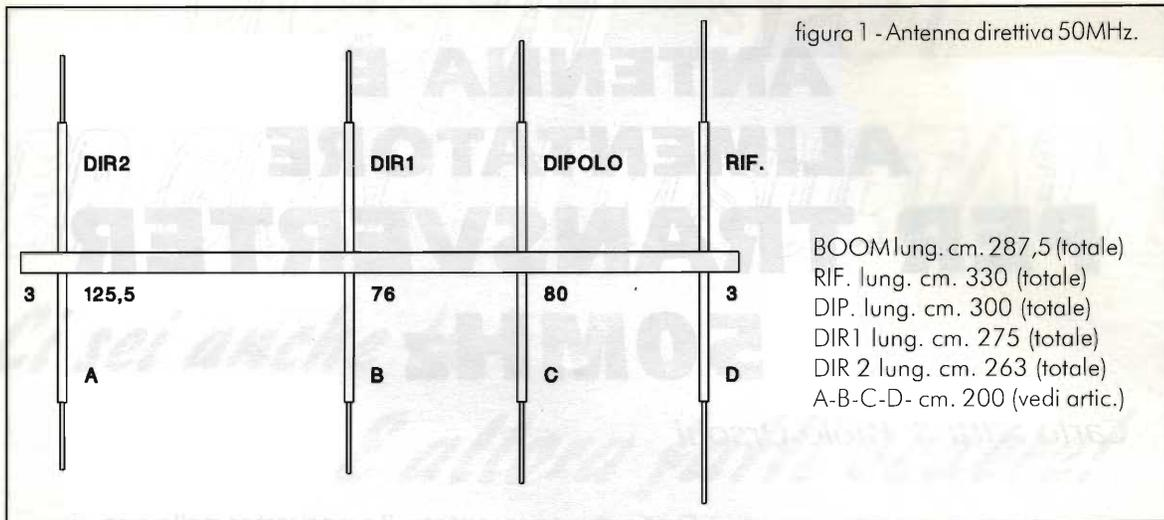
derazione un sistema di adattamento a gamma match, ciò non toglie che si possano sperimentare anche altri tipi di accordi. Tale sistema infatti offre una soluzione per una costruzione senza troppe difficoltà, essendo il dipolo fisicamente collegato al boom, evita soluzioni di isolamento a volte laboriose; sono a massa anche tutti gli altri elementi.
