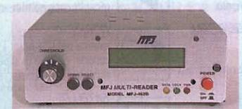
**MFJ 462** Questo nuovo MULTI READER MFJ vi permette di decodificare i segnali ricevuti in HF le modalità di ricezione selezionabili da menù operativo sono RTTY, ASCII, CW e AMTOR che servono per il traffico commerciale, militare, diplomatico, meteorologico, aeronautico, marittimo e radioamatore. Presa parallela per una stampante, alimentazione 12 VDC.
