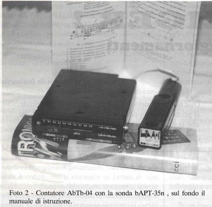
Foto 2 - Contatore AbTb-04 con la sonda bAPT-35n, sul fondo il manuale di istruzioni.
