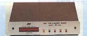
**MFJ 1274CX** È il classico TNC-2 della TAPR identico al modello MFJ 1270 ma include di serie un indicatore di precisione a 20 LED per la sintonia rapida del traffico packet HF. Disponibile il modello CTX per il traffico velocizzato a 2400 baud.
