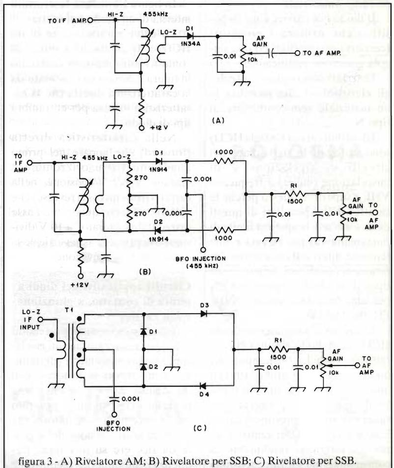
figura 3 - A) Rivelatore AM; B) Rivelatore per SSB; C) Rivelatore per SSB.
