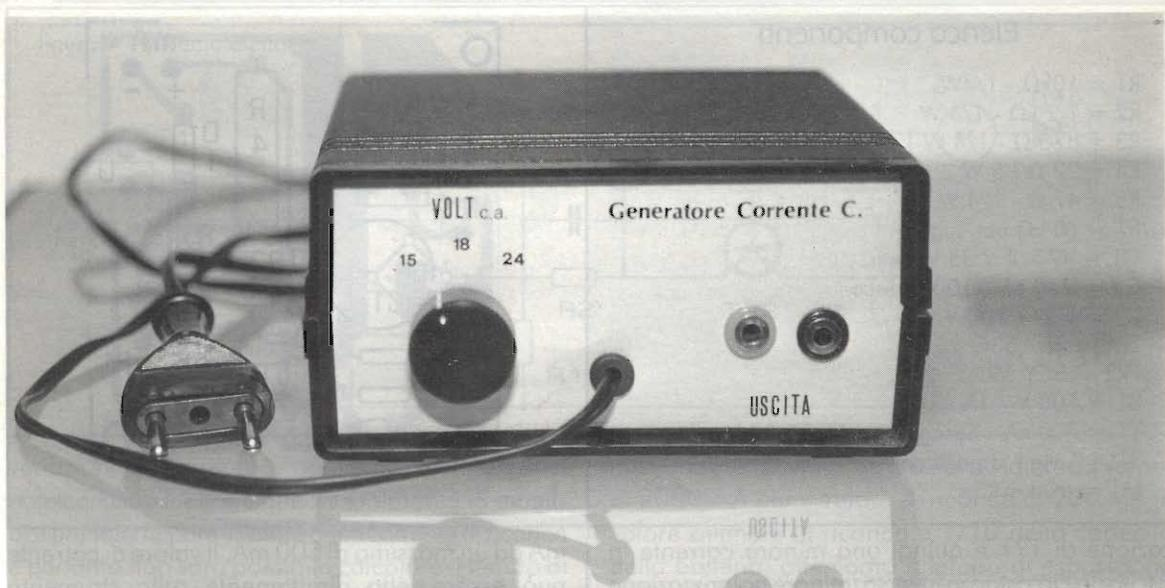
trasformatore di rete T1. Questi deve essere un componente con secondario a prese multiple. Il componente usato è un modello HT 36400 700 mA e presenta ben 8 combinazioni di tensioni d'uscita. Per il nostro scopo ho utilizzato le sole tensioni di 15-18-24 Vc.a. che, raddrizzate, a
