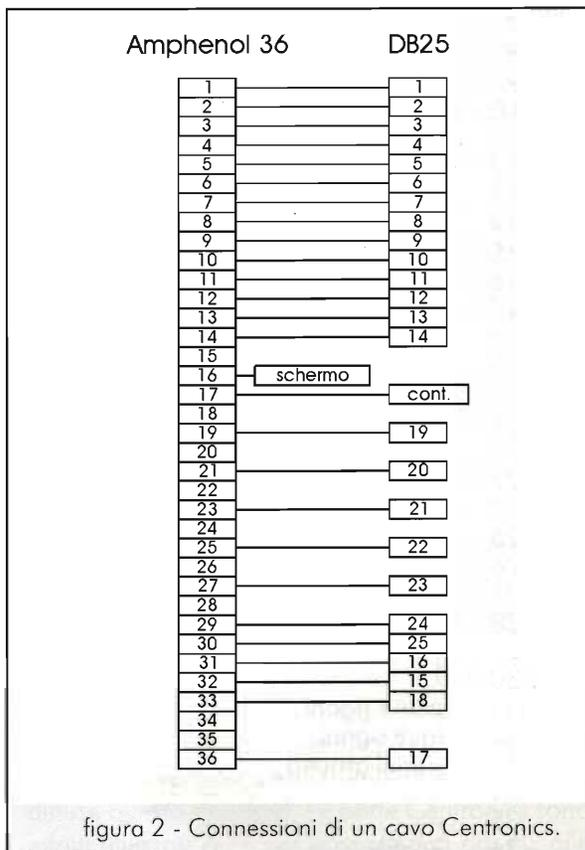
figura 2 - Connessioni di un cavo Centronics.
