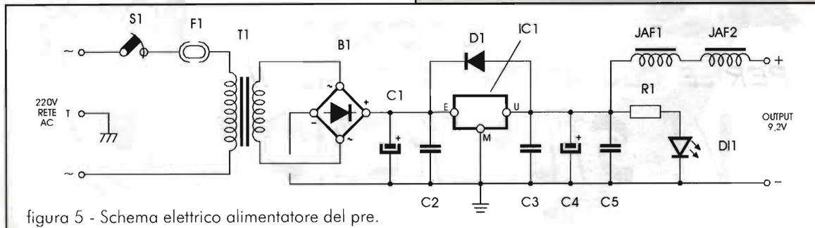
figura 5 - Schema elettrico alimentatore del pre.
