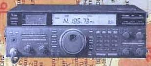
**IC 736** - Rx: 500kHz/30MHz - Tx: SSB-CW-AM-FM fino a 100W RF a Mosfet, alta purezza spettrale, selettore automatico d'antenne
