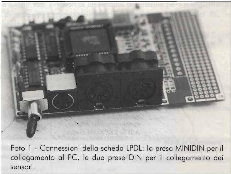
Foto 1 - Connessioni della scheda LPDL: la presa MINIDIN per il collegamento al PC, le due prese DIN per il collegamento dei sensori.
