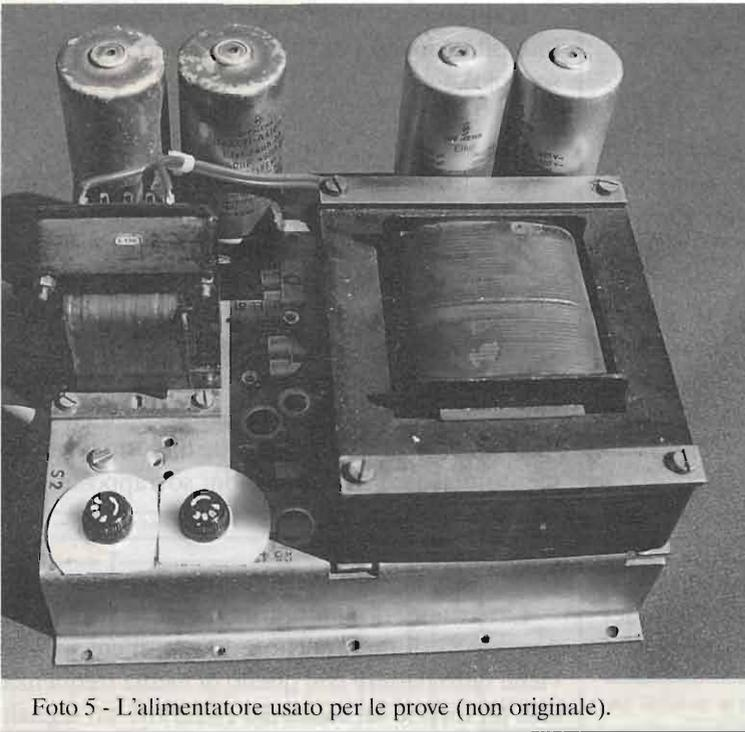
Foto 5 - L'alimentatore usato per le prove (non originale).
