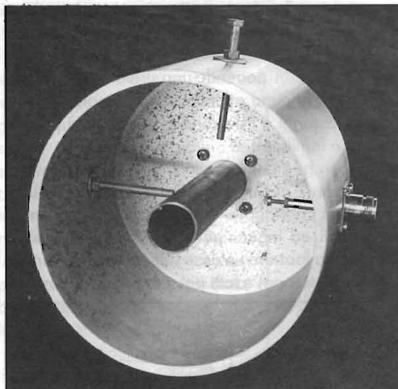
figura 7 - Illuminatore a doppia polarità (foto).
