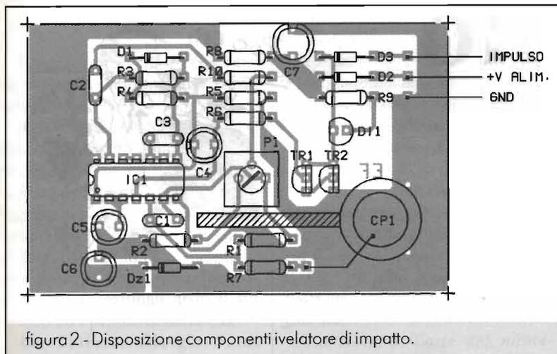
figura 2 - Disposizione componenti rivelatore di impatto.
