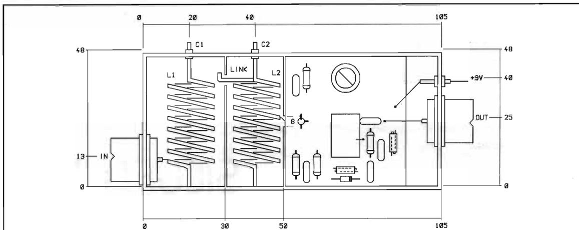
figura 3 - Misure e cablaggio del pre 144 MHz.
