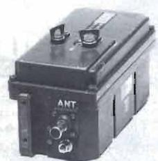
Potenza 50 W circa, frequenza 26÷70 MHz. Molto interessante la meccanica con 2 motorini a 24 Vdc, ingranaggi, relè, ecc. Connettori d'uscita BNC femmina. Dim. cm 10x10x22, peso Kg 2,7. **L. 35.000**
