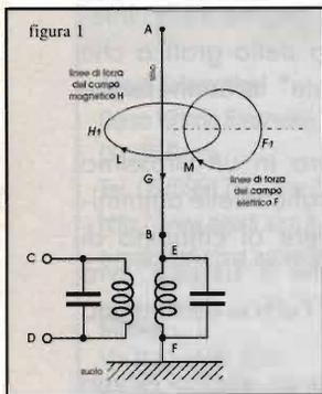
Nella figura 1 è disegnata un'antenna verticale, il cui stilo A-B s'intende lungo mezz'onda (rispetto alla frequenza cui esso viene alimentato, frequenza stessa che viene applicata fra i due morsetti d'entrata C-D).
