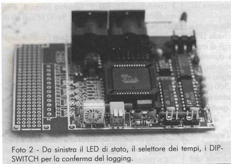
Foto 2 - Da sinistra il LED di stato, il selettore dei tempi, i DIP-SWITCH per la conferma del logging.
