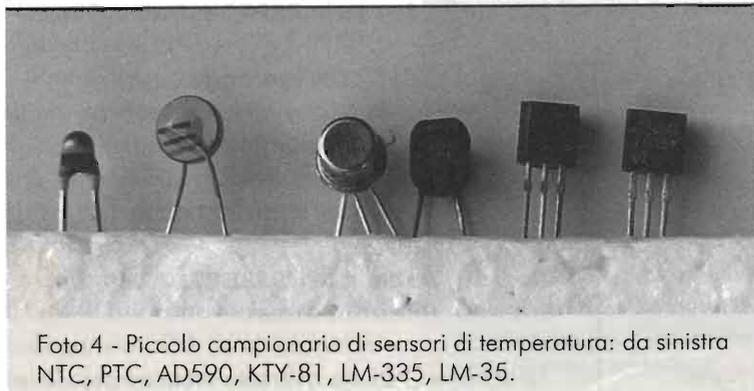
Foto 4 - Piccolo campionario di sensori di temperatura: da sinistra NTC, PTC, AD590, KTY-81, LM-335, LM-35.
