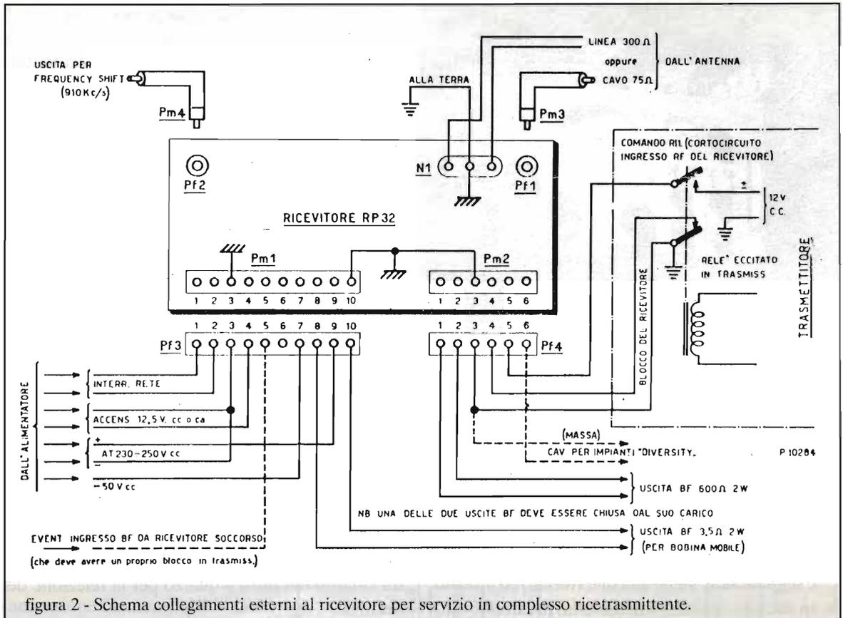
figura 2 - Schema collegamenti esterni al ricevitore per servizio in complesso ricetrasmittente.
