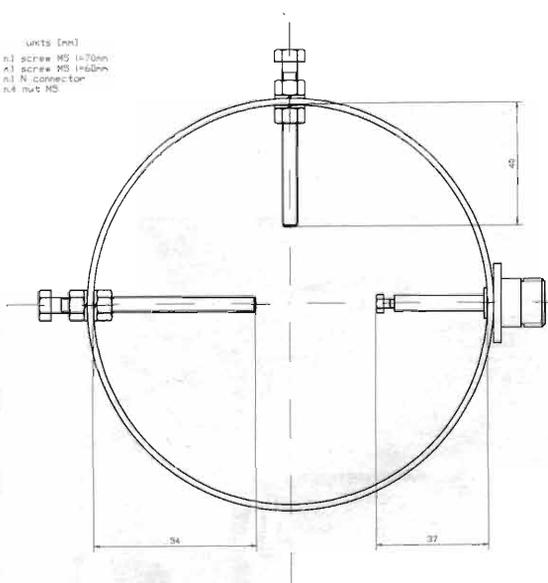
figura 8 - Illuminatore a doppia polarità (disegno).
