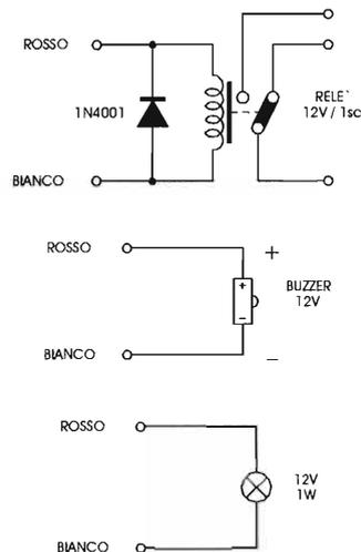
figura 3 - Interfaccia a relè; Interfaccia Buzzer; Interfaccia lampadine.
