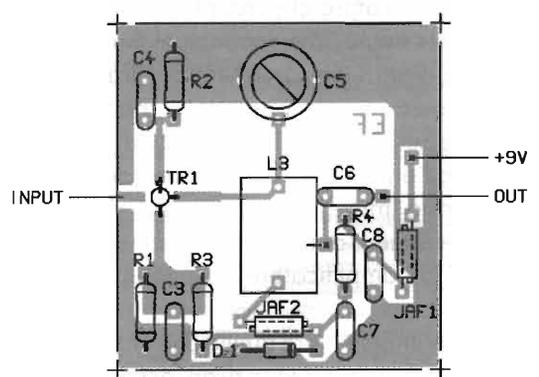
figura 2 - Disposizione componenti.
