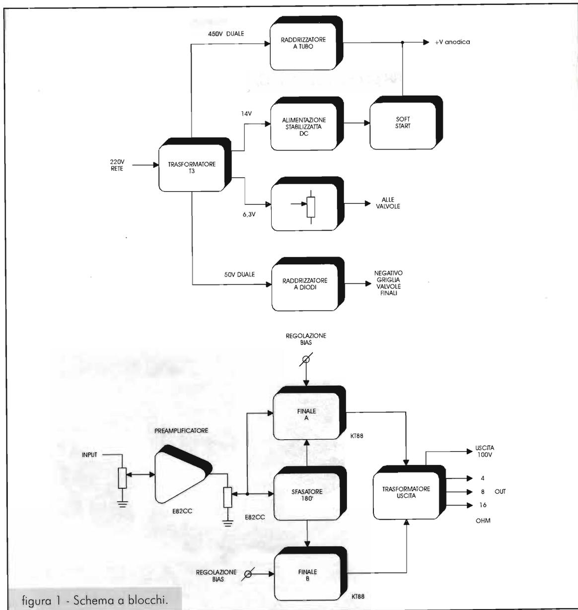
figura 1 - Schema a blocchi.
