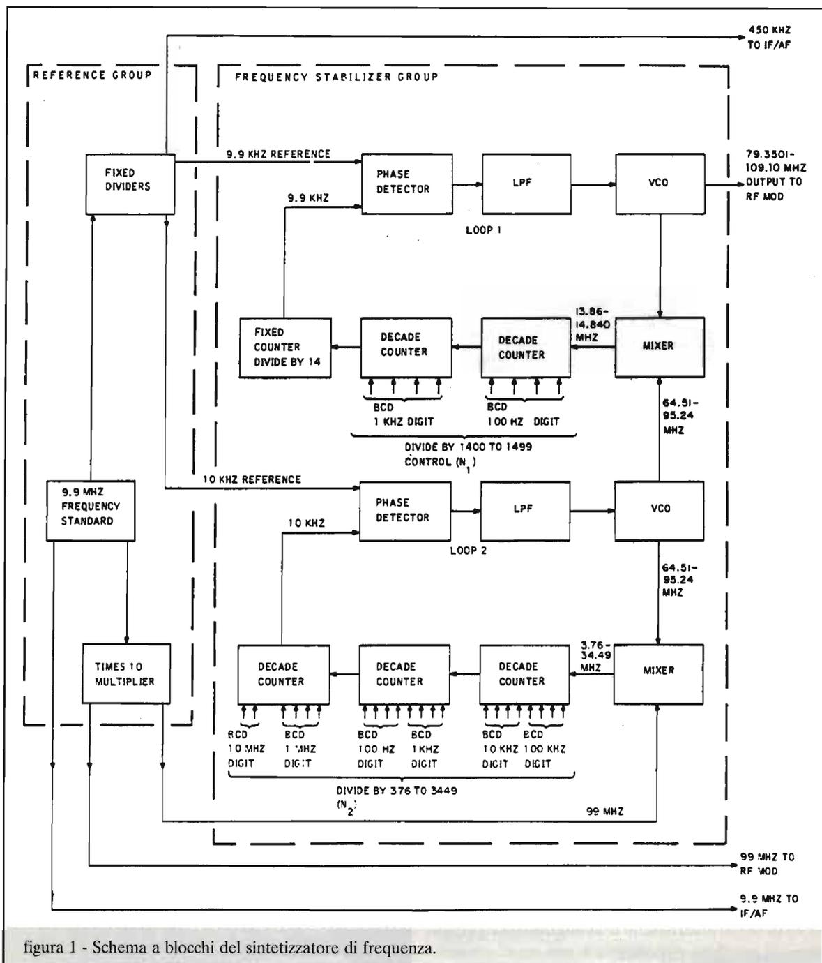
figura 1 - Schema a blocchi del sintetizzatore di frequenza.
