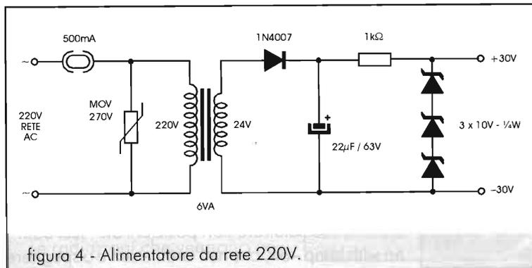
figura 4 - Alimentatore da rete 220V.
