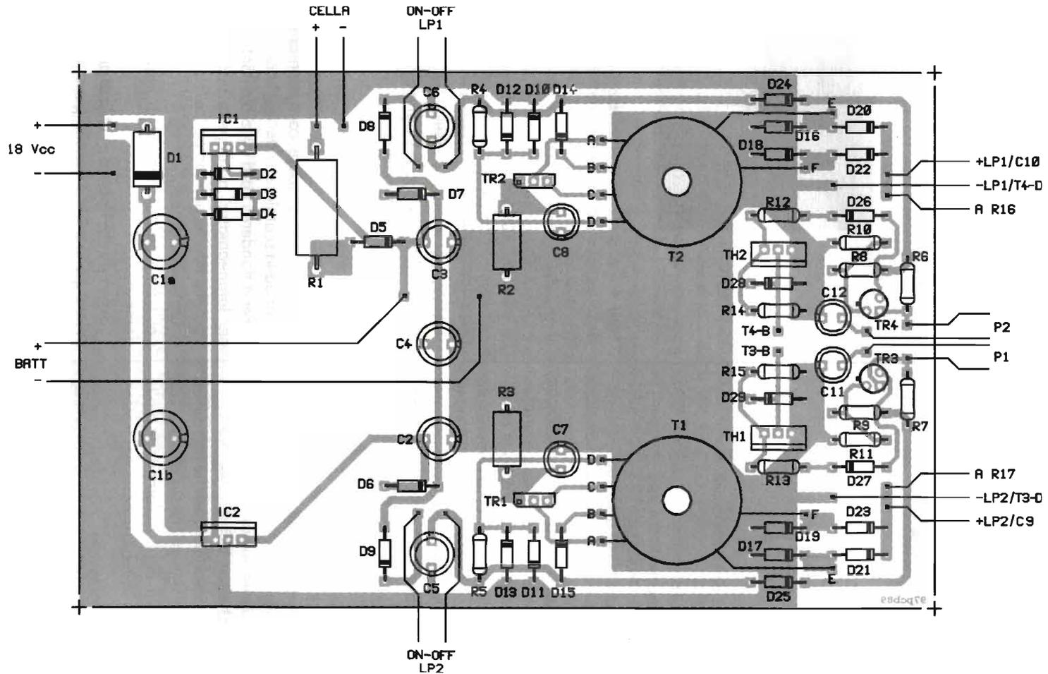
figura 3 - Piano di montaggio. Attenzione: T3, T4, R16, R17, C9, C10, C13 e C14 vanno cablati esternamente al C.S. a ridosso della lampada seguendo le indicazioni riportate nello schema elettrico di figura 2.
