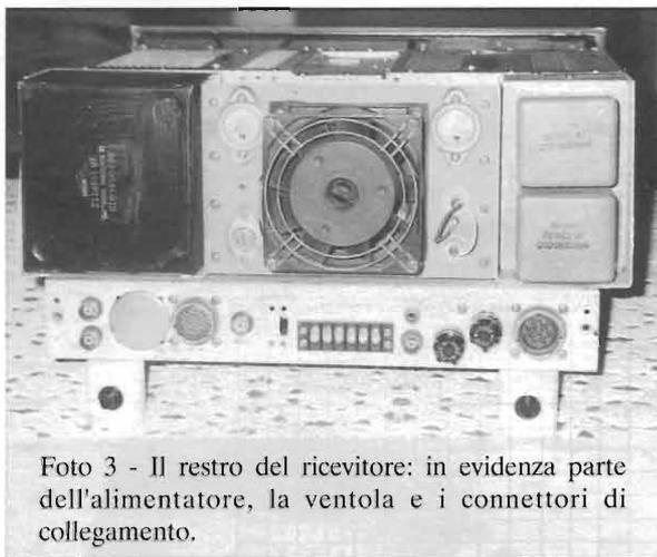
Foto 3 - Il resto del ricevitore: in evidenza parte dell'alimentatore, la ventola e i connettori di collegamento.
