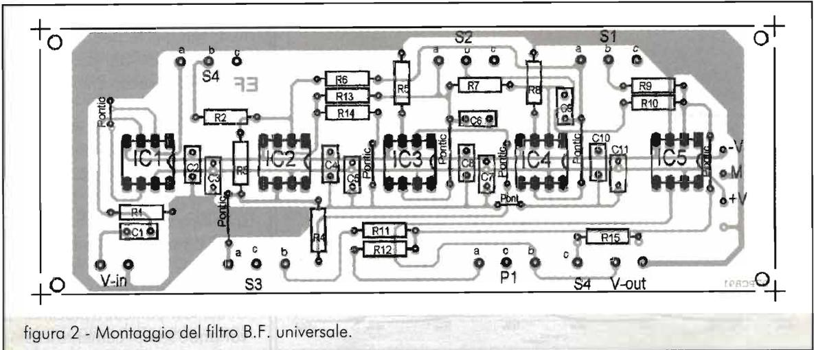
figura 2 - Montaggio del filtro B.F. universale.
