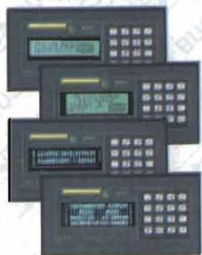
Pannello Operatore, a basso costo, con contenitore standard DIN da 96x192 mm. Disponibile con display LCD Retroilluminato o Fluorescente nei formati 2x20 o 4x20 caratteri; Tastiera da 16 tasti; comunicazione in RS 232, RS 422 o Current Loop; Buzzer; E<sup>2</sup> in grado di contenere fino a 100 messaggi; 4 ingressi optoisolati, acquisibili
