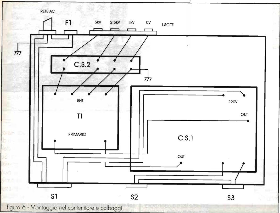
figura 6 - Montaggio nel contenitore e calbaggi.
