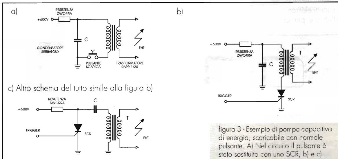
figura 3 - Esempio di pompa capacitiva di energia, scaricabile con normale pulsante. A) Nel circuito il pulsante è stato sostituito con uno SCR, b) e c).
