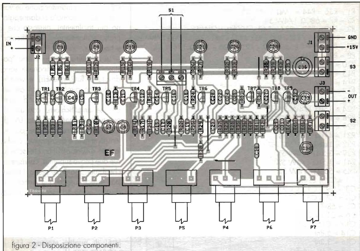
figura 2 - Disposizione componenti.
