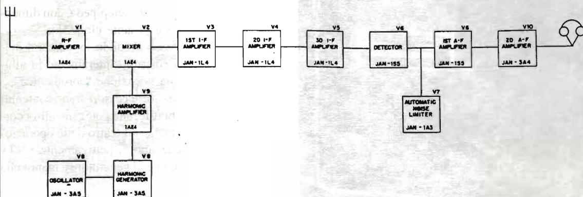
figura 1 - Schema a blocchi del ricevitore.
