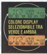
Il display LCD alfanumerico, visualizza i dati relativi la frequenza, canale di memoria, l'indicazione dello stato dei comandi dell'apparato e i nomi delle memorie.
