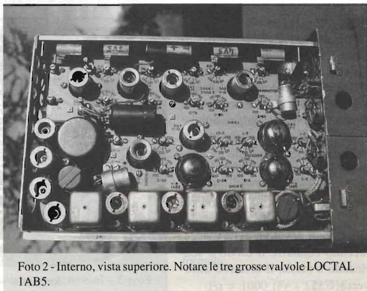
Foto 2 - Interno, vista superiore. Notare le tre grosse valvole LOCTAL 1AB5.
