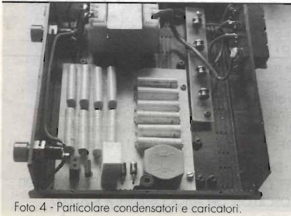
Foto 4 - Particolare condensatori e caricatori.
