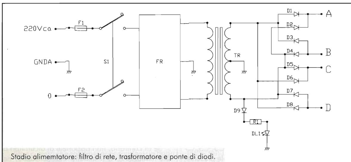
Stadio alimematore: filtro di rete, trasformatore e ponte di diodi.
