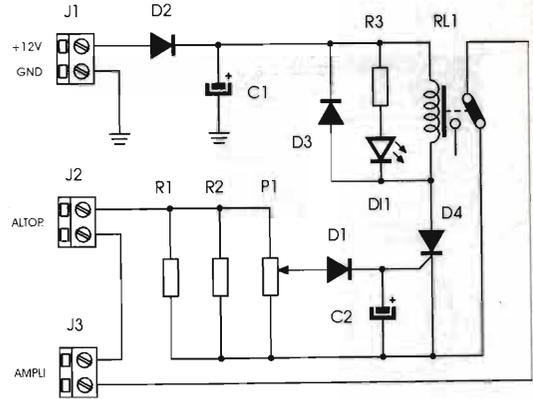
della protezione. Questo circuito, se posto in protezione, si resetta solo togliendo i 12V di alimentazione. Il LED segnala l'avvenuta protezione.
