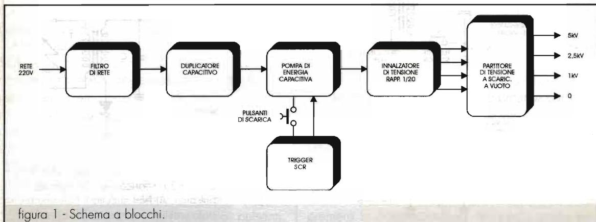
figura 1 - Schema a blocchi.
