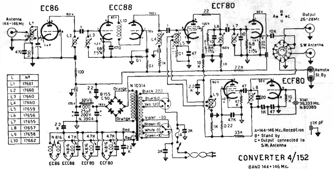
I convertitori di frequenza, 4/151 e 4/152 differiscono solamente per l'alimentazione, dove nel modello 4/152 è autocontenuta.
