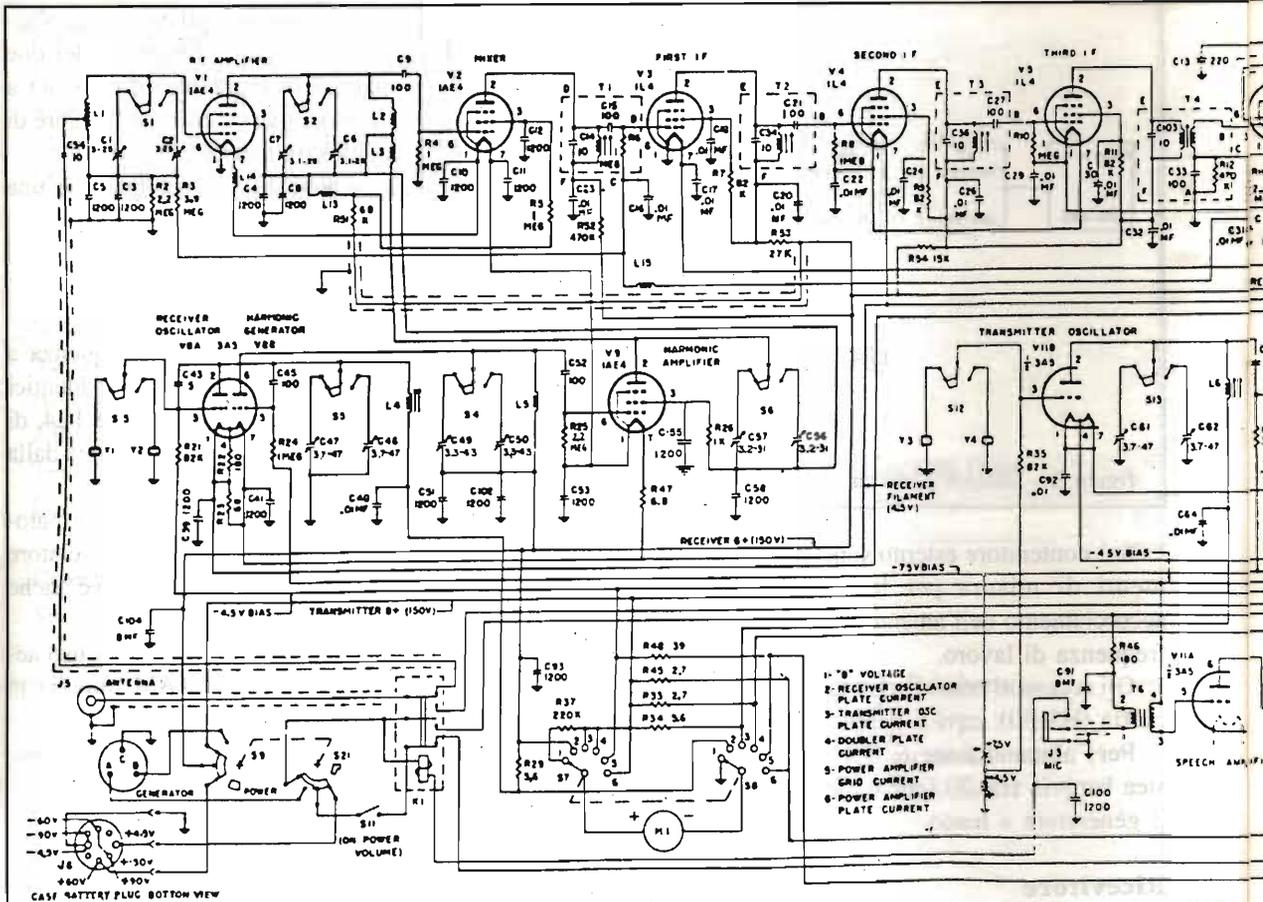
RECEIVER-TRANSMITTER RT-53BM/TRC-7, Schematic Diagram
