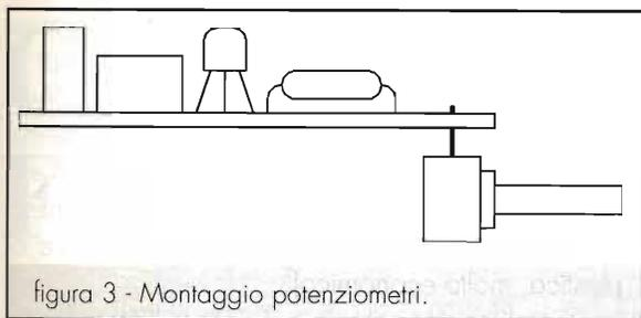
figura 3 - Montaggio potenziometri.
