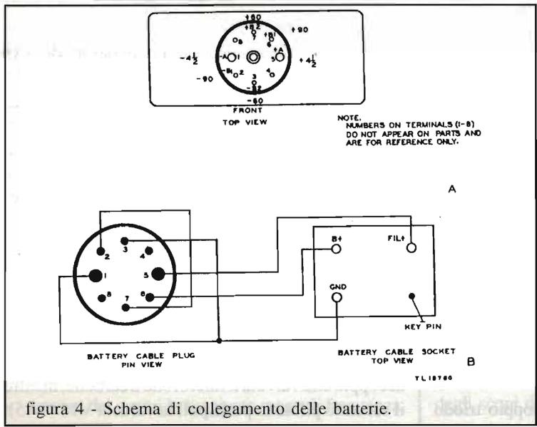
figura 4 - Schema di collegamento delle batterie.
