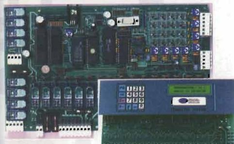
**DD24LCD** è un PLC completo e pronto all'uso realizzato con una scheda a microprocessore basata su Z84C00 con quarzo a 10 MHz.
