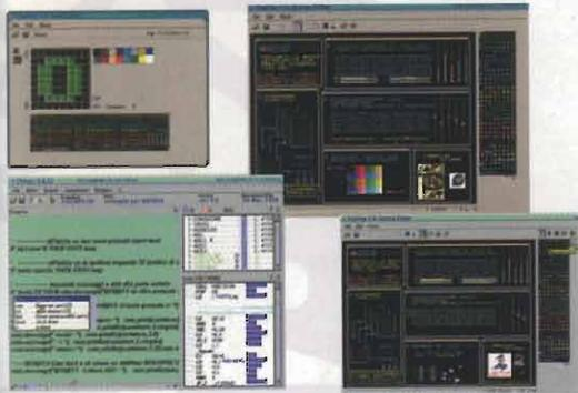
**FBASIC 2** è un compilatore ottimizzato per microprocessori compatibili con il codice Z80 (Z84C00, Z180, 64180, ecc.), facilità di utilizzo grazie all'uso dei componenti software, all'integrazione con l'emulatore di EPROM, ed alla estrema compattezza del codice generato.
