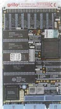
Non occorre alcuna espansione esterna. 80C188 da 20MHz; 256K RAM + RTC con batteria al Litio; 256K EPROM o FLASH, E' seriale; 8 linee di conversione A/D da 12 Bits più segno, 5,5  $\mu s$ ; 24 linee di I/O; 2 linee RS232; RS 422; RS 485 oppure Current Loop; Watch Dog; Timer; Counter; ecc.
