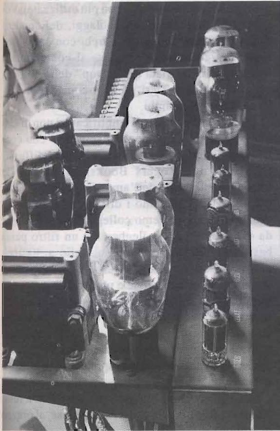
Foto 2 - Vista generale dell'amplificatore da vicino verso il fondo: a sinistra 6 x 6L6G; a destra 3 x 6BE6 (eptodo d'ingresso) 3 x 12AX7 (sfasatore) 2 x 5Z3 raddrizzatrici (sullo sfondo).
