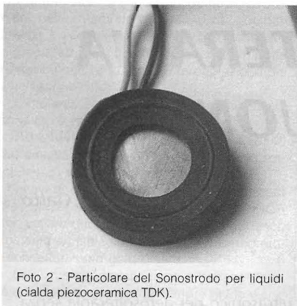
Foto 2 - Particolare del Sonostrodo per liquidi (cialda piezoceramica TDK).
