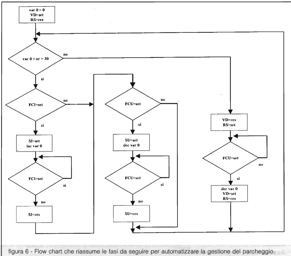
figura 6 - Flow chart che riassume le fasi da seguire per automatizzare la gestione del parcheggio.
