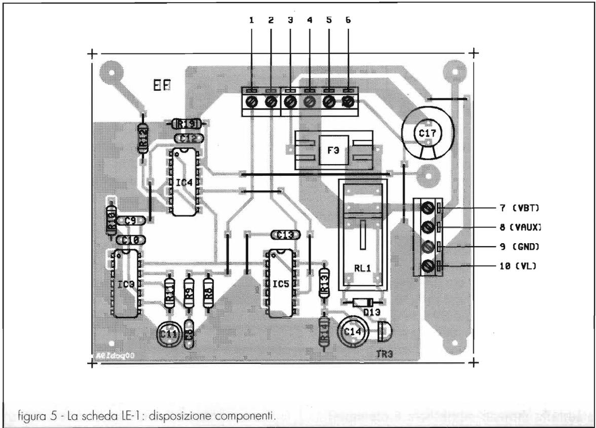
figura 5 - La scheda LE-1: disposizione componenti.
