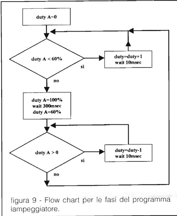
figura 9 - Flow chart per le fasi del programma lampeggiatore.
