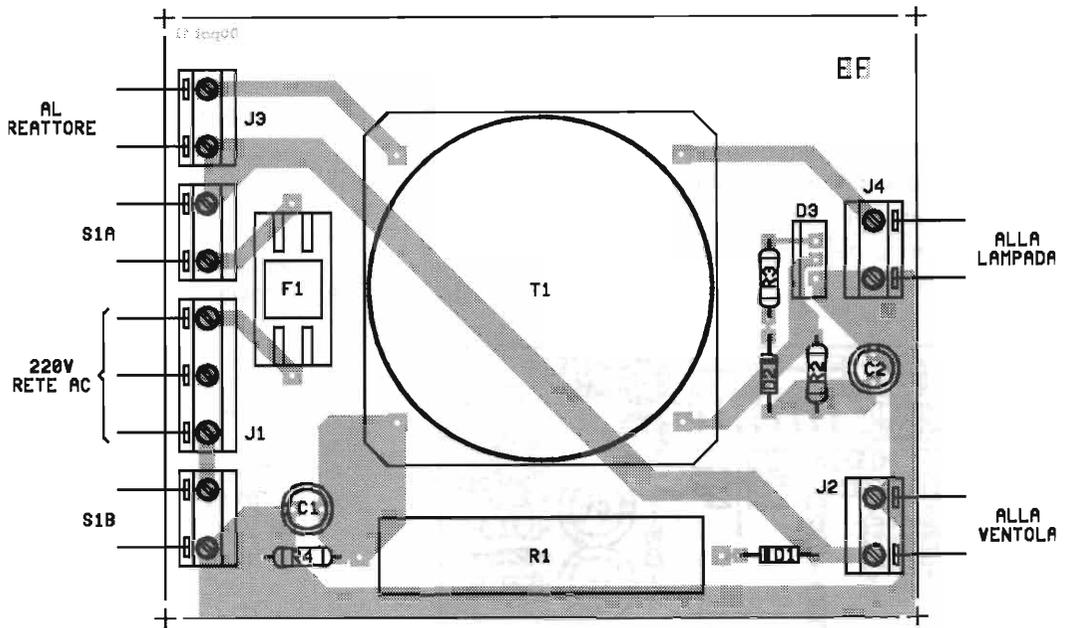
Il circuito di trigger a DIAC e SCR induce sul primario di T1 tensioni di circa 200V che sul secondario in salita erogheranno oltre 10kV.
