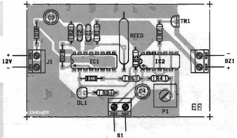
le altre tre come buffer per pilotare TR1 che controlla il buzzer.
