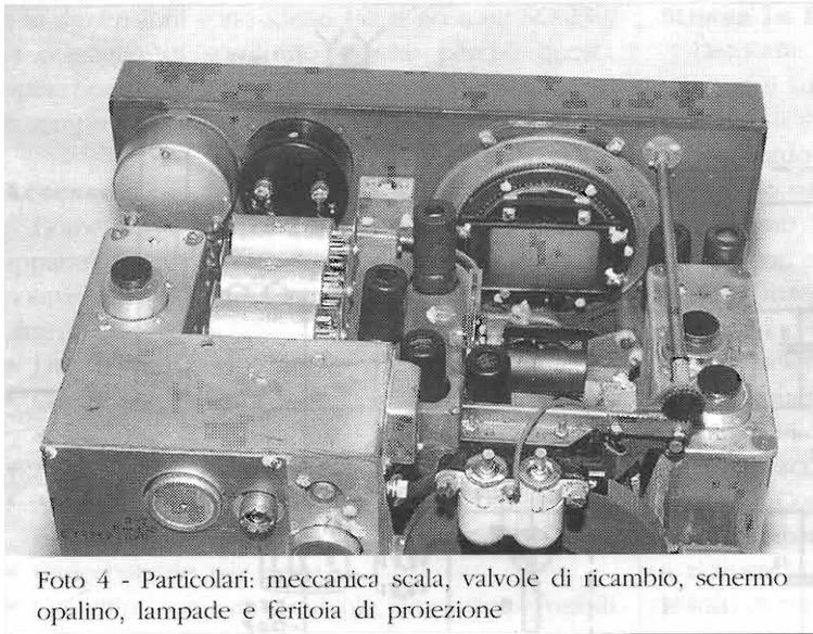
Foto 4 - Particolari: meccanica scala, valvole di ricambio, schermo opalino, lampade e feritoia di proiezione
