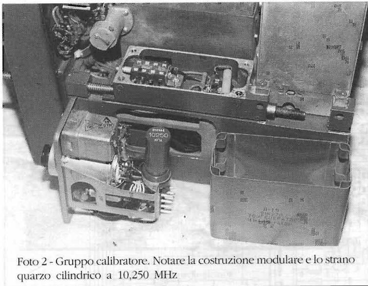
Foto 2 - Gruppo calibratore. Notare la costruzione modulare e lo strano quarzo cilindrico a 10,250 MHz
