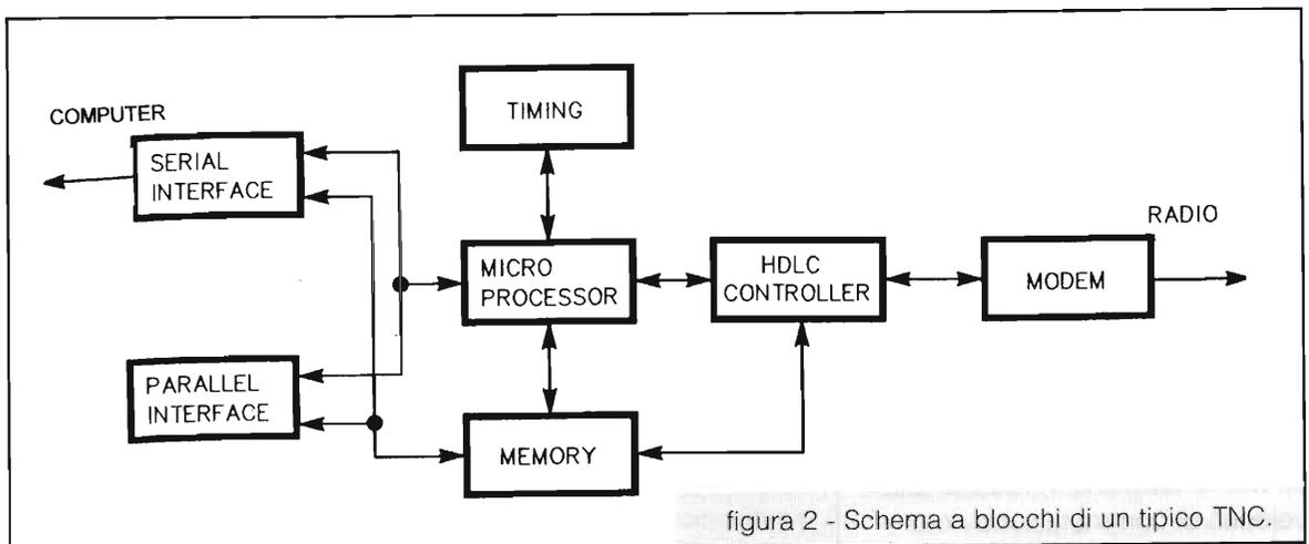
figura 2 - Schema a blocchi di un tipico TNC.
