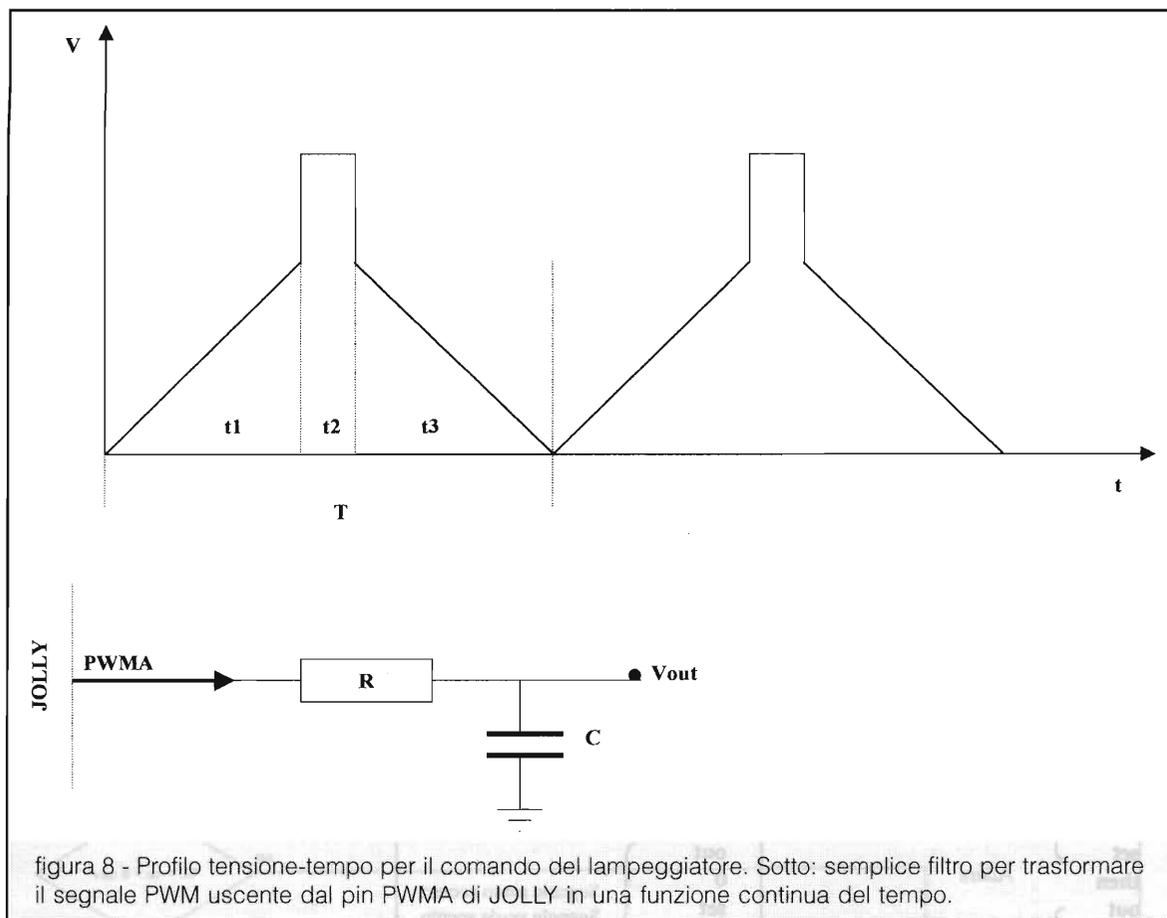
circuito di potenza costituito, ad esempio, da un transistor) periodico con l'andamento rappresentato in figura 8.
