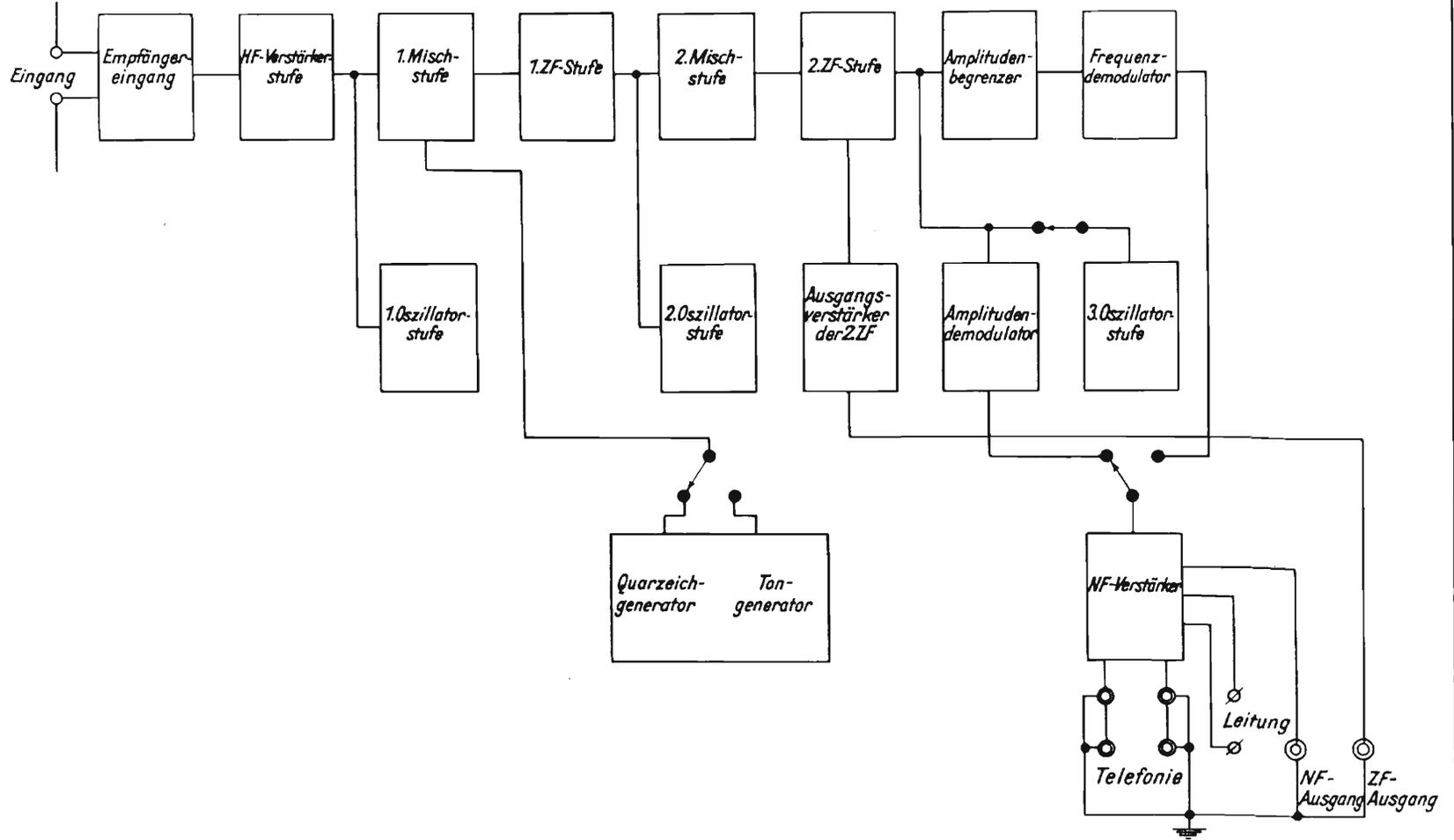
figura 1 - Schema a blocchi.
