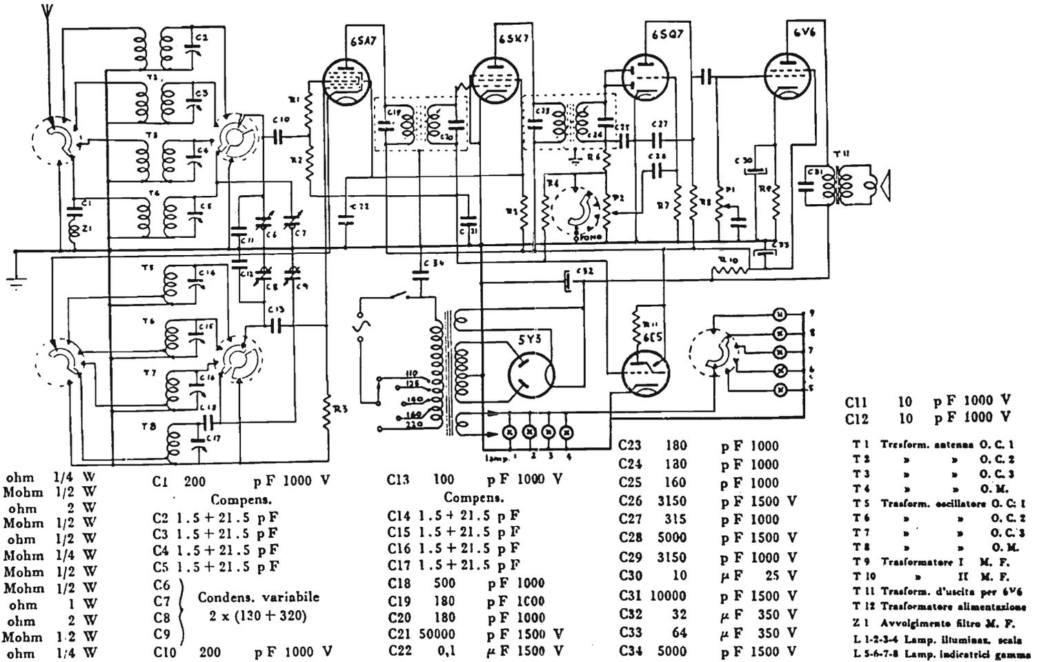
figura 1 - Superla mod. 1R: produzione 1948-50-55 circa. Gamme onde medie da 180 a 580 m; OC1 da 35 a 65 m; OC2 da 20 a 37 m; OC3 da 12 a 21 m. Media frequenza 470 kc/s. Potenza indistorta di uscita 3,5 watt; potenza massima 4,5W.
