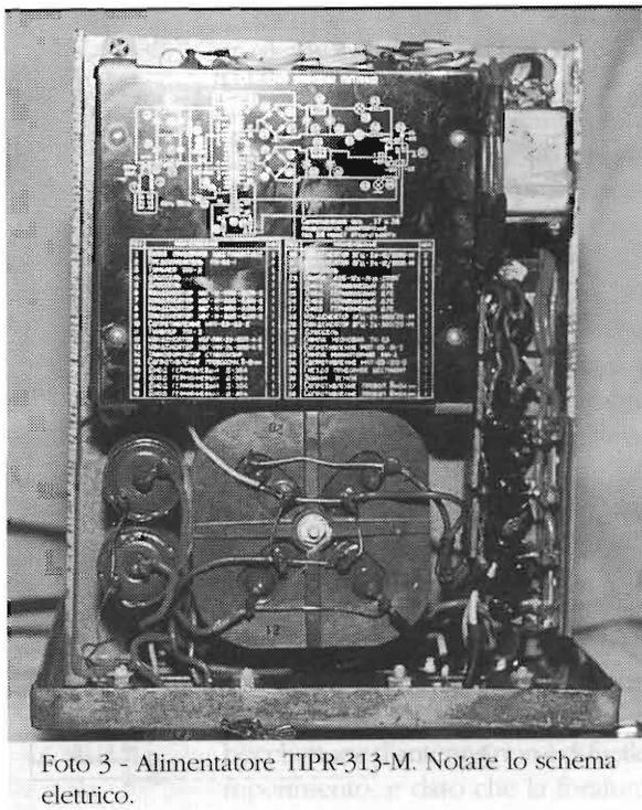
Foto 3 - Alimentatore TIPR-313-M. Notare lo schema elettrico.
