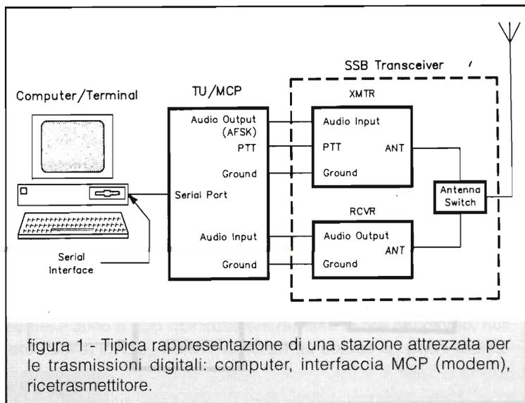
figura 1 - Tipica rappresentazione di una stazione attrezzata per le trasmissioni digitali: computer, interfaccia MCP (modem), ricetrasmittitore.
