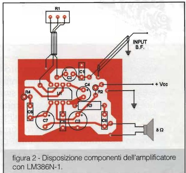
figura 2 - Disposizione componenti dell'amplificatore con LM386N-1.
