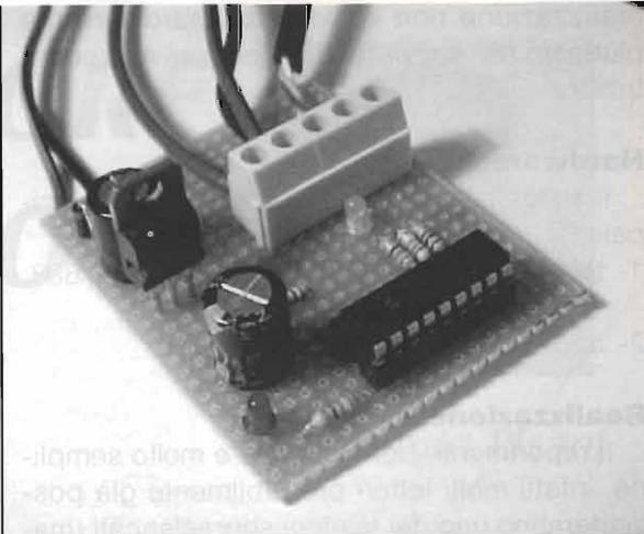
Quando si verificherà l'allarme, il relè porterà a massa il morsetto ALL. Per cui, essendo il combinatore operativo (negativo sempre presente sul morsetto ON) il ciclo di chiamate inizierà.
