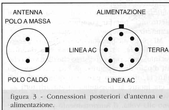
figura 3 - Connessioni posteriori d'antenna e alimentazione.
