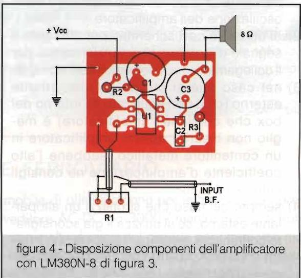
figura 4 - Disposizione componenti dell'amplificatore con LM380N-8 di figura 3.
