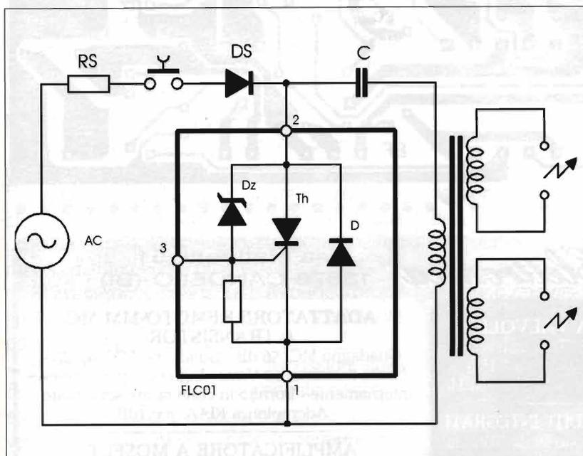
Figura 8 - Circuito di principio funzionamento FLC01.
