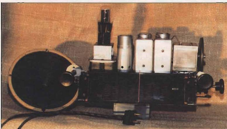
Figura 3 - Foto del telaio estratto dal mobile.
