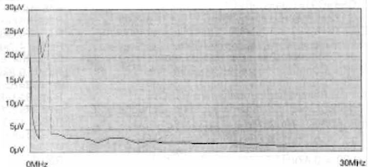
Grafico della sensibilità. Segnale in antenna per accensione secondo DOT su S/Meter. N.B. da 30 a 59,999.0MHz la sensibilità è costante ad 1,4µV. Da 717kHz a 1,535MHz il filtro di banda comprende un attenuatore da 20dB contro interferenza da broadcasting.
