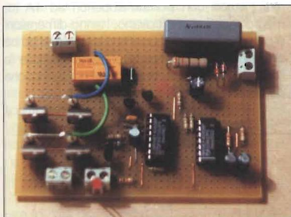
Si tratta di un circuito che automatizza la funzione dei comuni invertitori meccanici utilizzati in tutti gli impianti elettrici quando si vuole gestire un punto luce da più di 2 posizioni. Può essere comodo per far spegnere automaticamente la luce in una stanza di passaggio (io lo uso in un corridoio) o comunque tutte le volte che si vuole automatizzare un punto luce senza voler stravolgere tutto l'impianto (in quanto i comuni timer commerciali vengono azionati da pulsanti).
