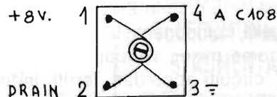
L 36- Supporto Neosid  $\varnothing$  3,75 con nucleo senza schermo. Rame smaltato  $\varnothing$  0,15 mm. Avvolgere 5 spire spaziate di un diametro, in senso orario, con inizio dal piedino 1 e fine al 2. Stendere due strati di smalto trasparente per bloccare il tutto.
