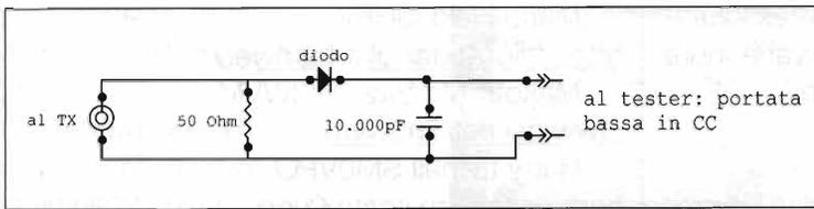
Figura 9 - Circuito di prova del Tx.
