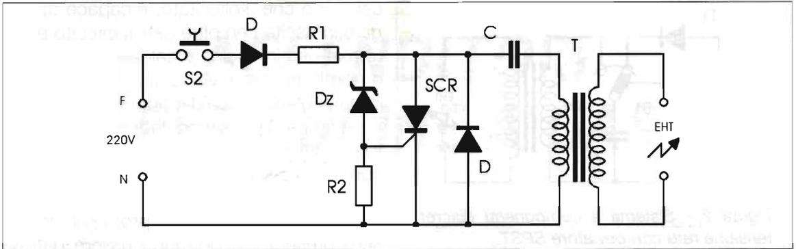
Figura 6 - Sistema elettronico attivo con scintilla a raffica.
