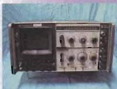
ANALIZZATORE DI SPETTRO
