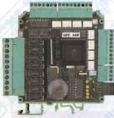
a 64K di FLASH. Vari tool di sviluppo software come **BASCOM 8051**, **Loader-Work**, ecc. rappresentano la scelta ottimale. Disponibile anche con programma di telecontrollo tramite **ALB**; si gestisce direttamente dalla seriale del PC. Fornito di numerosi esempi.
