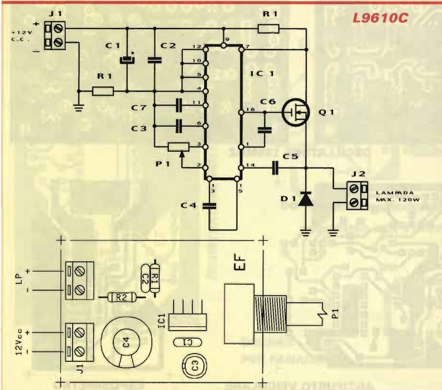
ria in tampone che mantenga alimentato tutto. Il circuito di figura 1 sostituisce gli alimentatori da 12Vcc in dotazione, usa una sola batteria ma soprattutto ha due uscite totalmente separate tra loro da 12V 1 A
