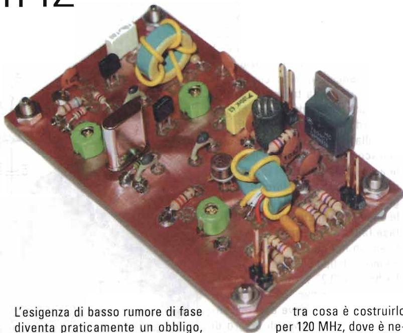
L'esigenza di basso rumore di fase diventa praticamente un obbligo, ad esempio, qualora si stia armeggiando con la SSB o con il CW; non avrebbe infatti molto senso, in un ricevitore supereterodina, inserire in media frequenza un filtro con larghezza di banda di 500 Hz ed avere gli oscillatori locali che producono segnali "spetttralmente" molto "larghi". Oscillatori quindi che erogano una significativa potenza distribuita su uno spettro ad esempio di 3kHz.
