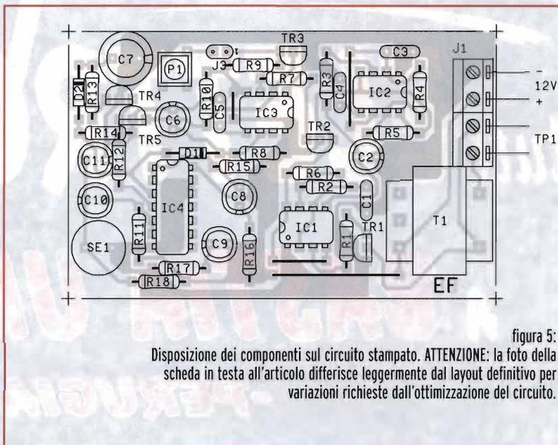
figura 5: Disposizione dei componenti sul circuito stampato. ATTENZIONE: la foto della scheda in testa all'articolo differisce leggermente dal layout definitivo per variazioni richieste dall'ottimizzazione del circuito.
