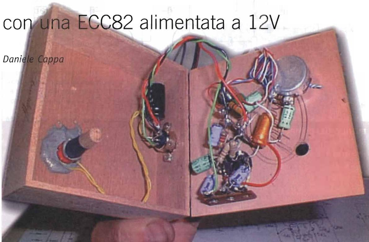
**Uso inconsueto di una vecchia valvola, un preamplificatore microfonico alimentato a bassa tensione da impiegarsi sul ricetrasmittitore**
