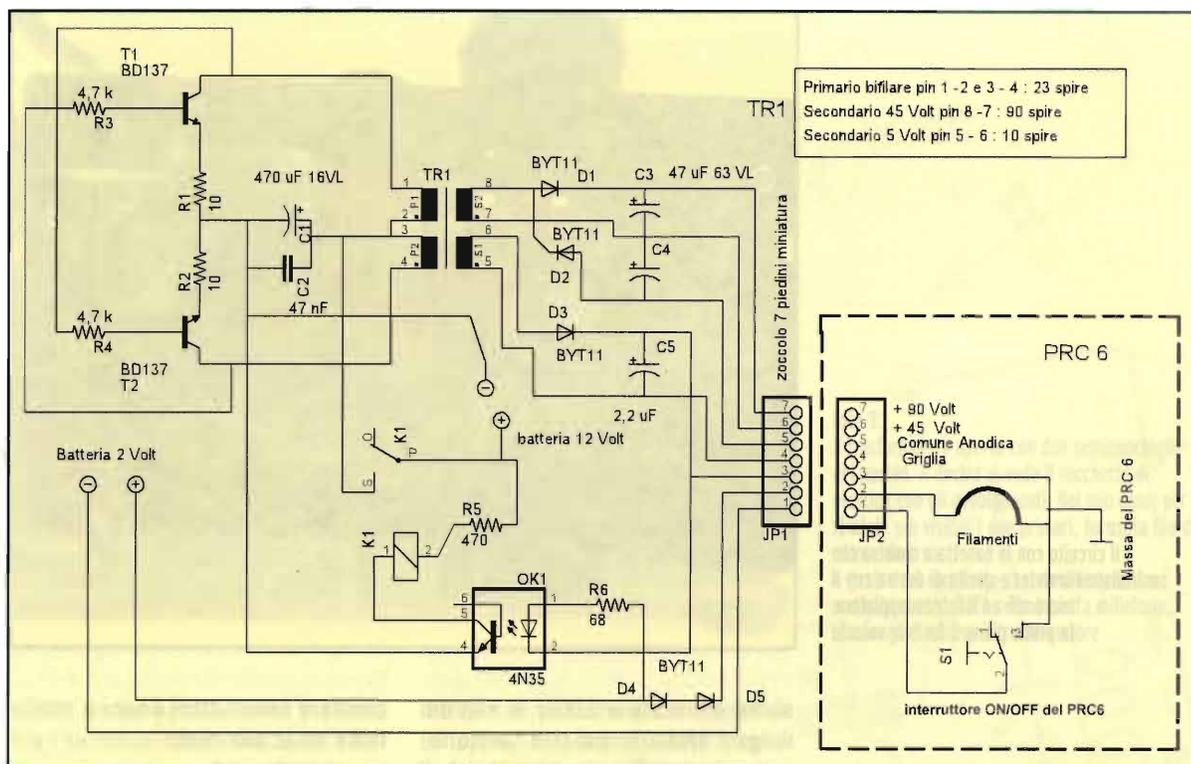
Il principio è semplice: con una batteria ricaricabile cilindrica da 2V si alimentano, tramite un diodo schottky che fa cadere 0,4 volt, i filamenti delle valvole e con una batteria ricaricabile da 12 volt si alimenta l'inverter dell'anodica. Poiché il grosso dell'assorbimento (i filamenti) non è più sull'inverter la batteria 12 volt durerà un bel po'. Una soluzione del genere, sia pure con soluzioni piuttosto discutibili, è stata adottata anche nella referenza bibliografica 2.
