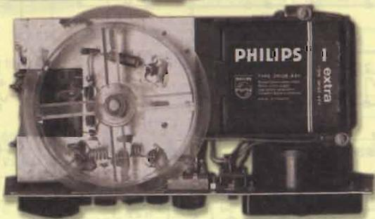
L'efficienza della pila si controlla premendo il pulsante (E - fig. 3) con l'apparecchio acceso. L'indice dello strumento deve raggiungere od oltrepassare il segno rosso a fondo scala.
