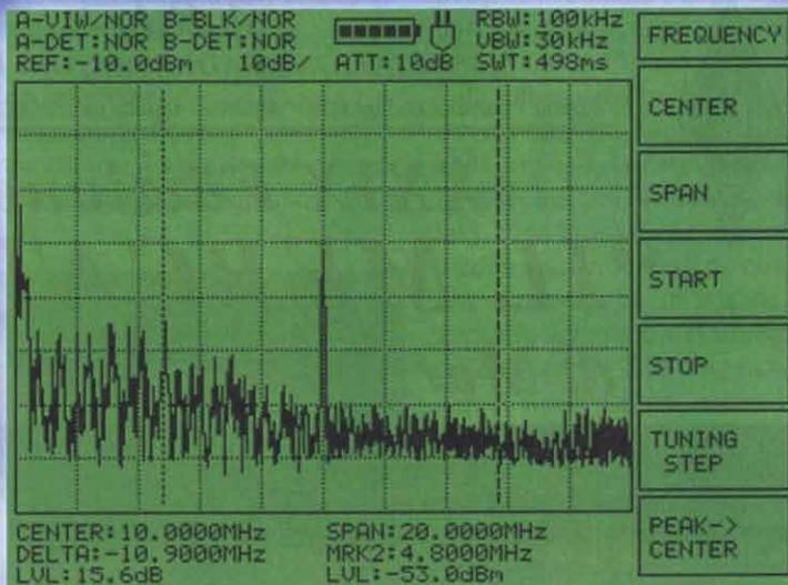
Banda di frequenza 100kHz - 3GHz - sintetizzato a passi di 100Hz - risoluzione IF da 10kHz a 1MHz - oscillatore di riferimento ad alta stabilità - generatore tracking opzionale (modello 3030TG) - Interfaccia RS232 - Software PC/Windows incluso - peso 4,5kg incluse batterie - autonomia 4h - alimentazione 12V - Opzioni: valigia di trasporto, preamplificatori di misura - caratteristiche complete sul nostro sito [www.spin-it.com](http://www.spin-it.com)
