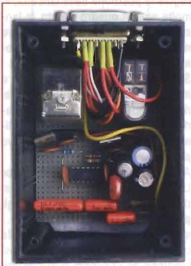
R8, e qui tutto resta com'è. Invece, vediamo IC1A, connesso a invertitore: qui abbiamo C6, inizialmente scarico: allora il pin 3 di IC1A va al positivo, FET2 va in conduzione e RL1 si eccita, per cui il motore può essere avviato. Ma R6 carica C6, in quei 20...30 secondi che concediamo al birbante, dopodiché IC1A commuta, RL1 si diseccita e il motore si ferma, mentre rimane l'indi-
