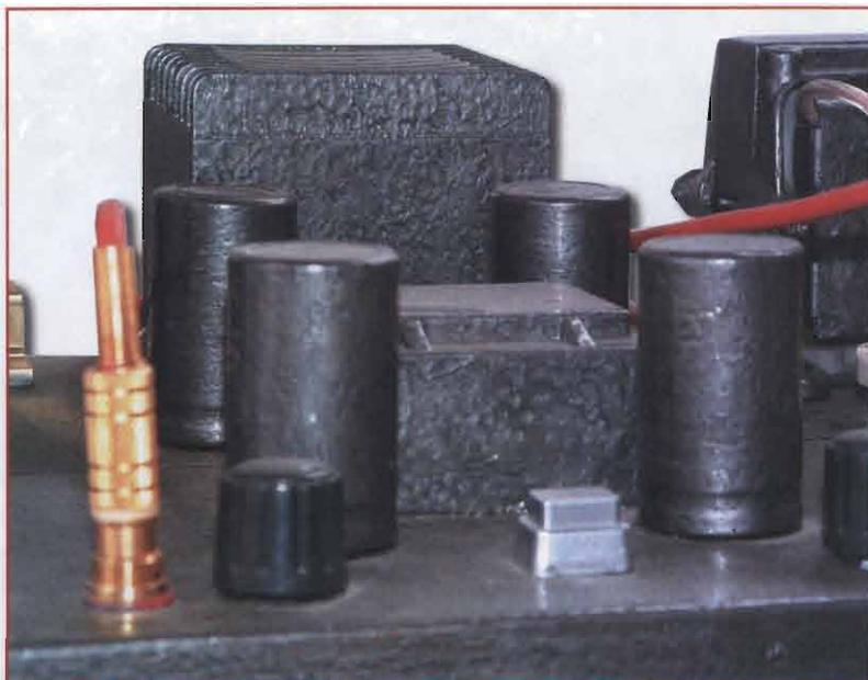
tima fattura, infine tutta l'elettronica sottopannello è stata irrorata di spray antiarco. Lo chassis è verniciato con prodotto hammerite gri-
