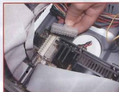
l'aiuto del nostro manuale o di una buona vista (di solito c'è scritto tutto anche sulla scheda stessa). Per l'alimentazione... utilizziamo il cavetto che parte dall'alimentatore e inseriamolo
