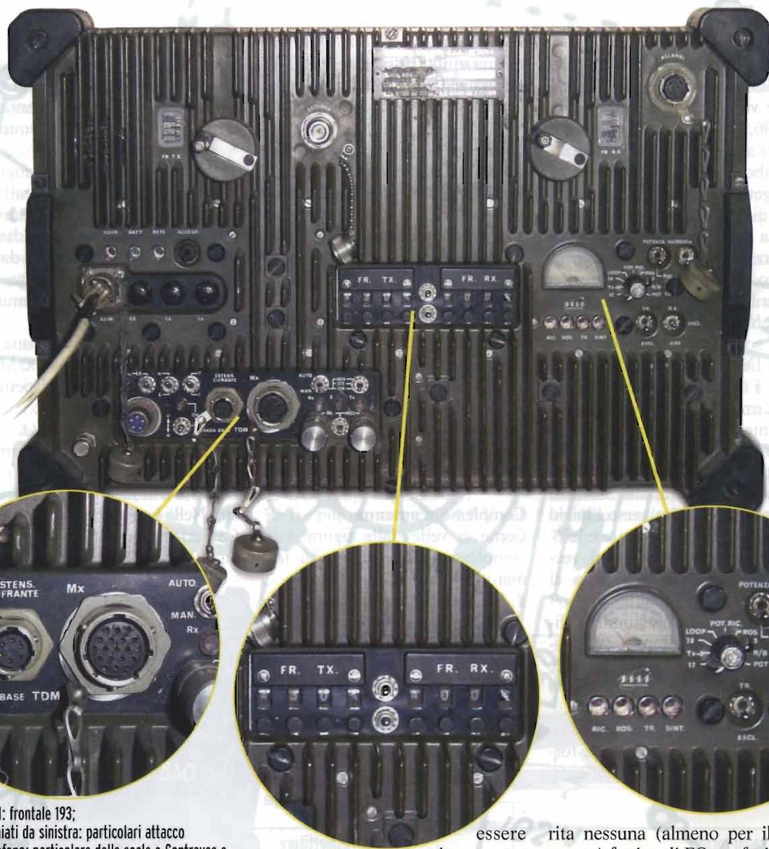
foto 1: frontale 193; cerchiati da sinistra: particolari attacco microfono; particolare delle scale a Contraves e del selettore Baud; particolare del quadro strumento
