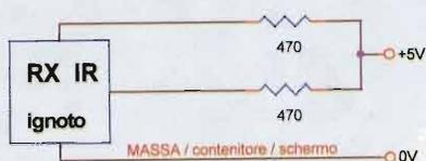
In assenza di segnale IR, sul piedino di alimentazione la tensione rispetto a massa è minore che su quello di uscita dati, per l'assorbimento a riposo del modulo IR
