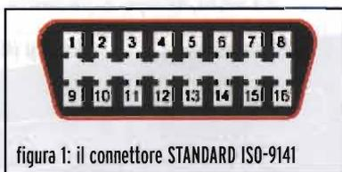
figura 1: il connettore STANDARD ISO-9141
