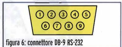
figura 6: connettore DB-9 RS-232
