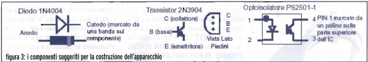
figura 3: i componenti suggeriti per la costruzione dell'apparecchio
