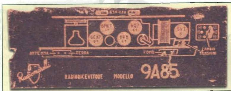
sione in serie dei filamenti (12EA7, 12NK7, 12Q7, 35L6 e 35Z4), mentre il modello in esame impiega la serie analoga di valvole con accensione a 6,3V e la 5Y3 come raddrizzatrice biplacca. Il valore della MF è sempre di 470kHz.
