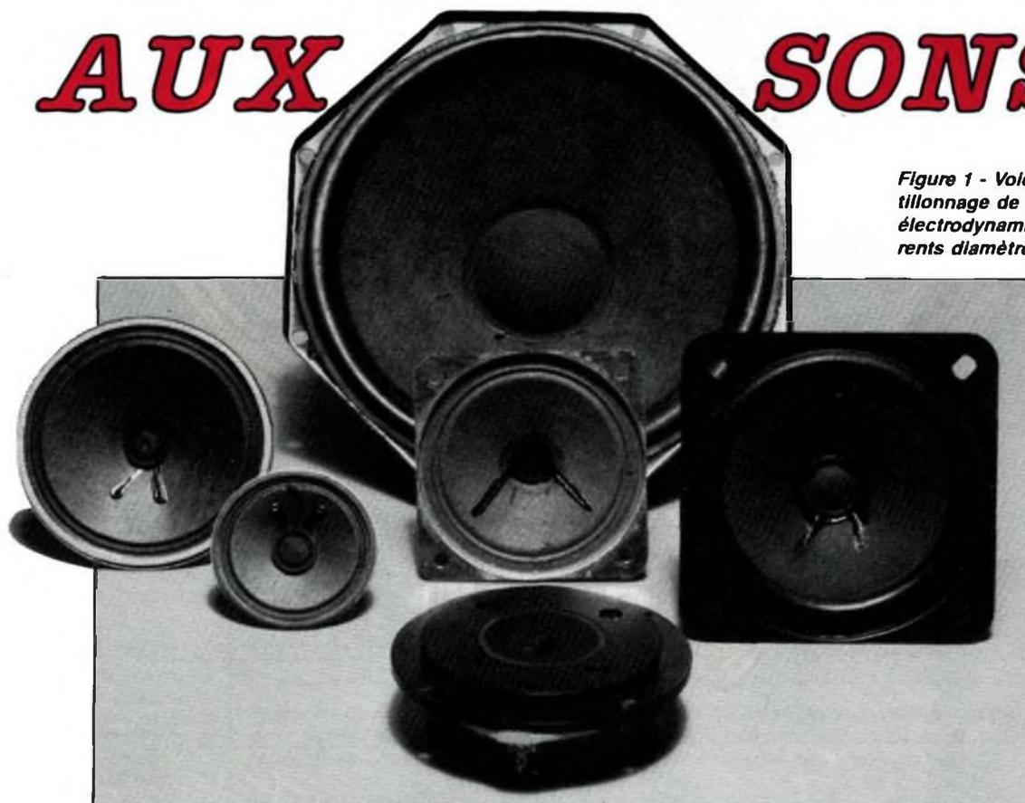
Figure 1 - Voici un petit échantillonnage de haut-parleurs électrodynamiques de différents diamètres.
