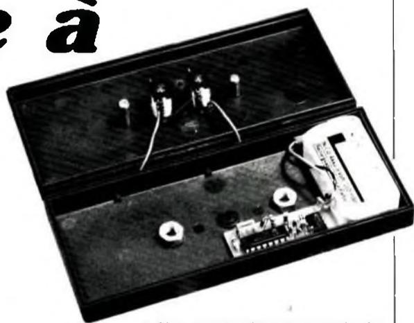
*Vue sur l'intérieur du socle de la pendule. Les écrous M6 collés au fond permettent de stabiliser l'anneau dont les extrémités sont engagées dans le couvercle du socle.*
