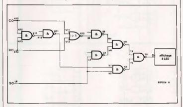
Deux combinaisons d'opérateurs et d'inverseurs réalisent les fonctions ET et OU appliquées aux niveaux logiques des deux entrées C et D. L'entrée S permet de choisir celle des deux fonctions dont le résultat de l'opération logique doit être transmis vers la sortie (ici, l'affichage). Si l'entrée de commande S est au niveau 0, le circuit fonctionne comme un opérateur OU (OR). Si S est au niveau logique 1, le circuit devient un opérateur ET (AND).
