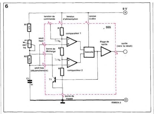
Figure 6 - Voici le schéma synoptique du circuit intégré 555. Le condensateur C1 est chargé et déchargé alternativement. Les comparateurs internes du 555 surveillent l'évolution de la tension aux bornes de C1 par rapport à deux tensions de référence. Ils font basculer le flip-flop en fonction des résultats de cette double comparaison. Le signal de sortie est inversé et sa valeur passe de 0 V à la valeur de la tension d'alimentation et inversement,
