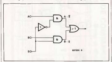
Lorsque l'un des interrupteurs logiques ET est ouvert, sa sortie reste au niveau "0". Dans ce cas l'opérateur OU qui le suit laisse passer les niveaux logiques de l'autre interrupteur (voyez la table de vérité de la figure 3). Il faut aussi empêcher les deux interrupteurs logiques de se fermer (et de s'ouvrir) en même temps : c'est pourquoi l'entrée de commande de l'un des deux est précédée d'un inverseur. Quand on dit "oui" à l'un, cela implique forcément que l'on dit "non" à l'autre, d'accord?
