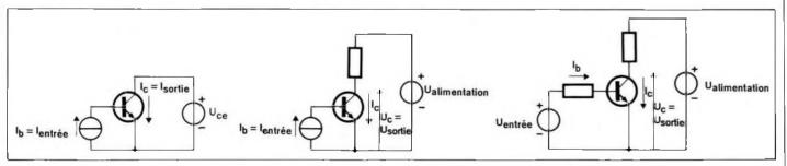
Figure 3a. - Ce transistor est monté en amplificateur de courant : le courant de base amplifié parcourt le collecteur.
