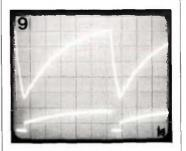
Figure 9 - La courbe supérieure de l'oscillogramme montre l'évolution de la tension aux bornes de C1 au cours du cycle de charge et de décharge. La courbe inférieure retrace les variations de la tension de collecteur de T1 (broche 7). Comparez les deux courbes et vous remarquerez que C1 se décharge quand T1 est conducteur (tension de collecteur = ±0 V).
