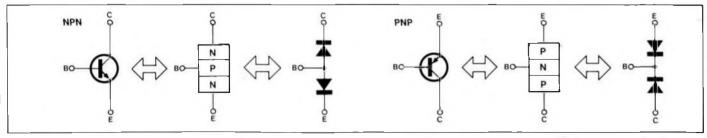
Figure 1 - La méthode la plus simple pour vérifier un transistor est de le considérer comme un montage de deux diodes placées en série et polarisées en sens inverse : la jonction base-émetteur et la jonction collecteur-émetteur. Il suffit alors de les mesurer au moyen d'un multimètre (position ohnmètre).
