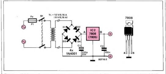
Figure 3 - Voici une alimentation par le secteur, très simple à réaliser, pour le cas où l'emploi très fréquent du CANARI rendrait l'emploi de piles trop onéreux.
