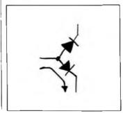
R: «Un instant, s'il te plaît. Pour que la diode conduise, il faut que le "+" soit à la base et le "-" à l'émetteur. Si en plus on connecte le collecteur au "-", il circule également du courant par la diode du haut.»
