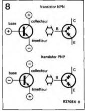
Figure 8 - Les transistors PNP fonctionnent de la même façon que les transistors NPN que nous venons d'étudier. La base et le collecteur des transistors PNP doivent être polarisés négativement par rapport à l'émetteur.
