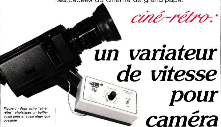
Les caméras modernes sont toutes équipées d'un système d'entraînement par moteur qui maintient constante la vitesse de défilement des images. Pour le super 8, ce sont 18 images par seconde. On peut modifier la vitesse de prise de vues à l'aide d'un dispositif très simple à condition que la caméra soit dotée d'une prise d'entrée pour déclencheur à distance. Ceci nous évitera de farfouiller dans la caméra elle-même (ce qui est passionnant, mais risqué!).
