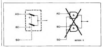
Si l'on prend soin en revanche de **combiner** les sorties des deux opérateurs ET (AND) avec un opérateur OU (OR) le circuit logique fonctionne en commutateur logique.
