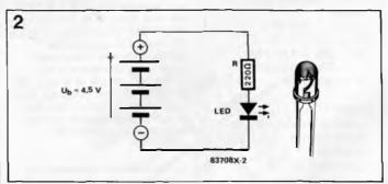
Figure 2 - Le courant qui traverse ce circuit provoque l'allumage de la diode. Une résistance talon limite le courant qui traverse la diode.
