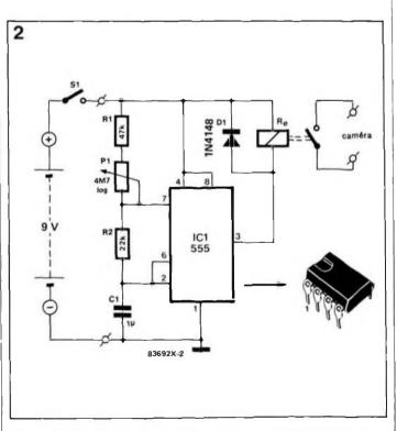
Figure 2 - Le circult intégré 555 est un temporisateur extraordinairement flexible et très fiable. Il constitue le cerveau de ce montage et il est le garant d'une excellente reproductibilité du circuit.
