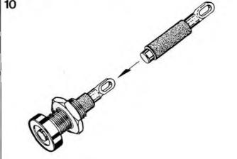
Figure 10 - Ce très bon contact est fabriqué à l'aide d'une douille banane et d'un fil en culvre isolé.
