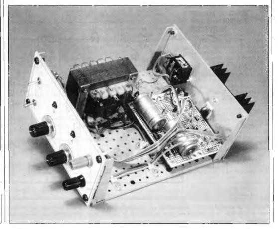
recommandé car il permet à la fois d'économiser un radiateur et de donner à l'appareil une solidité suffisante pour le dur travail qui l'attend au laboratoire. Inutile de rappeler que le coffret doit être relié au conducteur jaune-vert du cordon secteur, ni que la connexion de masse du circuit (pôle négatif) ne doit avoir aucun contact avec la tôle du coffret.
