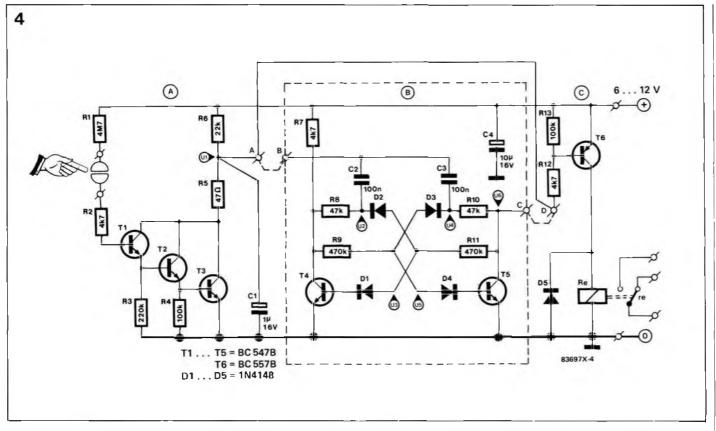
Figure 4 - Le schéma général prévoit les deux versions de l'interrupteur à effleurement. Si la bascule bistable (partie centrale) n'est pas utilisée, il suffit de raccorder l'étage d'entrée (point A) à l'étage de puissance (point D).
