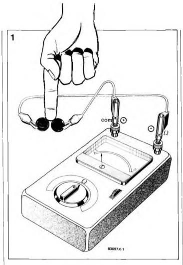
Figure 1 - A l'aide de deux pièces de monnaie et d'un multimètre vous pouvez vérifier le principe sur lequel est basé l'interrupteur à effleurement.
