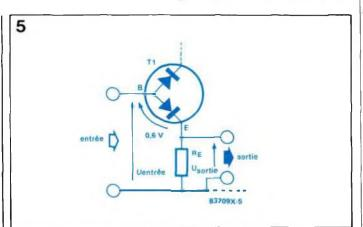
Figure 5 - La différence de potentiel entre l'entrée et la sortie du montage en émetteur suiveur est occasionnée par une chute de tension dans la jonction base-émetteur.
