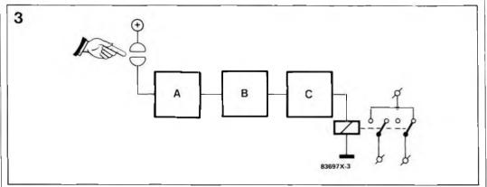
Figure 3 - Synoptique de la version interrupteur marche/arrêt. La bascule monostable B execute et mémorise le dernier ordre reçu. Elle maintlent l'exécution de cet ordre quand le doigt n'effleure plus le contact.
