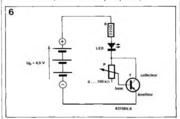
Figure 6 - lci le collecteur est connecté à la LED sans passer par le potentiomètre, ce qui permet de régler très progressivement la luminosité de la LED en agissant sur le courant de base du transistor.
