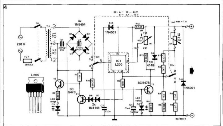
Figure 4 - Le schéma de cette alimentation est nécessairement plus compliqué que celui des autres montages d'Elex. Mais le jeu en vaut la chandelle : la possibilité de régler la limitation de courant rend l'alimentation particulièrement bien adaptée à l'expérimentation.
