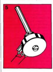
Figure 5 - Le potentiomètre est câblé à l'aide de deux fils seulement : le curseur est rellé à l'une des extrémités de la piste, mais pas nimporte laquelle car le potentiomètre est logarithmique.
