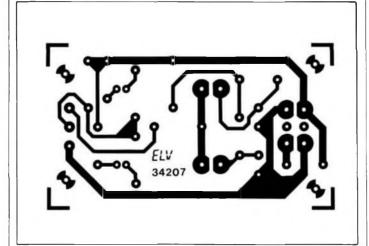
Figure 2 - Circuit imprimé du testeur de thyristors et de triacs, vu du côté de la piste cuivrée.
