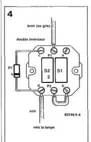
être de forme et dans une disposition différentes en fonction du modèle d'inverseur, mais un doute éventuel sera levé au moyen d'un testeur de continuité (sonnette).
