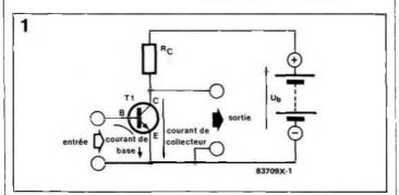
Figure 1 - Dans le montage en émetteur commun, le courant de collecteur, commandé par le courant de base, crée une chute de tension aux bornes de la résistance de collecteur R<sub>c</sub>. La tension de sortie est égale à la tension d'alimentation moins la chute de tension aux bornes de la résistance de collecteur.
