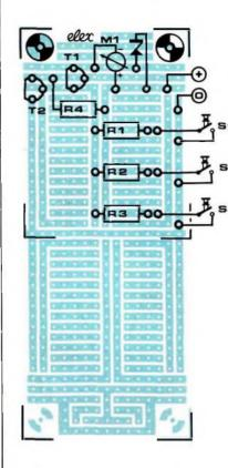
Figure 6 - Schéma d'implantation du testeur de diodes stabilisatrices de tension, sur une petite platine d'expérimentation de format 1.
