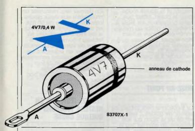
Figure 1 - Ce dessin Indique la concordance entre le symbole d'une diode Z et le composant réel. La cathode se trouve du côté de l'anneau de cathode. La tension zener est inscrite sur le corps de la diode.
