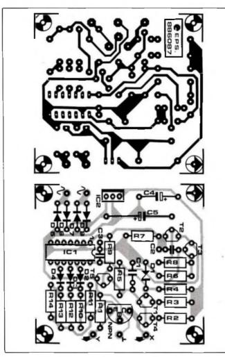
Figure 7 - Une fois n'est pas coutume : pour ce traceur de courbes nous avons conçu un circult imprimé qui vous facilitera la construction. Les pistes sont étamées et protégées par un vernis-épargne. L'implantation des composants est reproduite en sérigraphie sur la face composants. C'est du luxe.
