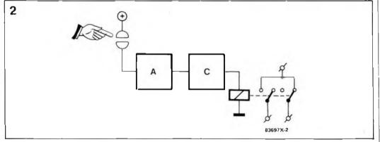
Figure 2 - Synoptique de la version bouton-poussoir à contact de travail : le relais est activé tant que le doigt touche le contact.
