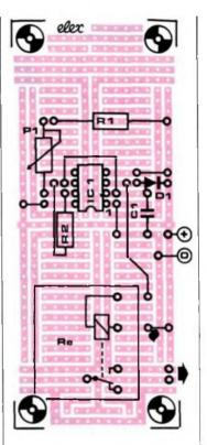
Figure 4 - Voici la façon d'implanter les composants. Repérez soigneusement les fils de pontage et respectez l'orientation de la diode et du circuit intégré.
