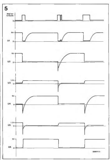
Figure 5 - Les variations de la tension règnant aux différents points de mesure indiqués sur le schéma général sont reportées sur ce diagramme. Il permet de mieux comprendre le fonctionnement du bistable.
