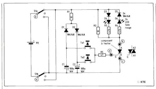
Figure 1 - Schéma du testeur de thyristors et de triacs.
