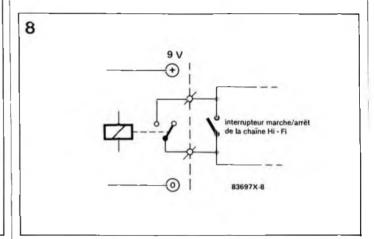
Figure 8 - Les bornes de contact du relais sont tout simplement raccordées en parallèle sur les bornes de l'interrupteur . . . de votre chaîne stéréo par exemple.
