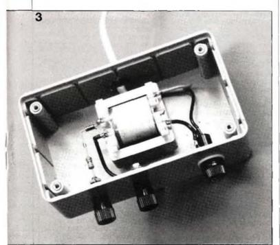
Figure 3 - Le câblage très simple qu'illustre la photo est facile à réaliser. Un boîtier en matière plastique vous donne une bonne sécurité électrique. Le câble d'alimentation 220 V doit être pourvu d'un dispositif anti-traction: un noeud dans le fil par exemple, à hauteur de la traversée du boîtier.
