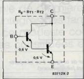
En pratique, on considère le montage Darlington comme un seul transistor, présentant une tension de seuil double et un gain en courant égal au produit des gains unitaires des deux transistors.
