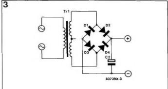
Figure 3 - Pour obtenir des tensions élevées, on dispose les enroulements en série. Il y a alors quatre diodes pour assurer le redressement.
