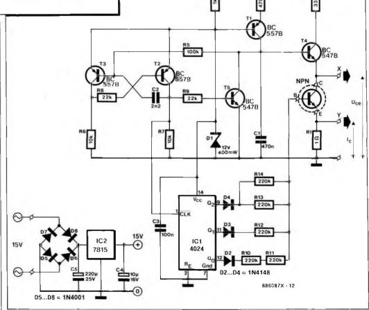
Figure 6 - Schéma complet du traceur de courbes. Vous remarquerez que le générateur de courant de base est construit autour d'un compteur binaire.
