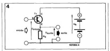
Figure 4 - Le montage en émetteur suiveur est caractérisé par la présence d'une résistance dans le circuit de l'émetteur. La tension de sortie est inférieure d'environ 0,6 V à la tension d'entrée.
