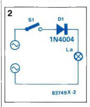
La durée de vie d'une ampoule à incandescence connectée selon la figure 2, et fonctionnant en régime "économique", est considérablement supérieure à ce qu'elle serait dans le cas d'un raccordement direct au secteur. C'est ainsi que six ampoules de 100 W (ce sont des watts) alimentées à travers des diodes n'ont connu aucune défaillance au bout de huit ans d'utilisation
