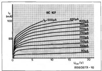
Figure 4 - La caractéristique de sortie d'un transistor BC 107 telle
