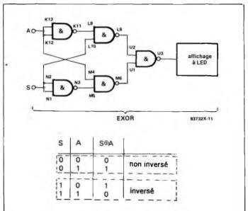
La table de vérité fait ressortir que les niveaux logiques appliqués à l'entrée A sont inversés à la sortie si l'entrée de commande est au niveau logique "1". Si elle est au niveau "0", le niveau logique de l'entrée A se retrouve inchangé à la sortie.
