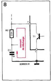
Figure 8 - Lorsque la tension de C1 atteint le seuil de la tension de référence la plus élevée, T1 devient conducteur et décharge C1.
