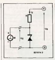
Figure 3 - Schéma de principe d'un testeur de diodes Z.
