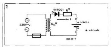
Figure 1 - Trois composants suffisent pour construire ce minichargeur: un transfo, une diode et une résistance. L'adjonction d'un fusible dans le circuit primaire du transformateur n'est pas du luxe
