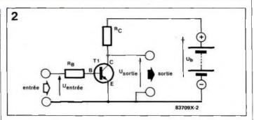
Figure 2 - Un amplificateur de tension monté en émetteur commun. La résistance de base R<sub>B</sub> convertit la tension d'entrée en courant de base.
