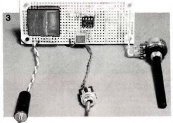
Figure 3 - Tous les composants sont soudés sur une petite plaquette expérimentale de 40 x 100 mm. La pile, le potentiomètre et l'interrupteur marche-arrêt sont fixés au boîtler.
