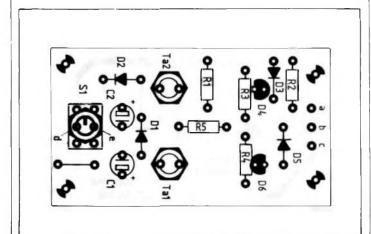
Figure 3 - Schéma d'implantation des composants.
