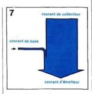
Figure 7 - Dans les transistors dont l'amplification en courant est très forte, le courant de collecteur et le courant d'émetteur sont pratiquement égaux.
