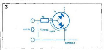
Figure 3 - La tension d'entrée perd une partie de sa valeur (0,6 V) dans la jonction base-émetteur.
