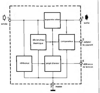
Figure 1 - Il y a bien plus dans le coeur de l'alimentation universelle Elex -le régulateur de tension L200- qu'un simple transistor de puissance. Les fonctions nécessaires à la régulation de tension sont complétées par des protections du circuit intégré contre les surcharges.
