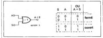
lci l'entrée de commande "S" doit être maintenue au niveau "O" pour que la sortie de l'opérateur restitue le niveau logique de l'entrée A, tandis que le niveau "1" de l'entrée de commande maintient la sortie de l'opérateur au niveau "1" quel que soit le niveau logique de l'entrée A. Pour vérifier le fonctionnement d'un opérateur OU dans la fonction de porte logique, au moyen de la platine DIGILEX, il faut utiliser un opérateur NON-OU (NOR) (Y) suivi d'un inverseur (U).
