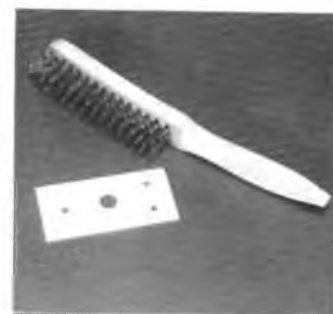
Figure 2 - Le brossage ne sera terminé que quand la surface sera uniformément mate.
