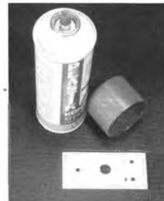
Figure 4 - Faute de pouvoir anodiser la surface, il faut la protéger contre l'abrasion par plusieurs couches de vernis.
