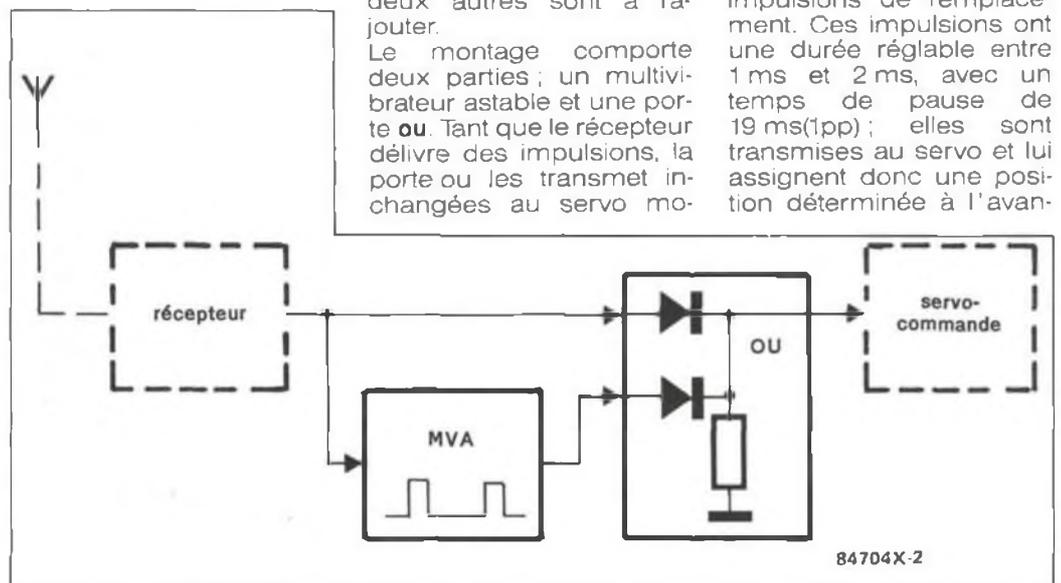
Figure 2 - Les parties encadrées en pointillé font partie de toute installation de radio-commande. Les autres représentent le prix de la sécurité ; modique, disons-le.
