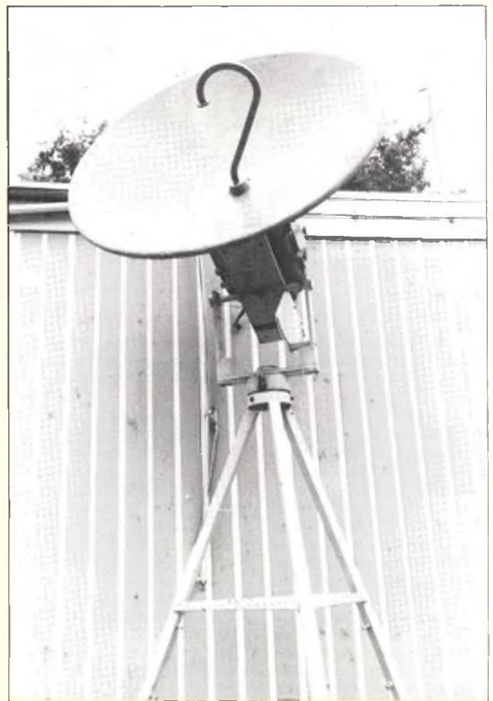
Figure 12 - Cette parabole destinée à la réception des satellites a un diamètre de 1,20 m. Le point d'interrogation n'est pas un radiateur ordinaire, il s'agit d'une cavité résonnante, accordée par ses dimensions sur la fréquence à recevoir. Pour ces hyper-fréquences, les parois de la cavité sont à la fois les éléments conducteurs, inductifs et capacitifs du circuit résonnant.
