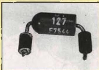
la route à des parasites UHF par exemple. Le procédé a fait ses preuves, et il est si facile à mettre en oeuvre que l'on ne risque rien à essayer : il suffit d'enfiler la perle sur la broche de l'un ou l'autre composant en un point adéquat d'un circuit, par exemple sur la base d'un transistor d'entrée.
