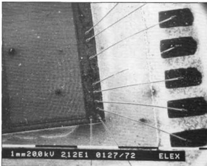
Figure 4 - L'intérieur d'une EPROM (circuit de mémoire programmable effaçable) dont la santé laisse beaucoup à désirer : elle présente un fil de connexion brûlé et quelques cratères qui ne disent rien qui vailent.
