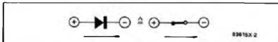
Figure 2 - La diode est polarisée en sens direct, elle ne s'oppose pas au passage du courant et fonctionne comme un interrupteur fermé.
