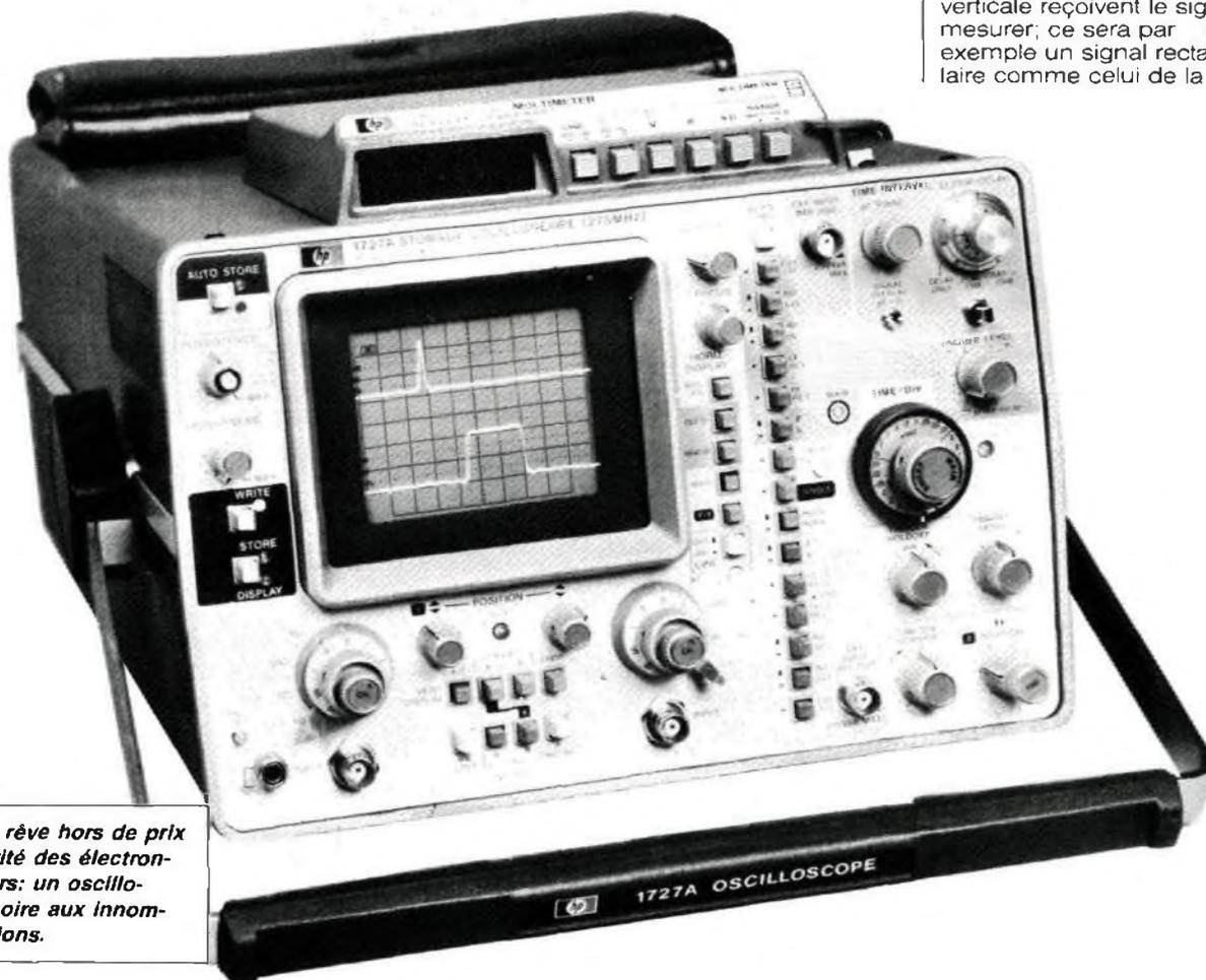
Figure 1 - Un rêve hors de prix pour la majorité des électroniciens amateurs: un oscilloscope à mémoire aux innombrables fonctions.
