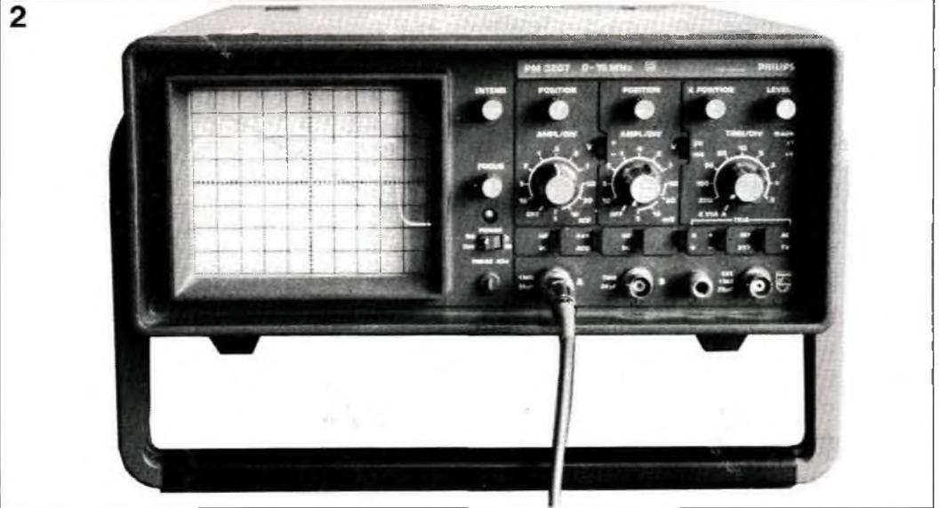
Figure 2 - Le signal rectangulaire visualisé par cet oscilloscope n'est pas ce qu'il devrait être: il présente des flancs arrondis.
