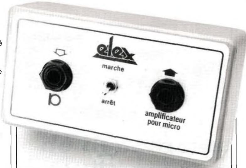
Figure 5. Les ronflements ne sont supprimés que si la platine est logée dans un boîtier métallique formant blindage. La photo montre le prototype.
